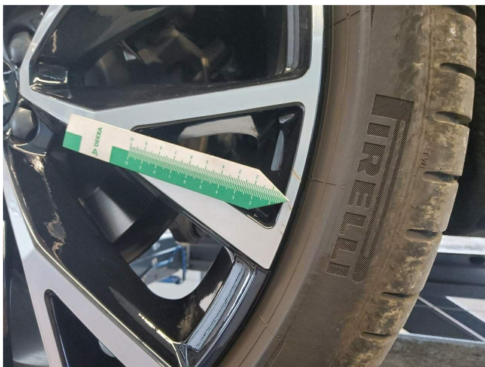
Bild 18 : Felge hinten rechts verschrammt
