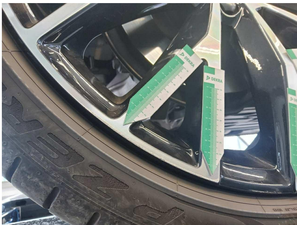
Bild 20 : Felge hinten rechts verschrammt
