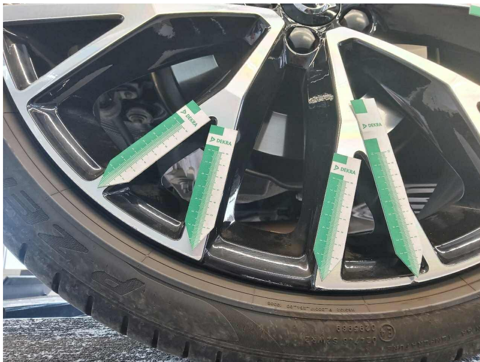
Bild 19 : Felge hinten rechts verschrammt
