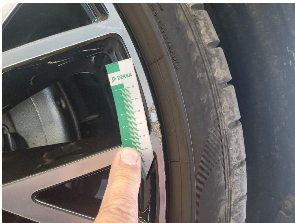
Bild 22 : Felge vorne rechts verschrammt
