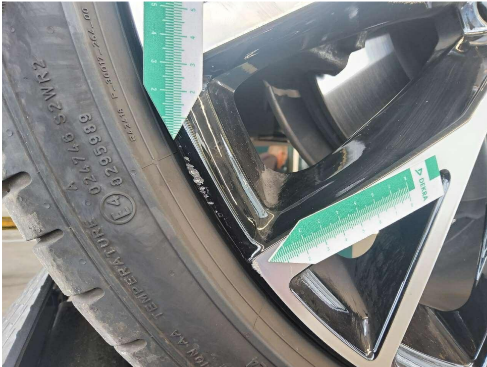
Bild 15 : Felge vorne links leicht verschrammt
