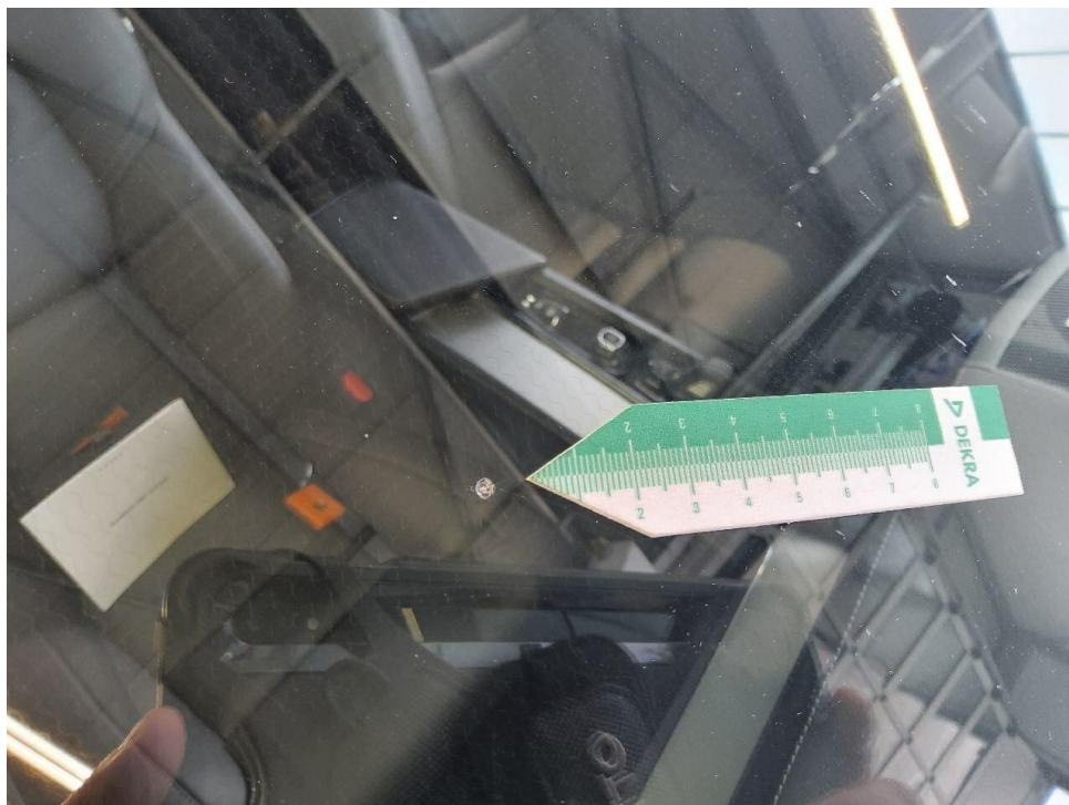
Bild 14 : Frontscheibe Steinschlag ( beheizt )
