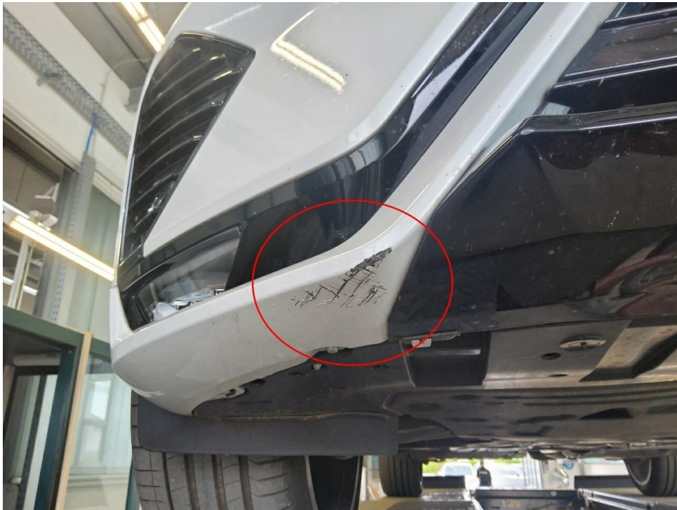
Bild 23 : Stoßfänger vorne rechts unten zerkratzt
