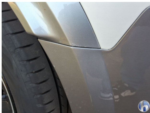
2. Seitenwand - Hinten - Links Kratzer - Smart Repair
