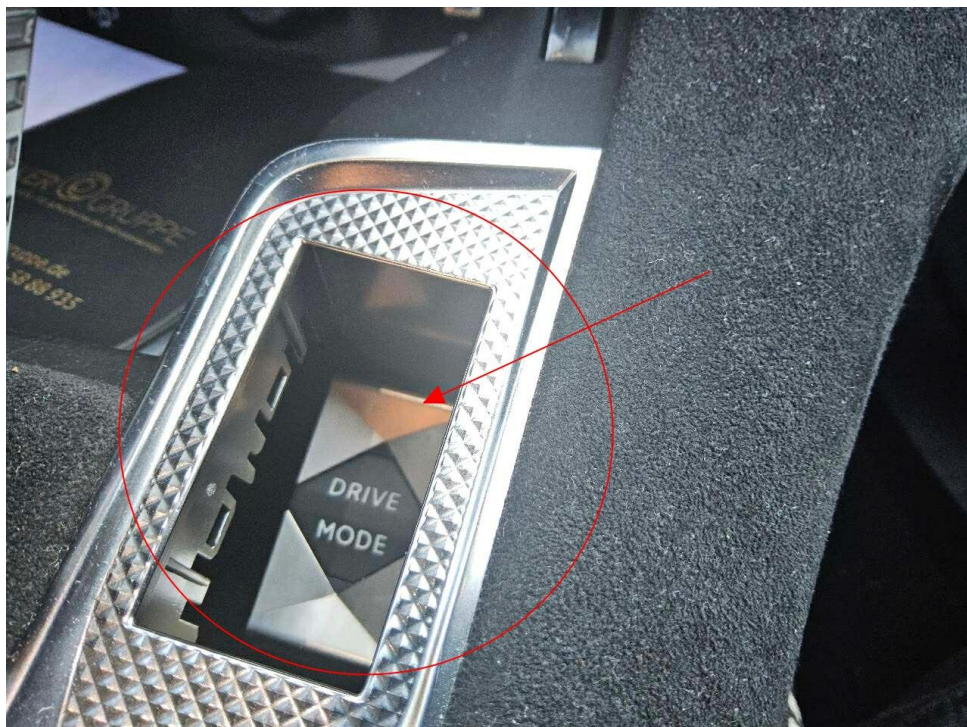
Bild 10 : Knopf Fahrmodus defekt
