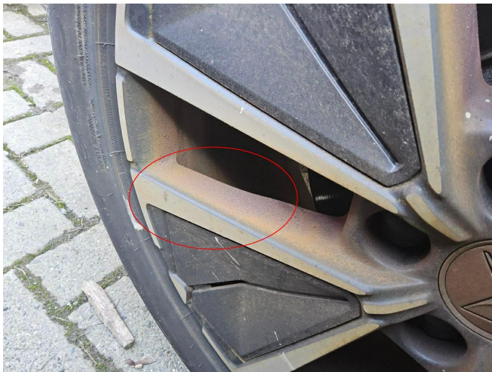
Bild 13 : Alufelge hinten rechts, Bremsstaub eingebrannt
