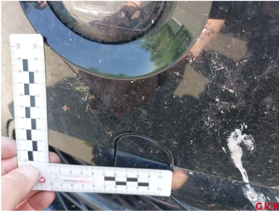
Bild 23. Stoßfänger vorne, Verkleidung -lackiert-, Lackierung verätzt, lackieren
