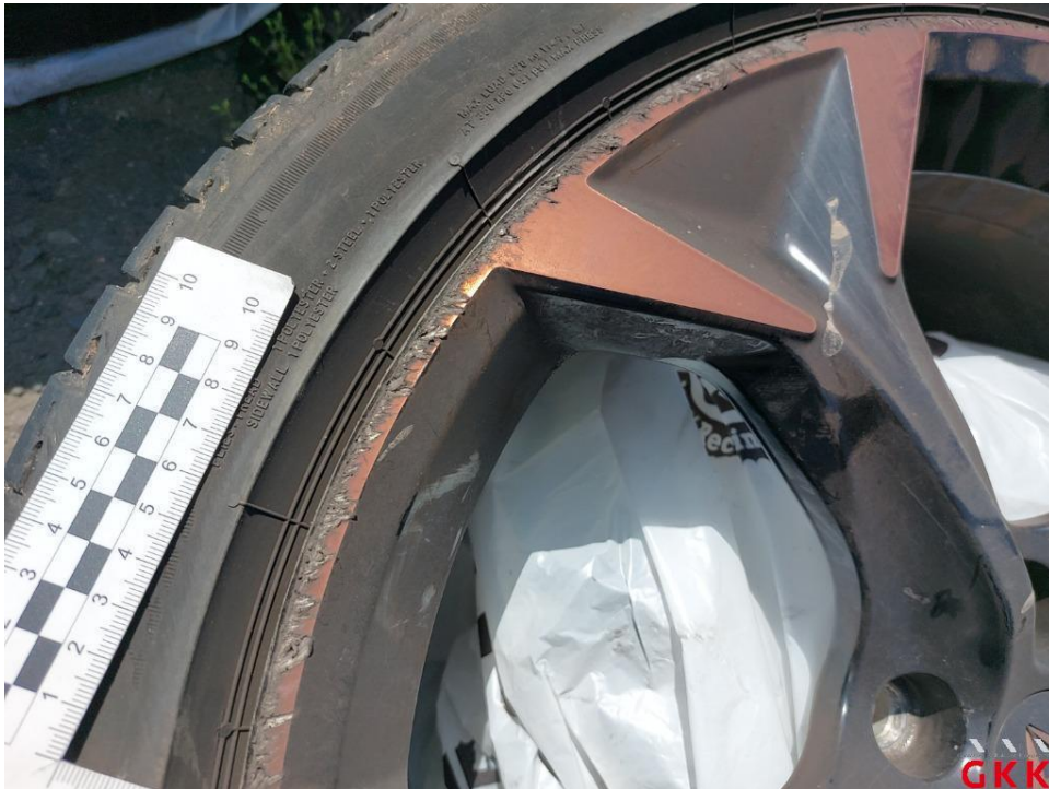
Bild 41. LM-Rad, 1 x beiliegend, Materialabtrag, ersetzen
