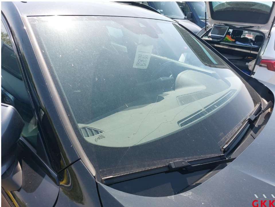
Bild 30. Frontscheibe, gerissen, ersetzen
