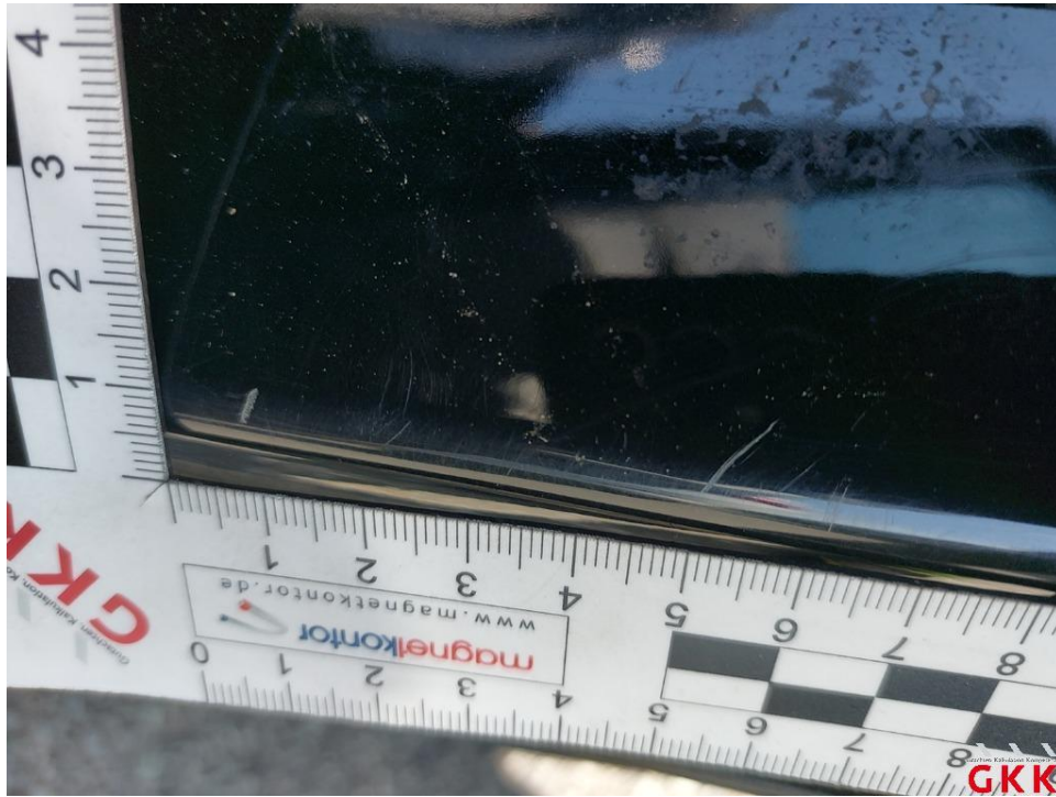
Bild 35. Tür hinten links, Einstieg, verkratzt, lackieren
