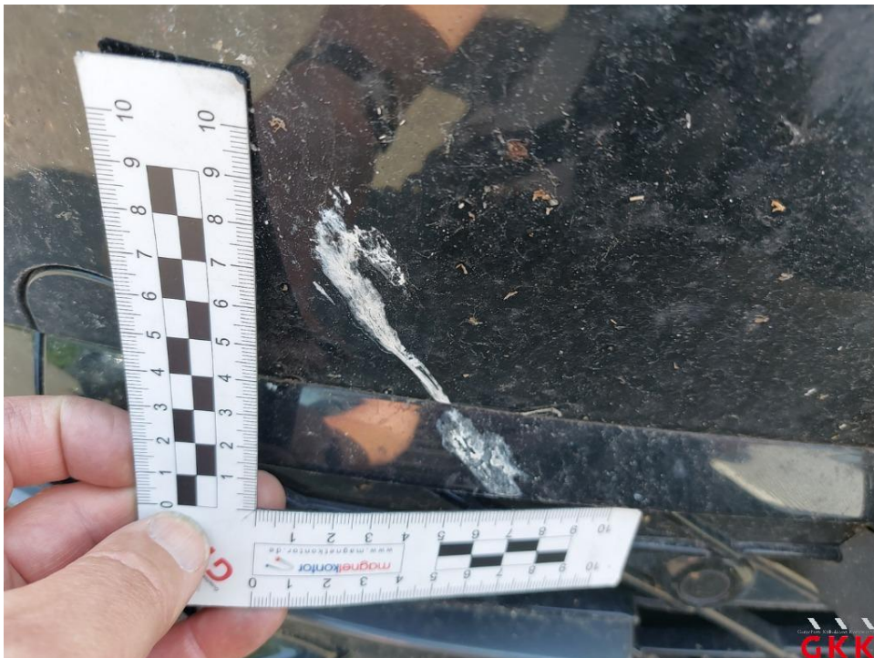
Bild 22. Stoßfänger vorne, Verkleidung -lackiert-, Lackierung verätzt, lackieren
