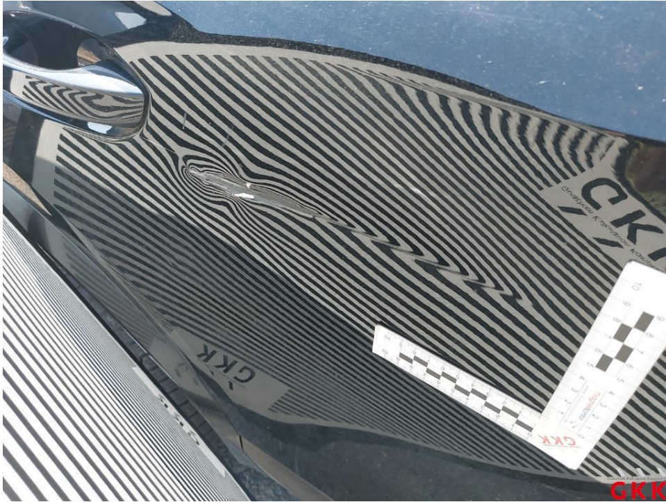
Bild 27. Tür hinten rechts, beschädigt, ersetzen
