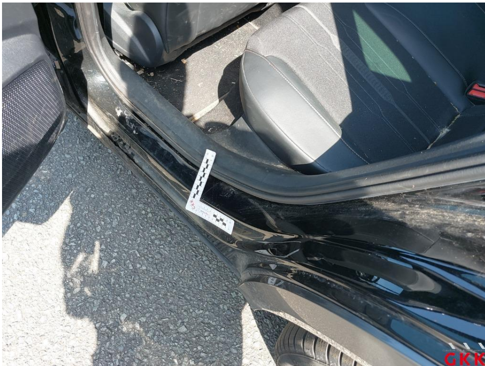
Bild 34. Tür hinten links, Einstieg, verkratzt, lackieren
