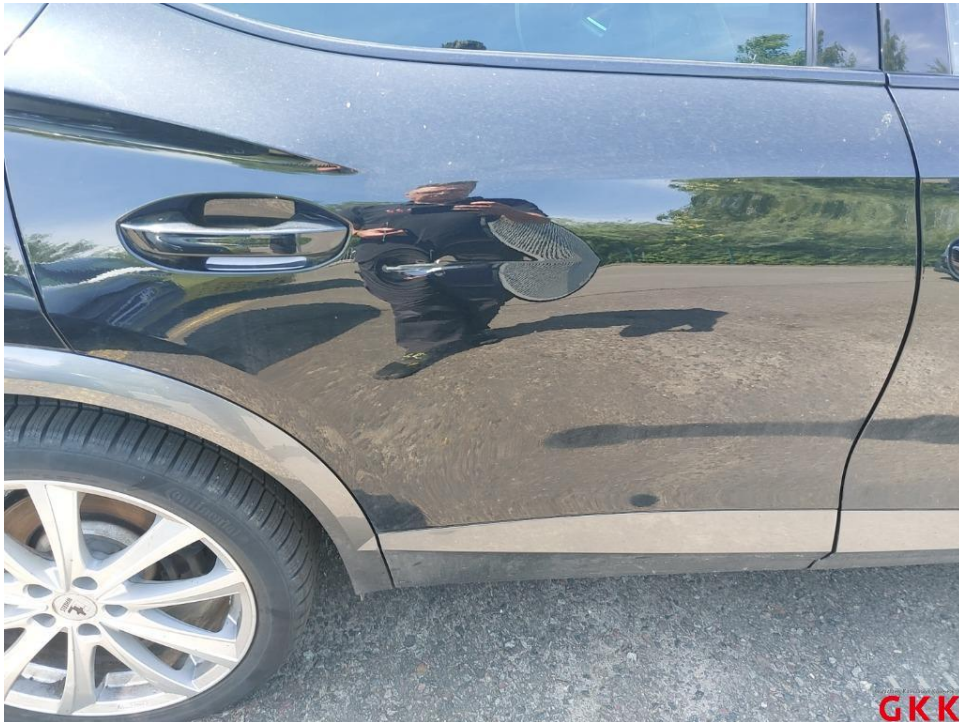
Bild 28. Tür hinten rechts, beschädigt, ersetzen
