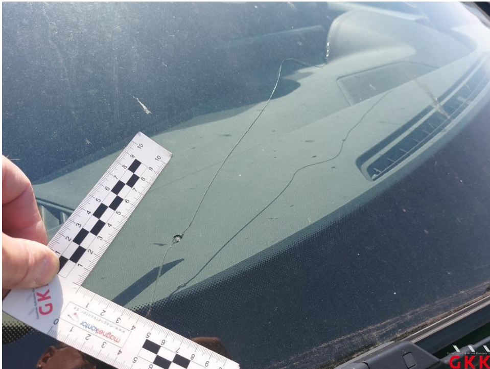
Bild 29. Frontscheibe, gerissen, ersetzen
