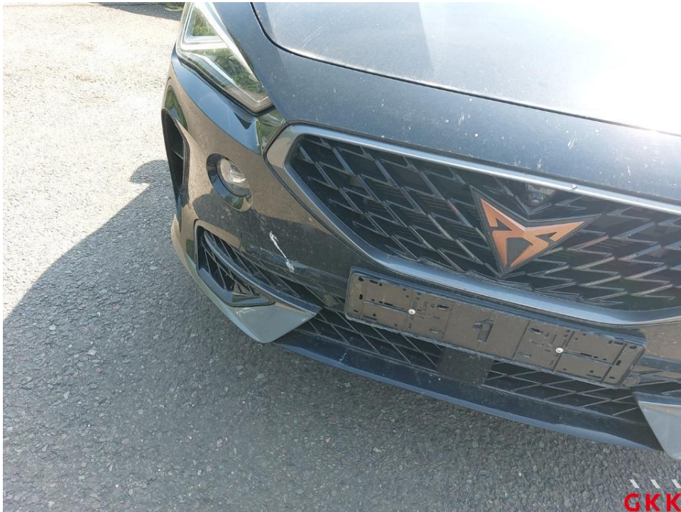
Bild 21. Stoßfänger vorne, Verkleidung -lackiert-, Lackierung verätzt, lackieren
