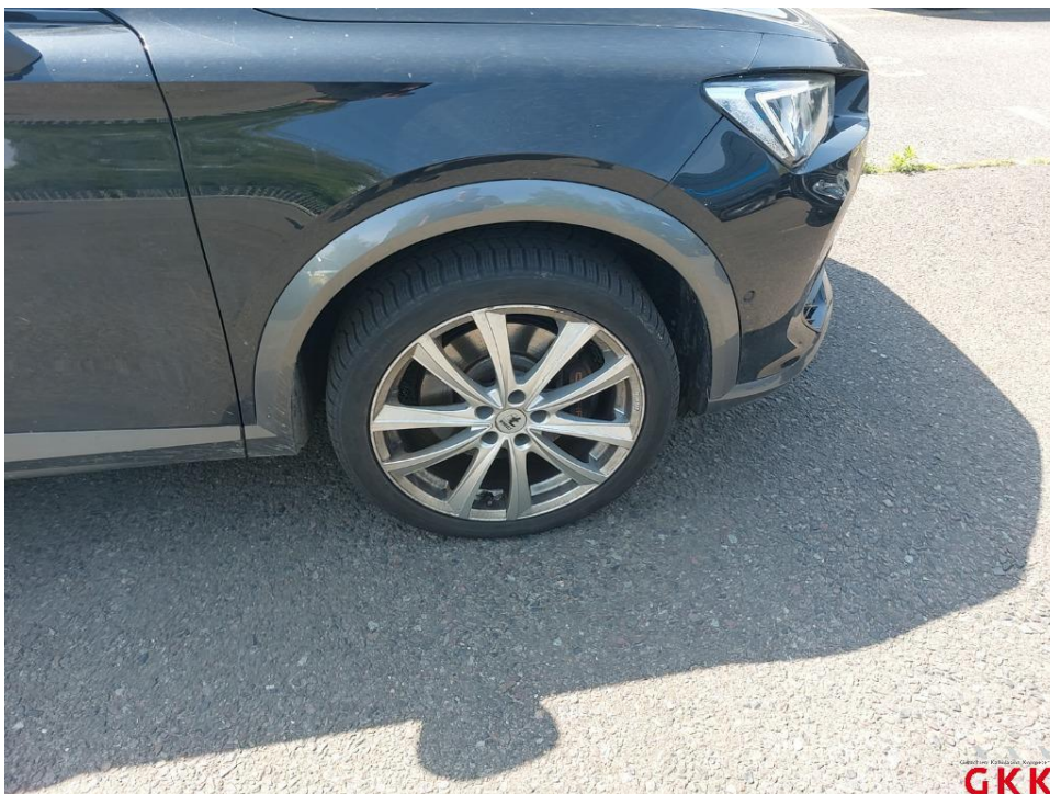
Bild 38. LM-Rad, vorne rechts, Materialabtrag, ersetzen
