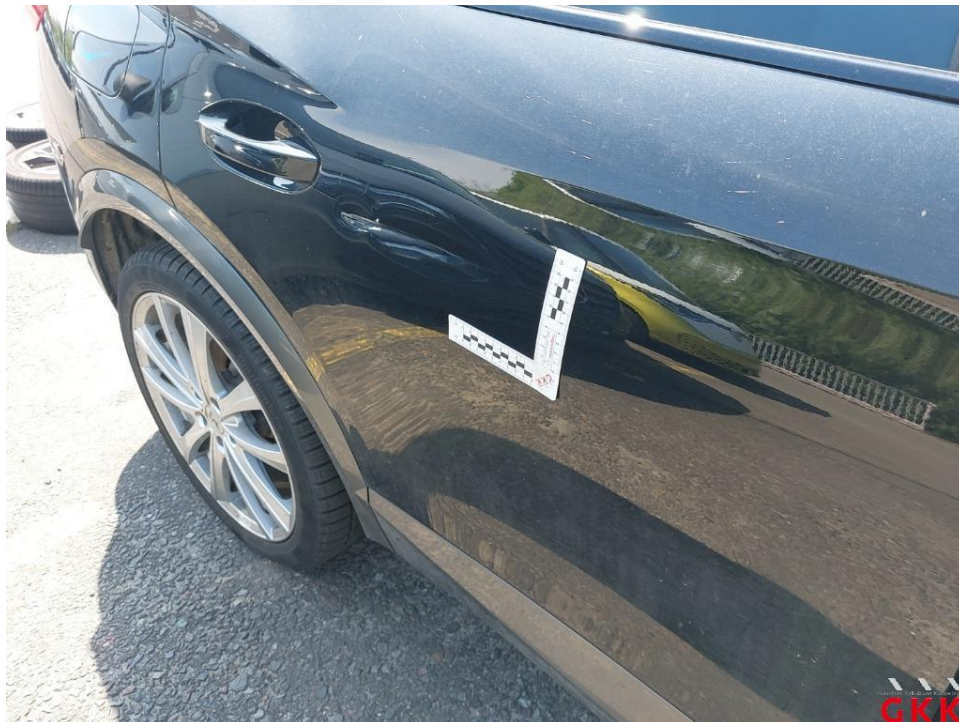
Bild 26. Tür hinten rechts, beschädigt, ersetzen
