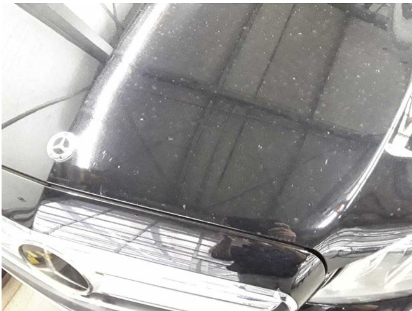
Beschädigung #6: Motorhaube: Motorhaube - Delle / Lackschaden - Smart Repair
