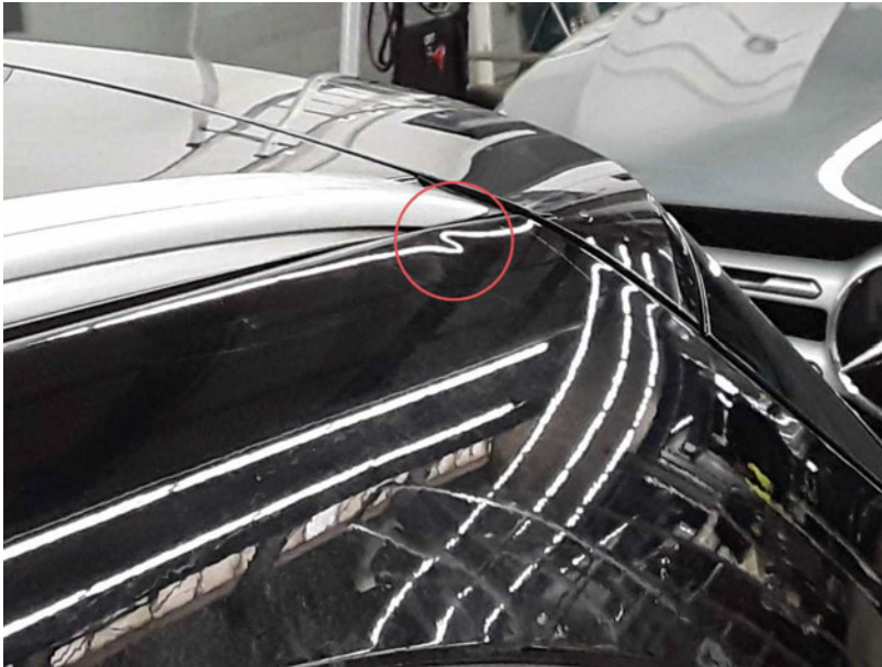
Beschädigung #5: Seitenwand links: Seitenwand - Delle(n) - Smart Repair
