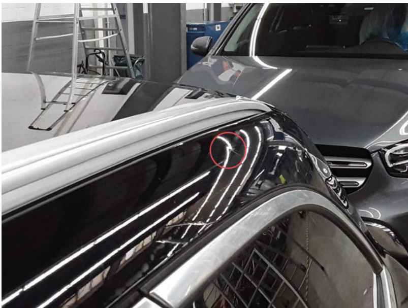
Beschädigung #5: Seitenwand links: Seitenwand - Delle(n) - Smart Repair
