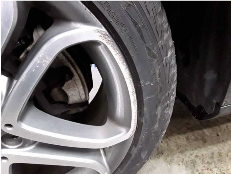
Beschädigung #3: Rad/Reifen: Leichtmetallfelge vorn links (Abweichend Auslieferung) - verkratzt / verschürft - kein Abzug
