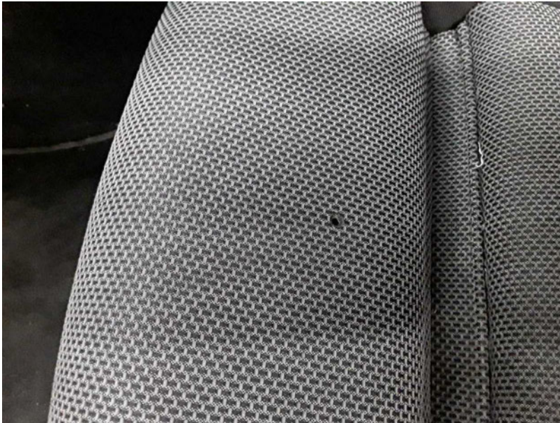
Beschädigung #9: Sitz vorn: Sitzbezug links (Verlängerung und Lehnenbezug) - Brandloch - erneuern
