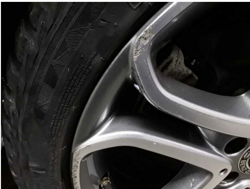
Beschädigung #2: Rad/Reifen: Leichtmetallfelge vorn rechts (Abweichend Auslieferung) - beschädigt - kein Abzug
