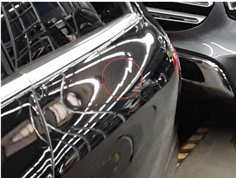
Beschädigung #5: Seitenwand links: Seitenwand - Delle(n) - Smart Repair
