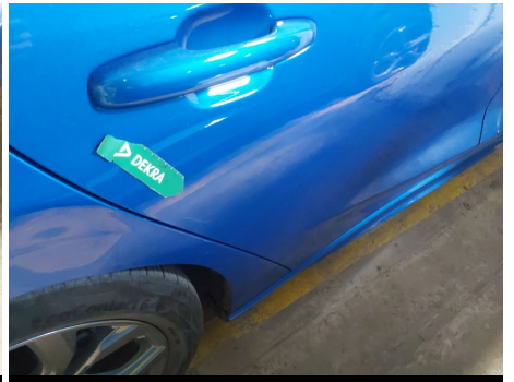
Puerta / Trasero Derecho / Abolladura
