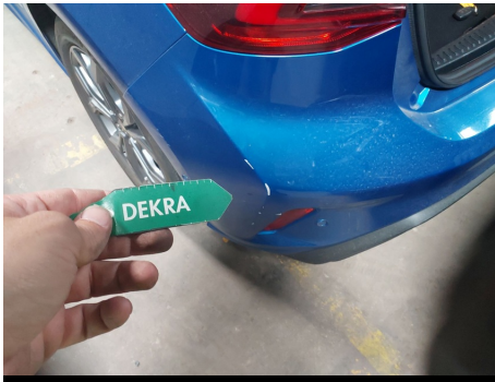
Paragolpes / Trasero / Abolladura
