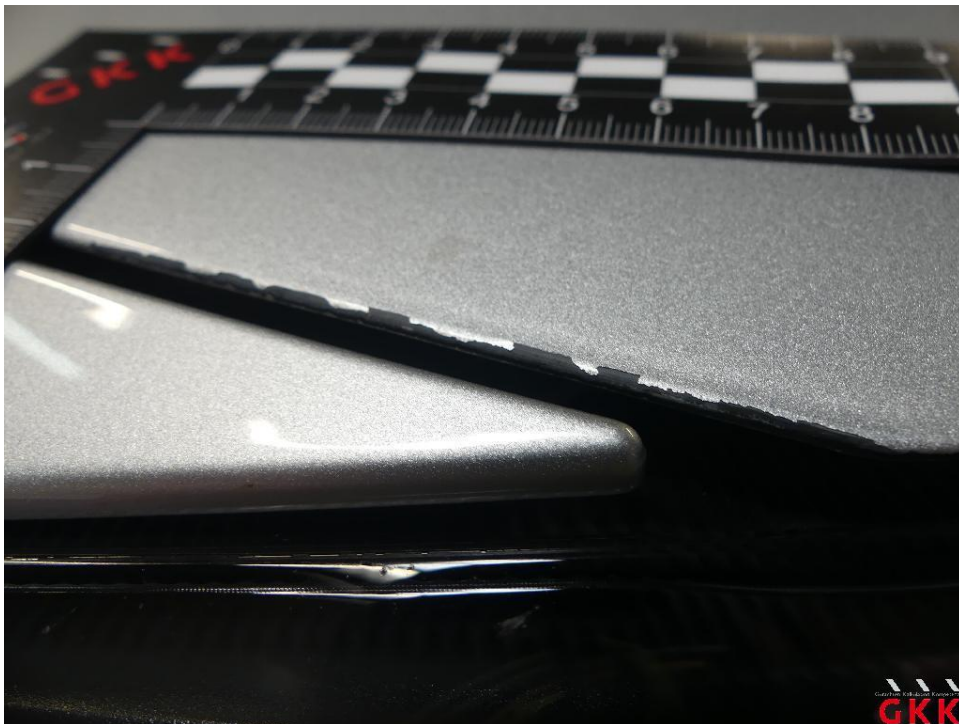
Bild 16 Motorhaube, Reparaturmangel, lackieren
