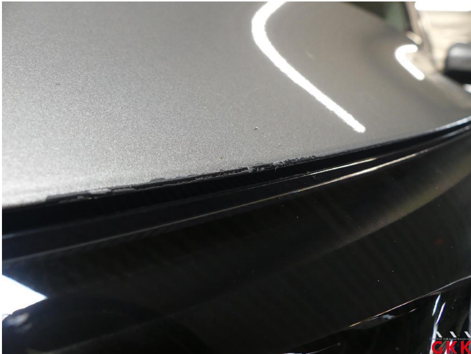
Bild 17 Motorhaube, Reparaturmangel, lackieren
