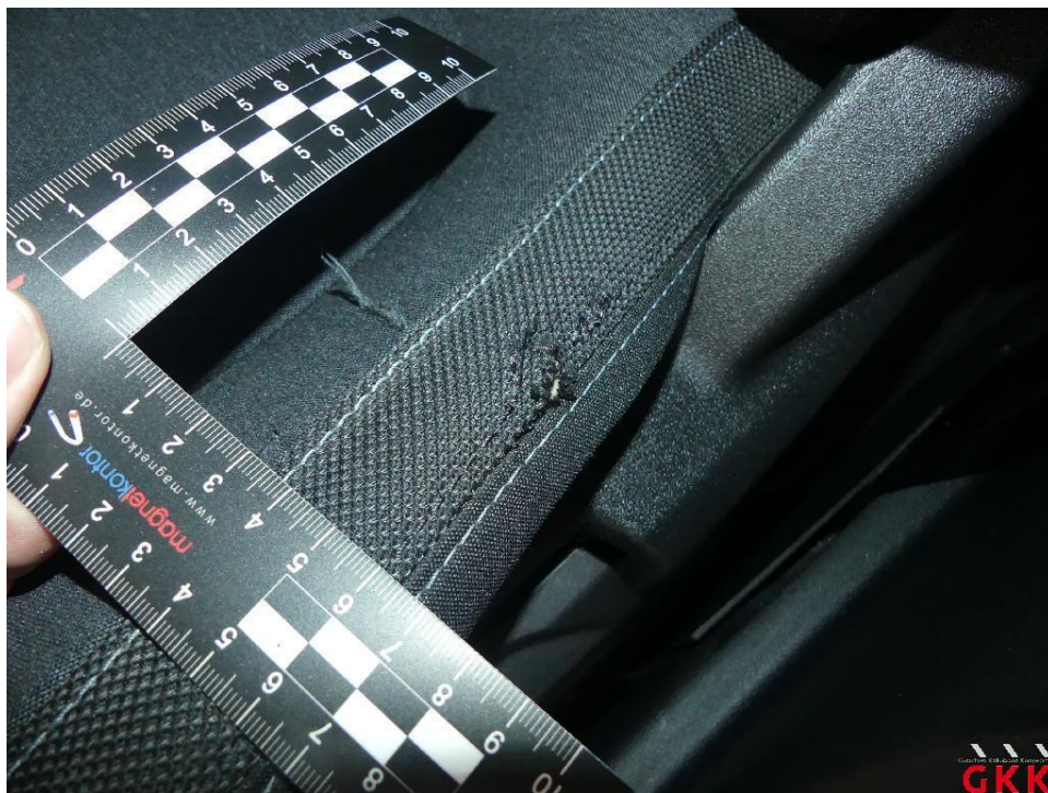
Bild 22 Sitz vorne links, Bezug Sitzkissen -Stoff-, gerissen, ersetzen
