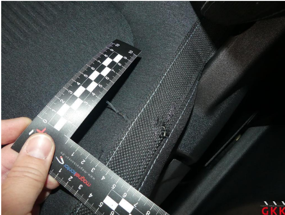
Bild 23 Sitz vorne links, Bezug Sitzkissen -Stoff-, gerissen, ersetzen
