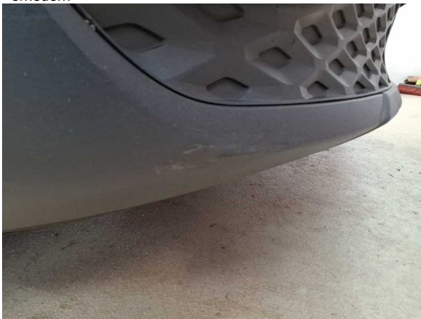
Beschädigung #8: Stossfänger vorn: Spoiler - verkratzt / versch... - erneuern
