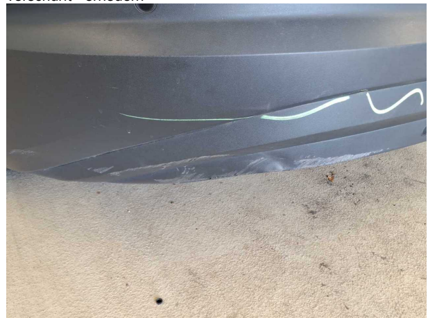
Beschädigung #9: Stossfänger hinten: Spoiler - beschädigt - erneuern
