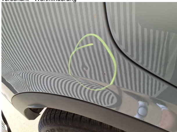
Beschädigung #5: Seitenwand rechts: Seitenwand - Delle / Lackschaden - sanft instandsetzen
