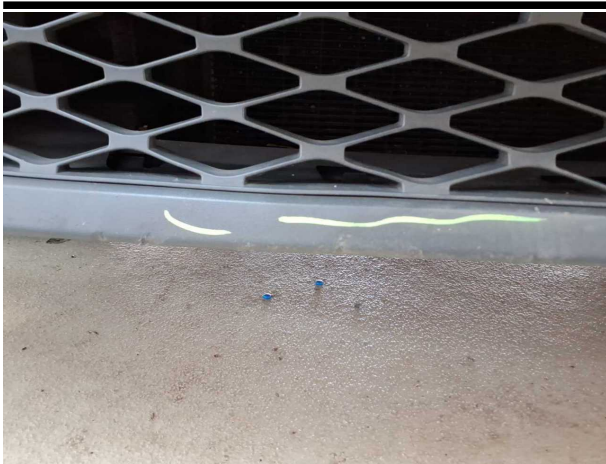
Beschädigung #8: Stossfänger vorn: Spoiler - verkratzt / versch... - erneuern
