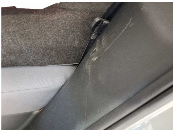
Beschädigung #4: Seitenwand links: Innenverkleidung - verkratzt / verschürft - Wertminderung
