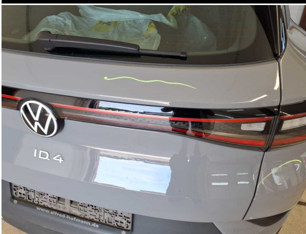
Beschädigung #11: Heckklappe/-tür: Heckklappe - Delle / Lackschaden - instandsetzen und lackieren
