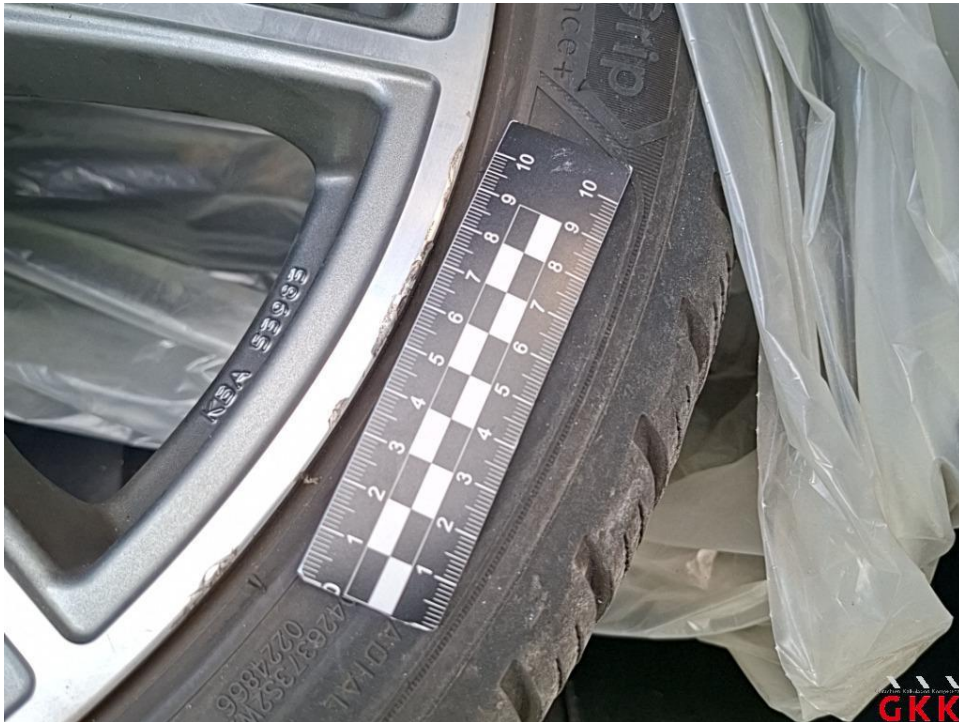
Bild 21. LM-Rad, 1 x beiliegend, Materialabtrag, ersetzen
