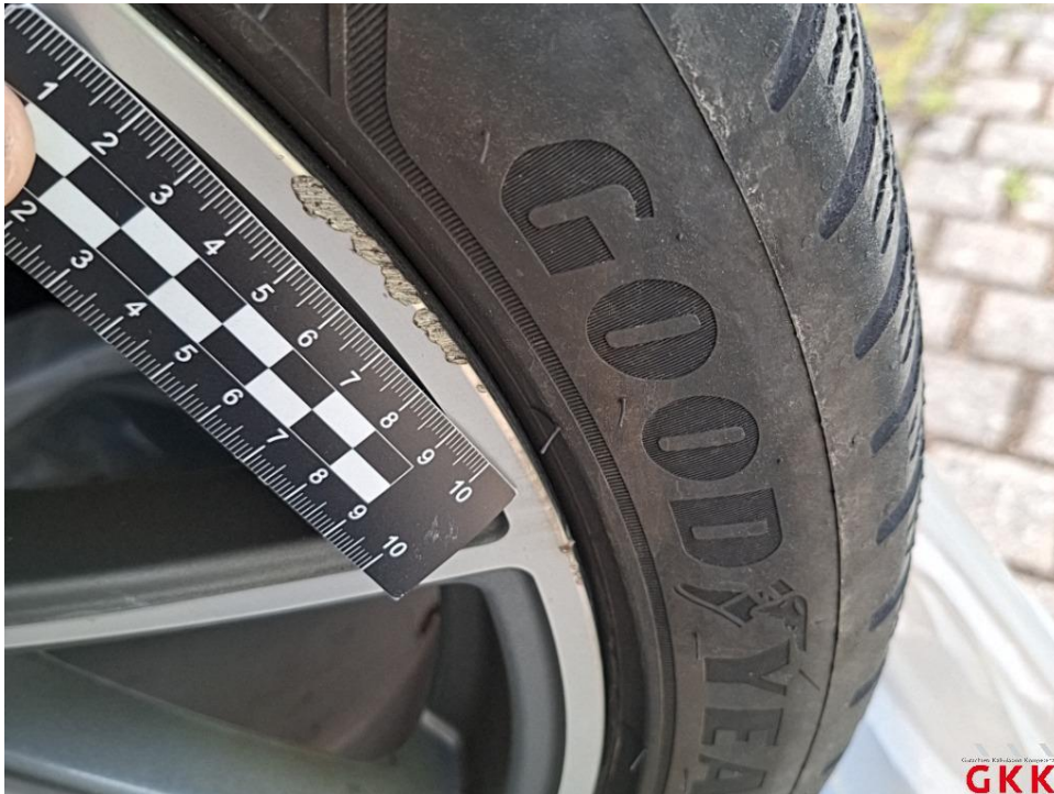
Bild 13. LM-Rad, 1 x beiliegend, Materialabtrag, ersetzen
