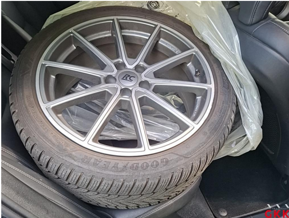
Bild 20. LM-Rad, 1 x beiliegend, Materialabtrag, ersetzen
