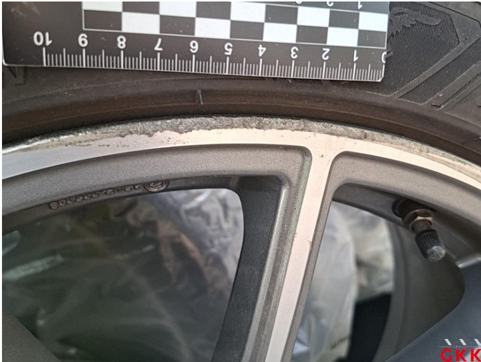
Bild 19. LM-Rad, 1 x beiliegend, Materialabtrag, ersetzen
