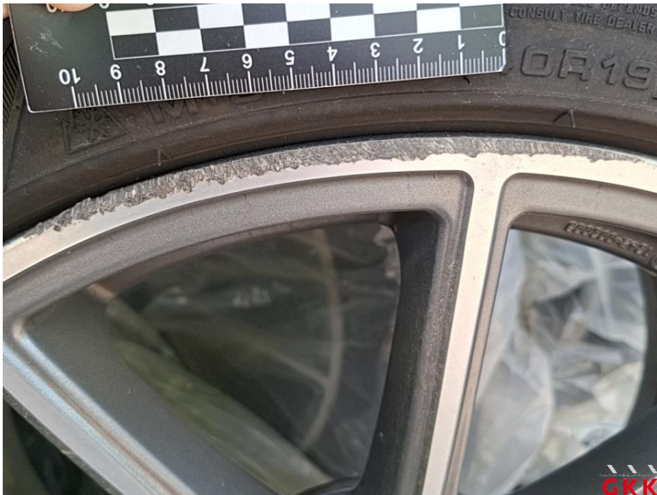
Bild 18. LM-Rad, 1 x beiliegend, Materialabtrag, ersetzen
