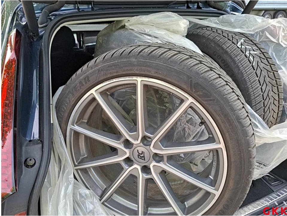
Bild 17. LM-Rad, 1 x beiliegend, Materialabtrag, ersetzen
