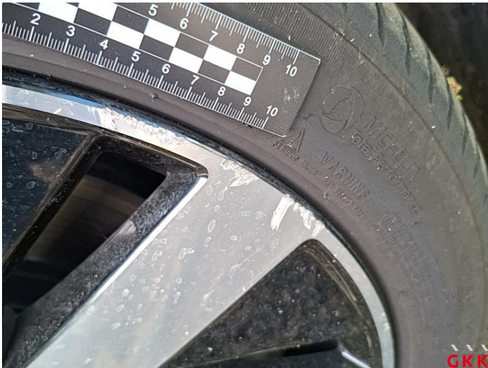
Bild 30. LM-Rad, vorne links, Materialabtrag, ersetzen
