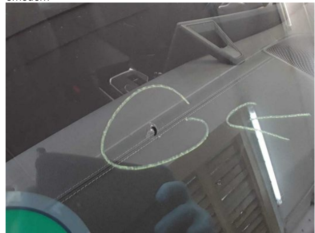
Beschädigung #9: Verglasung: Frontscheibe (Rissbildung) - Steinschlag - erneuern
