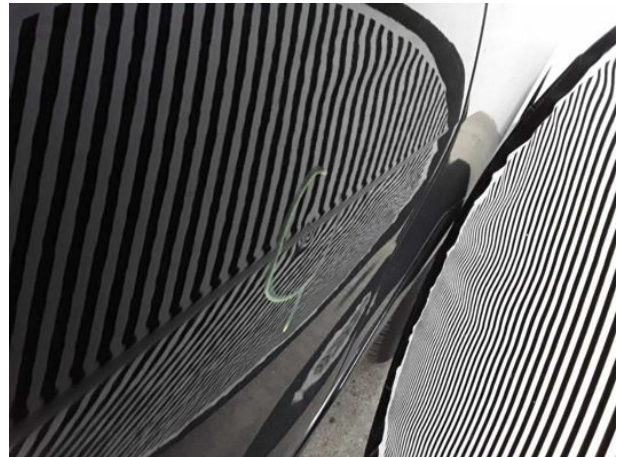
Beschädigung #11: Tür vorn rechts: Tür - Delle / Lackschaden - instandsetzen und lackieren
