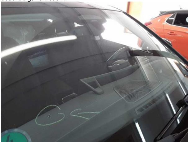
Beschädigung #9: Verglasung: Frontscheibe (Rissbildung) - Steinschlag - erneuern
