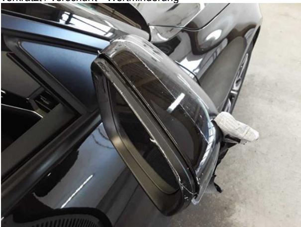
Beschädigung #7: Außenspiegel rechts: Abdeckkappe - beschädigt - erneuern
