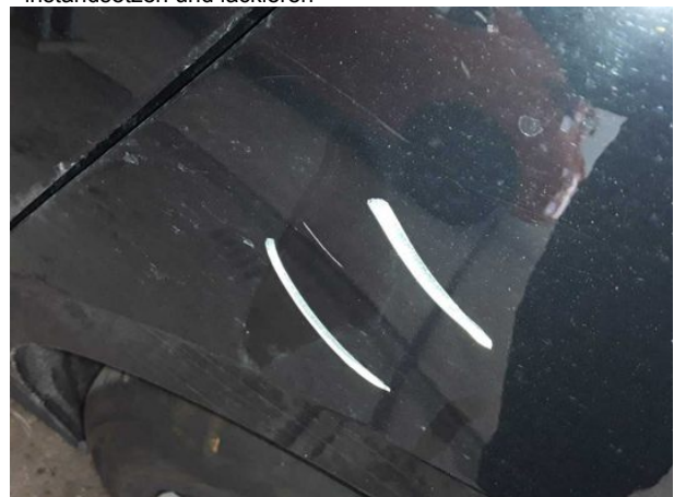
Beschädigung #12: Seitenwand links: Seitenwand - verkratzt / verschürft - instandsetzen und lackieren
