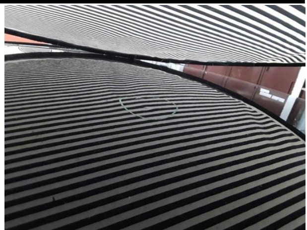
Beschädigung #5: Fahrzeugdach: Dach - Delle(n) - sanft instandsetzen
