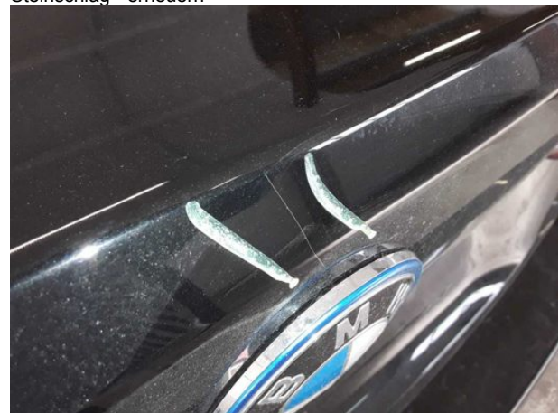
Beschädigung #10: Heckklappe/-tür: Heckklappe - verkratzt / verschürft - instandsetzen und lackieren
