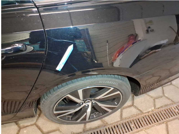
Beschädigung #1: Seitenwand links: Seitenwand - Kratzer - auslege... polieren
