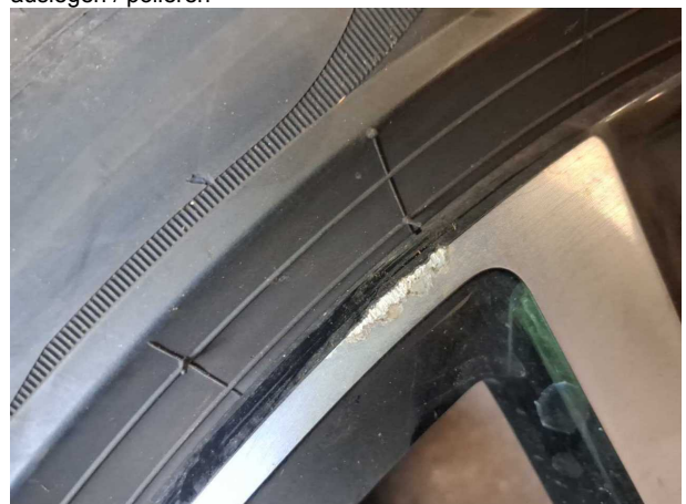
Beschädigung #2: 2.Radsatz: 1 Leichtmetallfelge (Sommer) - verkratzt / verschürft - Wertminderung
