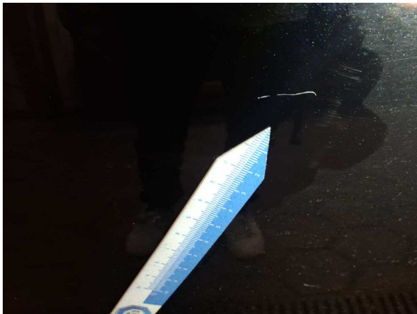
Beschädigung #5: Tür hinten links: Tür - Kratzer - lackieren
