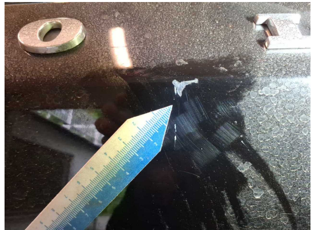
Beschädigung #6: Heckklappe/-tür: Heckklappe - Kratzer - instandsetzen und lackieren
