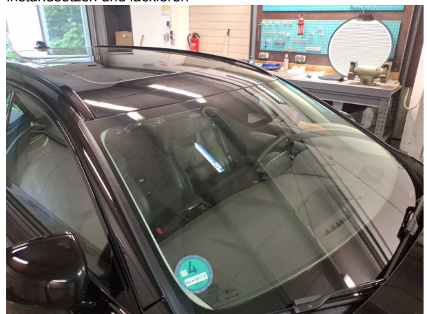
Beschädigung #7: Verglasung: Frontscheibe mit Spurhalteassistent - Steinschlag - erneuern
