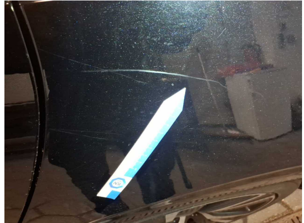
Beschädigung #1: Seitenwand links: Seitenwand - Kratzer - auslegen / polieren
