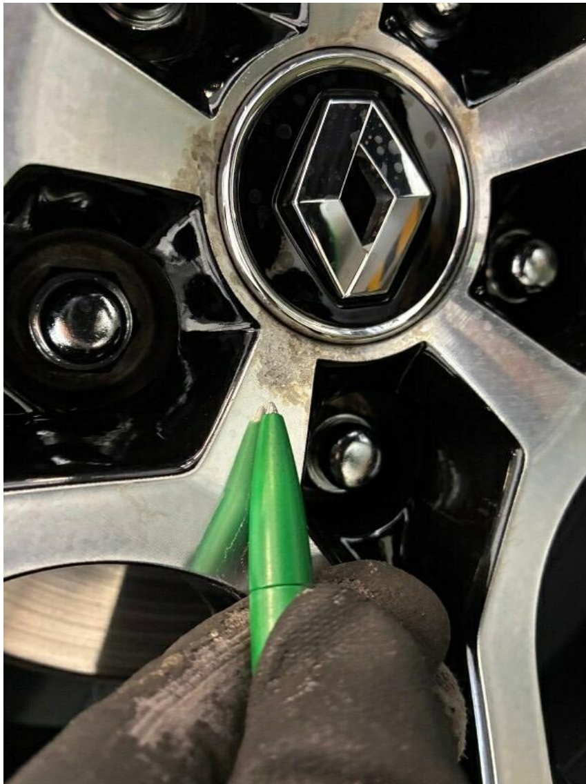
Bild 19 : Felge hinten links glanzgedreht Korrosion
