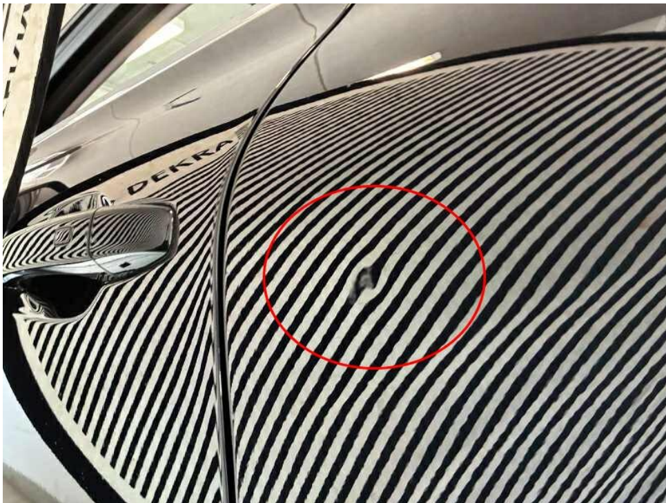
Bild 14 : Türe hinten links Kratzer + Delle
