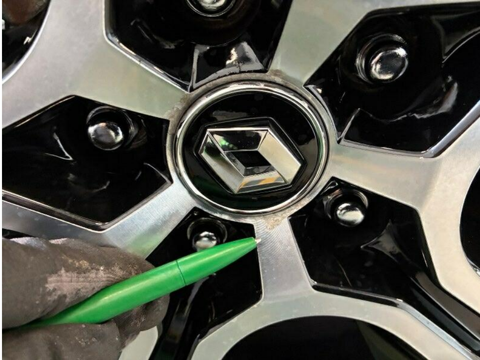
Bild 20 : Felge vorne links glanzgedreht Korrosion
