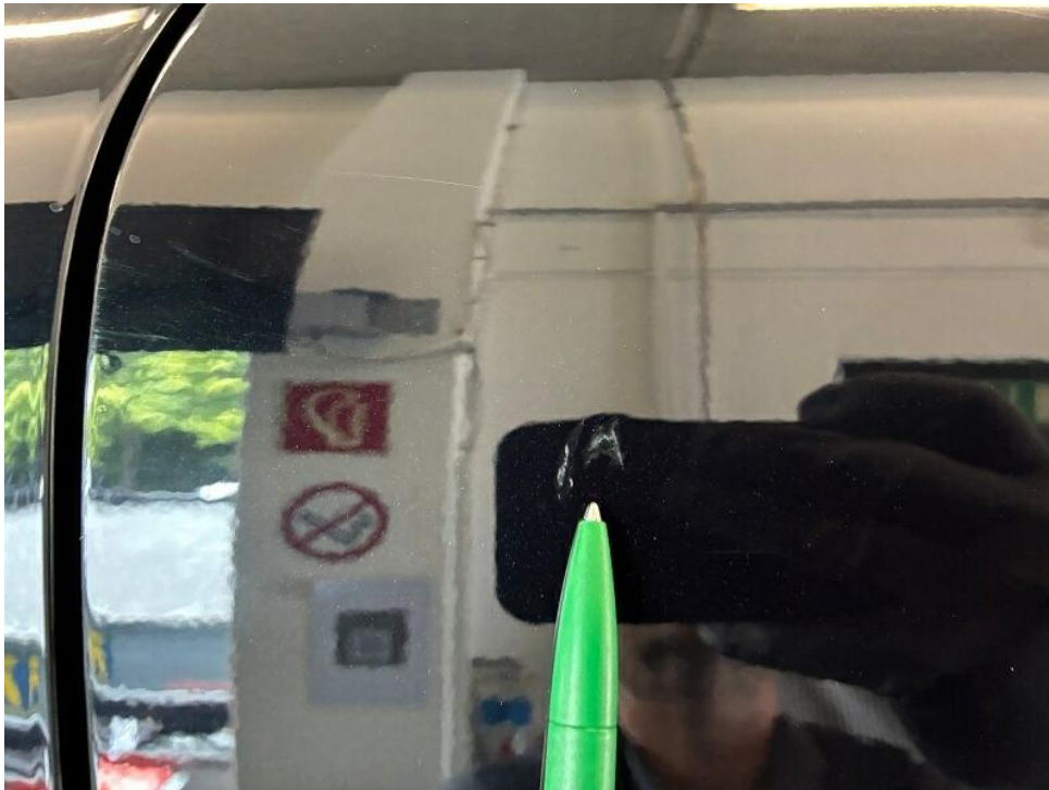
Bild 15 : Türe hinten links Kratzer + Delle
