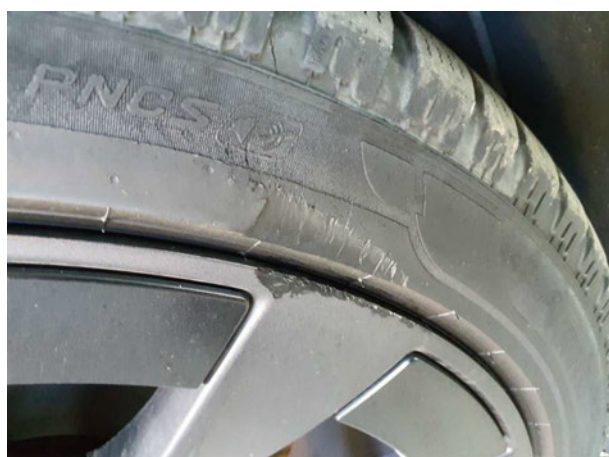
Beschädigung #2: Rad/Reifen: Reifen hinten rechts - beschädigt
