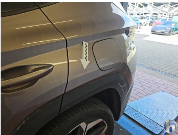
4. Seitenwand - Hinten - Links Beschädigt - Instandsetzen und Lackieren
