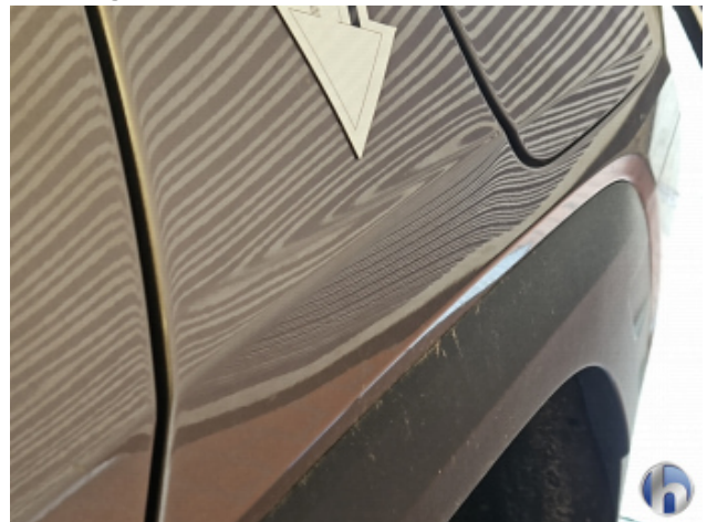
4. Seitenwand - Hinten - Links Beschädigt - Instandsetzen und Lackieren
