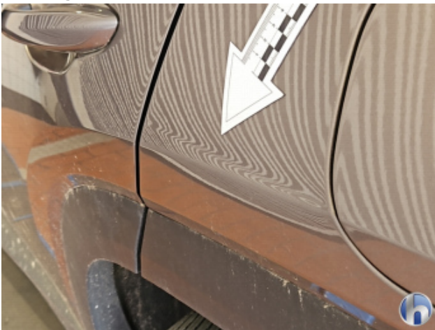
4. Seitenwand - Hinten - Links Beschädigt - Instandsetzen und Lackieren
