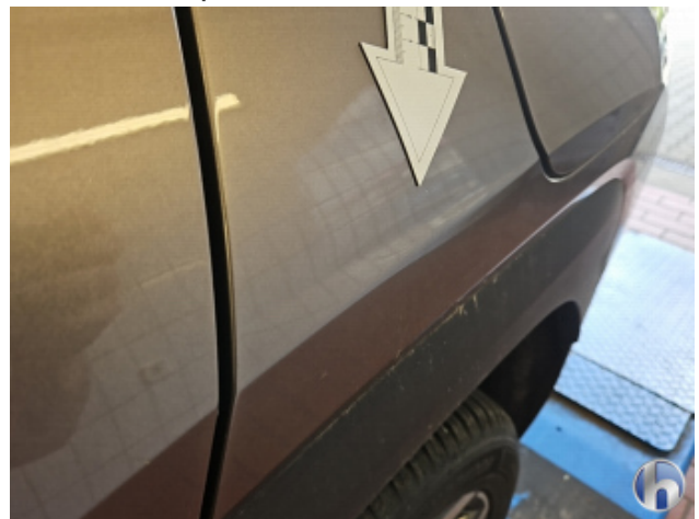
4. Seitenwand - Hinten - Links Beschädigt - Instandsetzen und Lackieren
