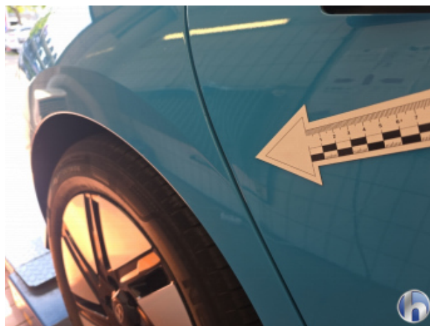
1. Tür Hinten - Rechts Beschädigt - Sanft Instandsetzen
