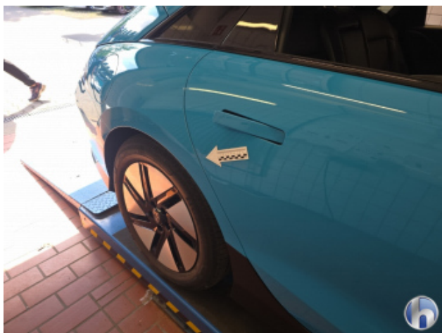
1. Tür Hinten - Rechts Beschädigt - Sanft Instandsetzen
