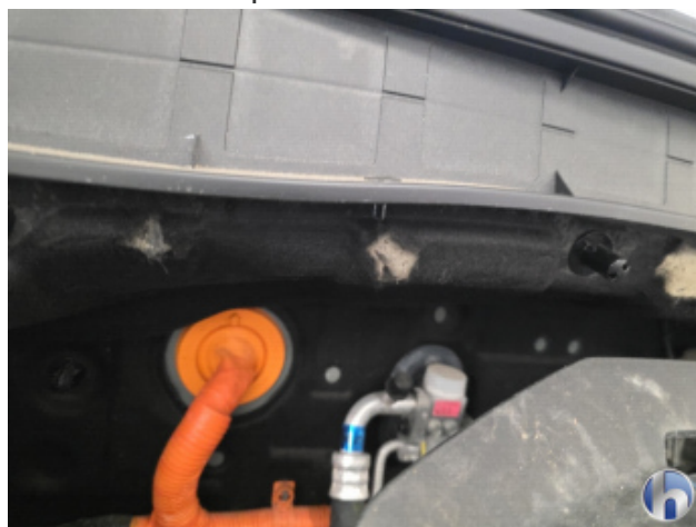
3. Motordämmmaterial Marderbiss /-schaden - Erneuern
