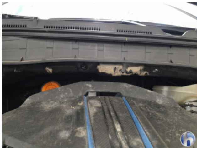
3. Motordämmmaterial Marderbiss /-schaden - Erneuern
