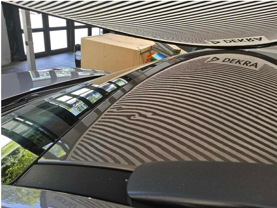
Bild 11 : Dach mehrfach eingedellt
