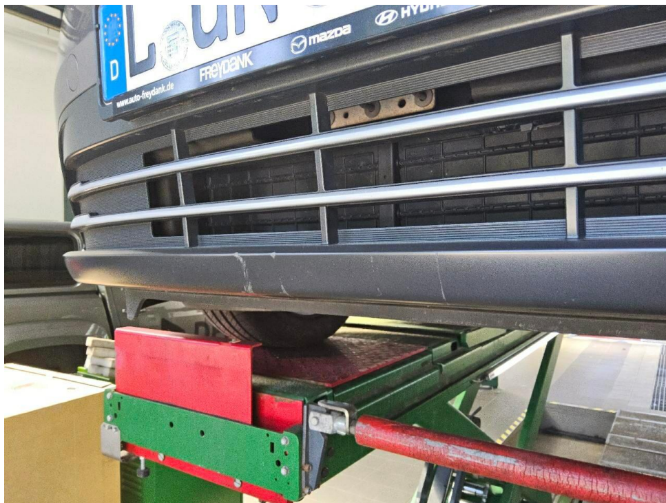
Bild 16 : Stoßfänger vorne Unterteil verschrammt
