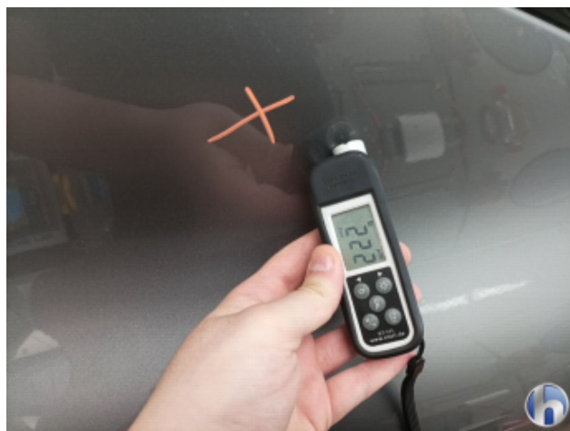
2. Seitenwand - Hinten - Links Nachlackiert - Ohne Reparatur
