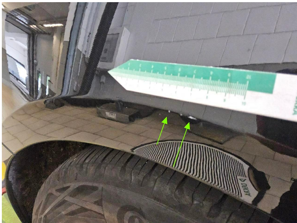
Bild 10 : Seitenteil hinten rechts Lackierung, verschrammt
