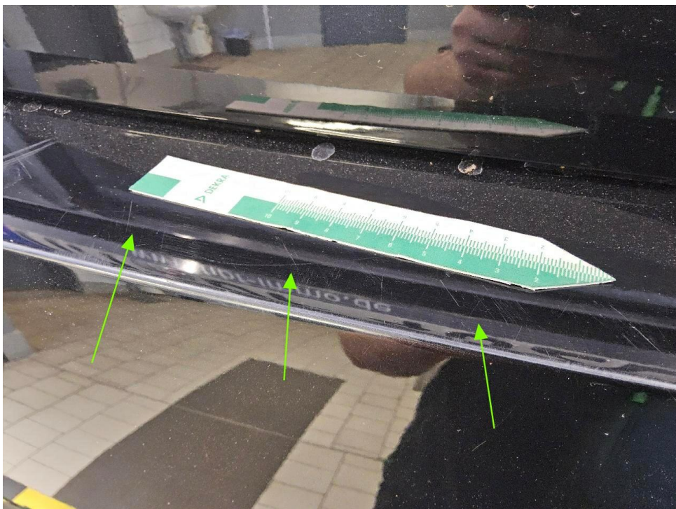
Bild 14 : Stoßfänger hinten Lackierung, verschrammt
