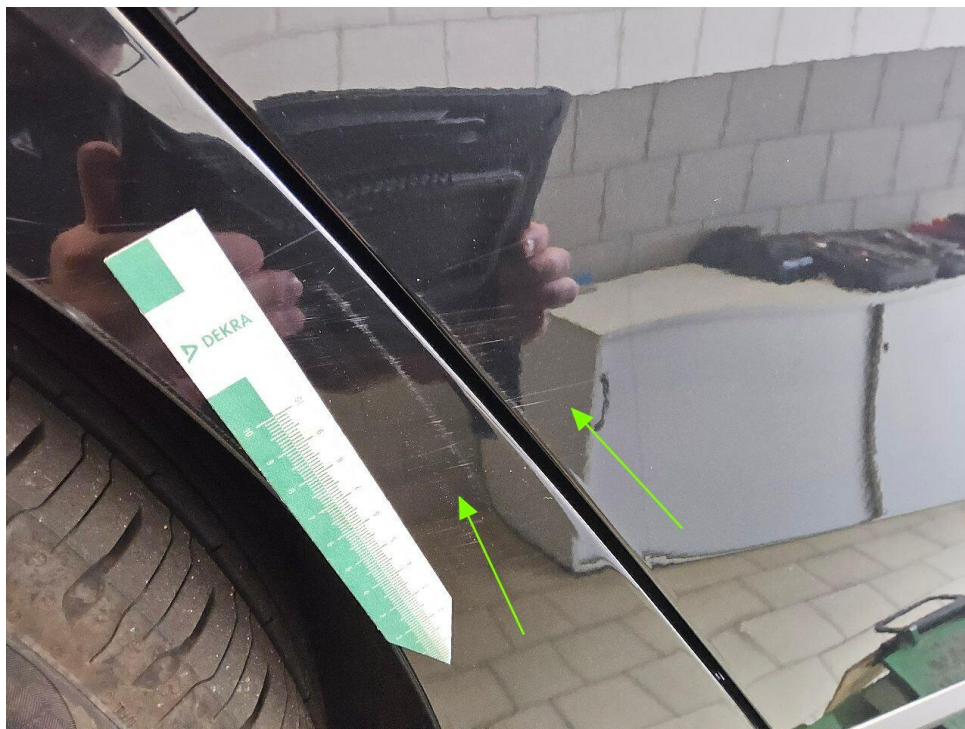
Bild 15 : Seitenteil hinten rechts und Tür Lackierung leicht verschrammt
