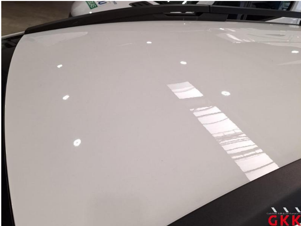
Bild 28. Dach, Lackierung verätzt, aufbereiten
