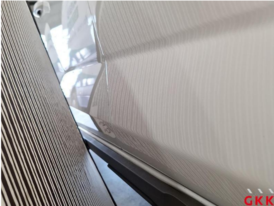
Bild 19. Tür vorne rechts, Reparaturmangel, instand setzen - lackieren
