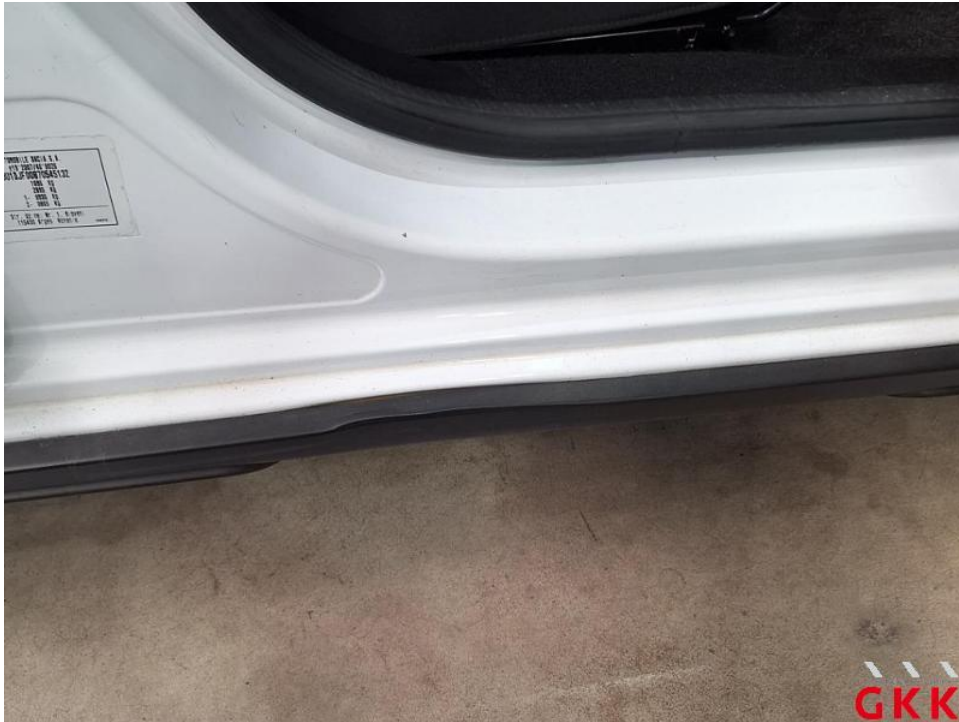
Bild 45. Schweller rechts, Abdeckung -unlackiert-, beschädigt, ersetzen
