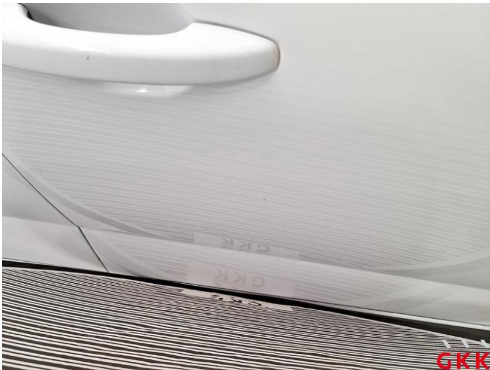
Bild 50. Tür vorne rechts, beschädigt, instand setzen - lackieren
