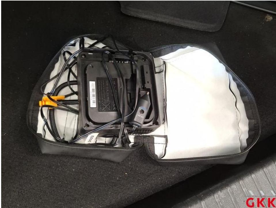
Bild 13. Reifenreparaturset, Füllflasche, fehlt, ersetzen
