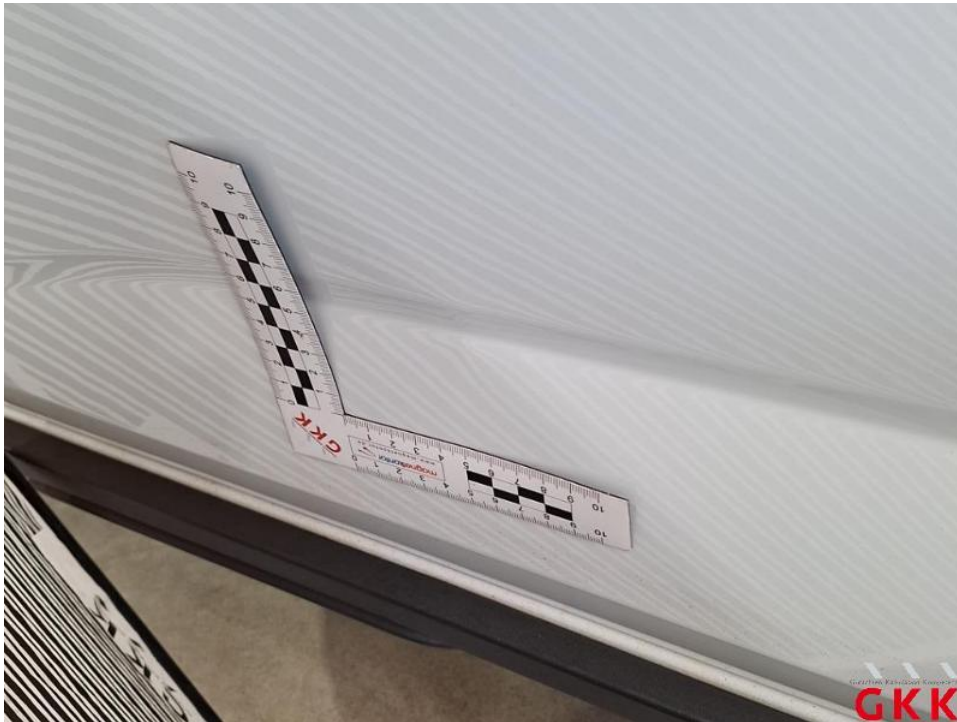
Bild 32. Tür vorne links, beschädigt, instand setzen - lackieren
