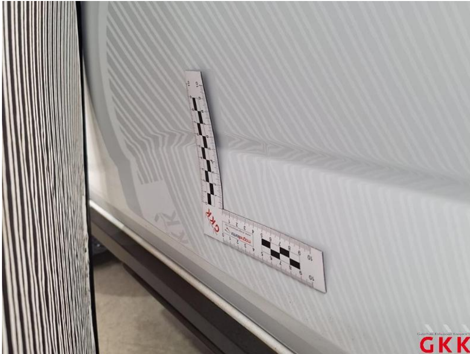
Bild 31. Tür vorne links, beschädigt, instand setzen - lackieren
