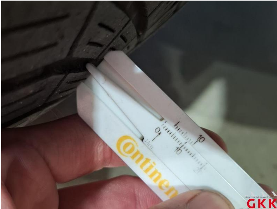
Bild 27. Reifen, vorn links und rechts, Untermaß, ersetzen
