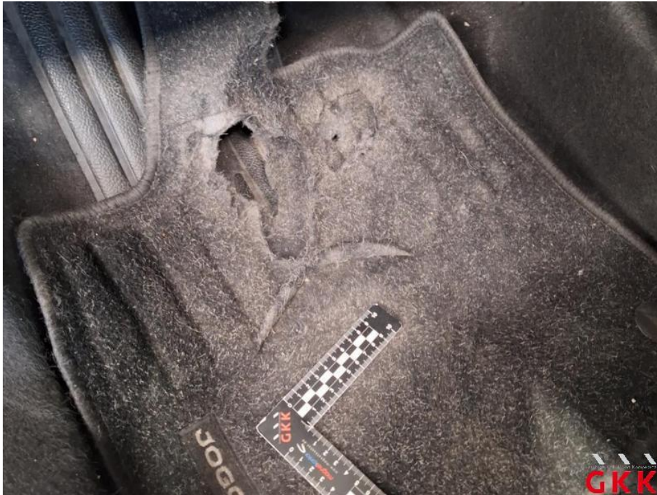
Bild 37. Fußmatte(n), vorne links, beschädigt, ersetzen
