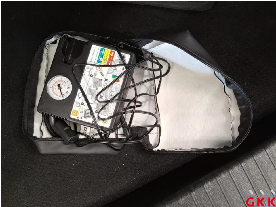
Bild 14. Reifenreparaturset, Füllflasche, fehlt, ersetzen
