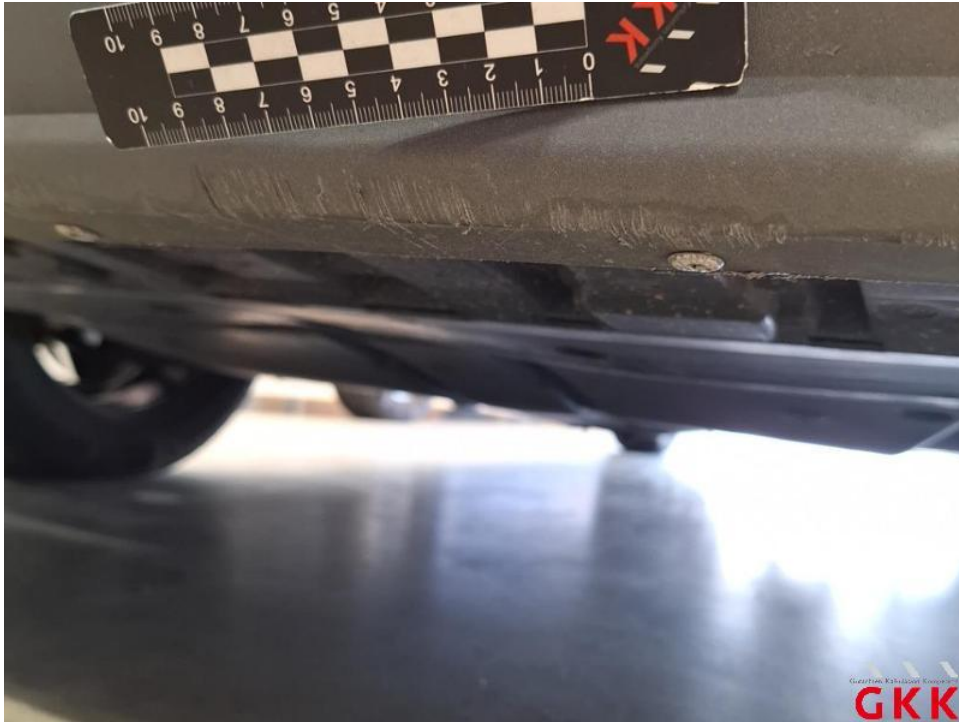
Bild 21. Stoßfänger vorne, Spoiler -unlackiert-, verkratzt, ersetzen
