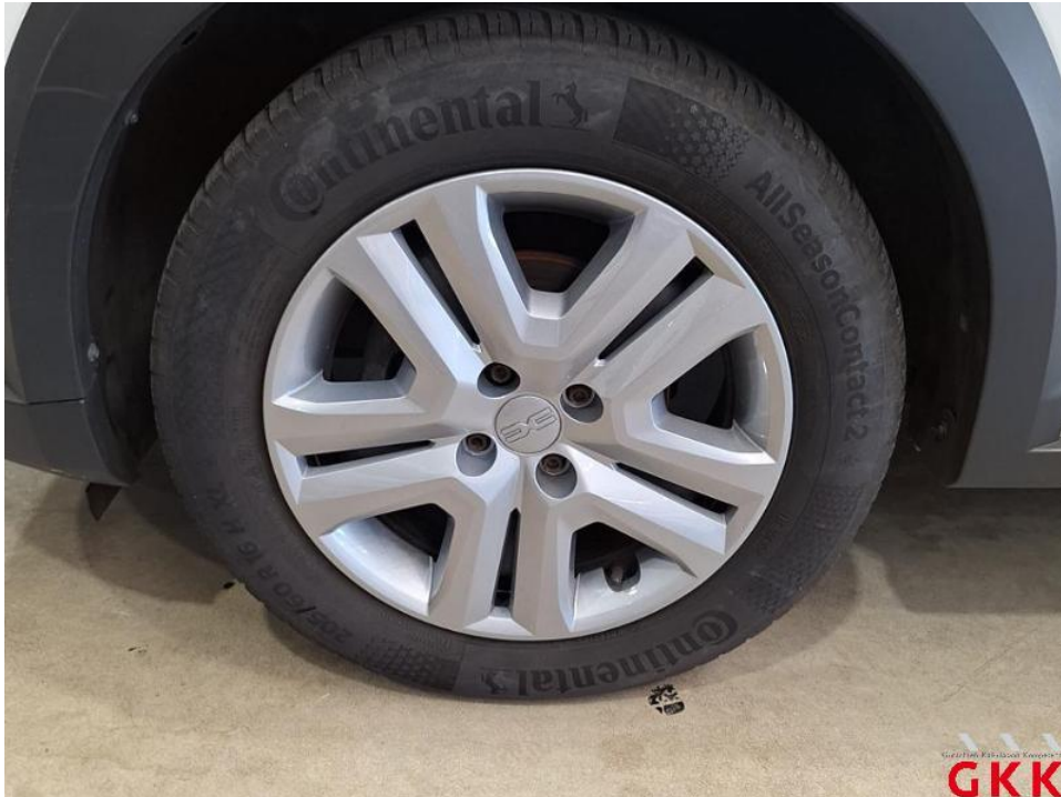
Bild 25. Reifen, vorn links und rechts, Untermaß, ersetzen
