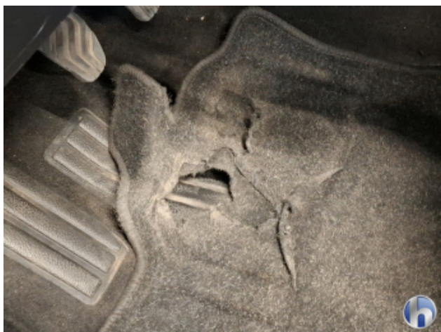
4. Fußmatten Vorn Beschädigt - Erneuern
