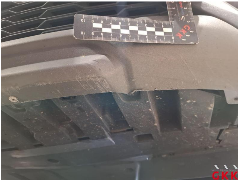
Bild 22. Stoßfänger vorne, Spoiler -unlackiert-, verkratzt, ersetzen
