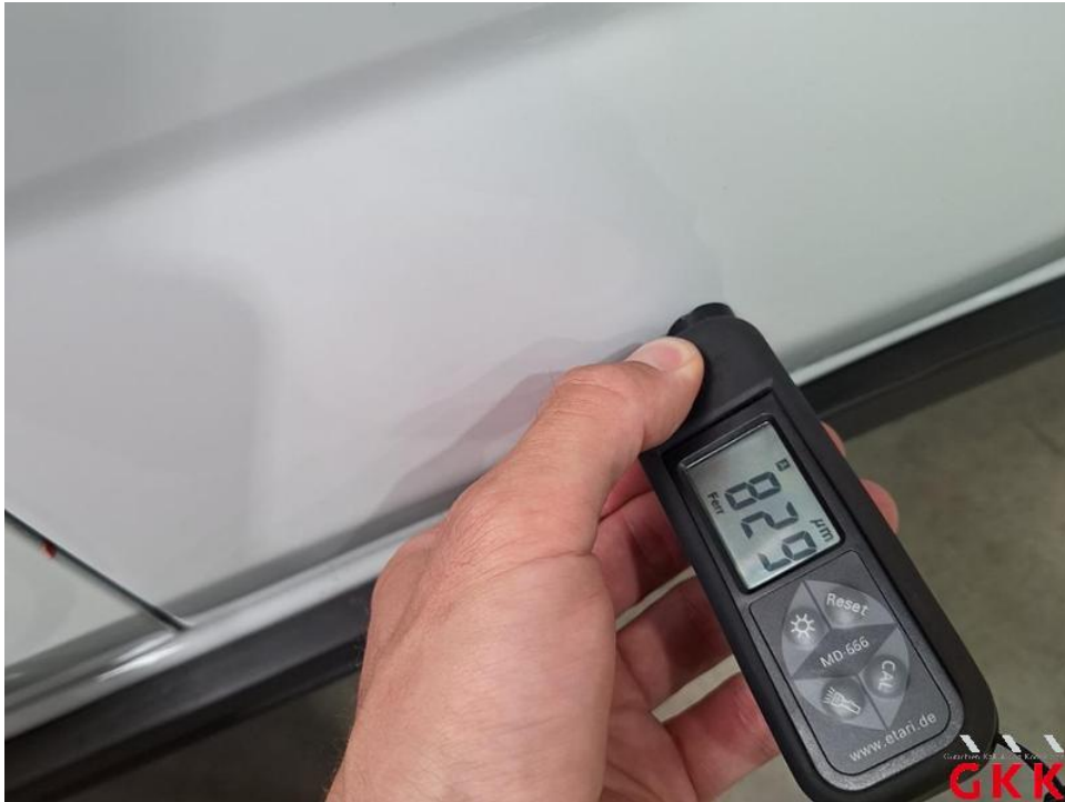
Bild 17. Tür vorne rechts, Reparaturmangel, instand setzen - lackieren
