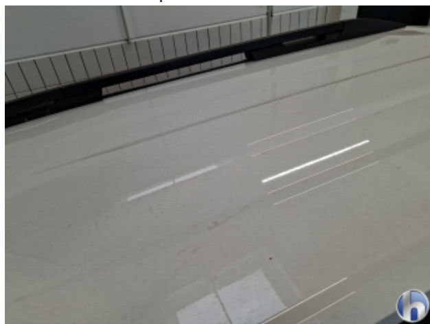
3. Dach 1 Delle - Sanft Instandsetzen
