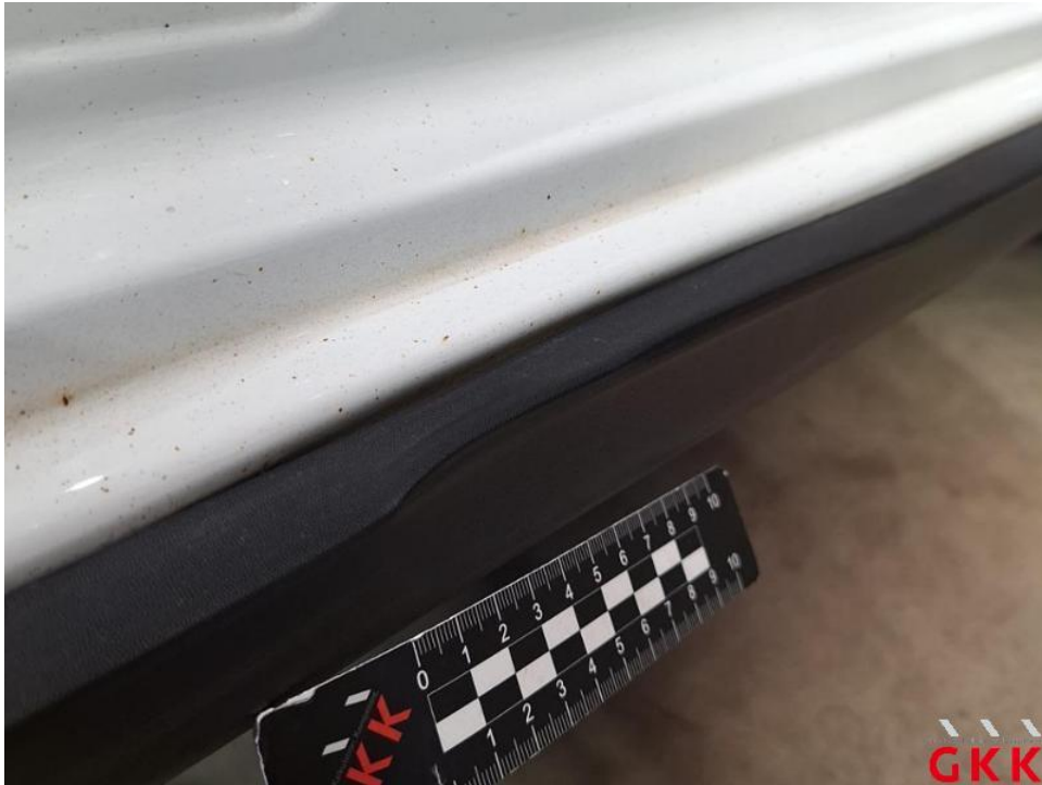
Bild 47. Schweller rechts, Abdeckung -unlackiert-, beschädigt, ersetzen
