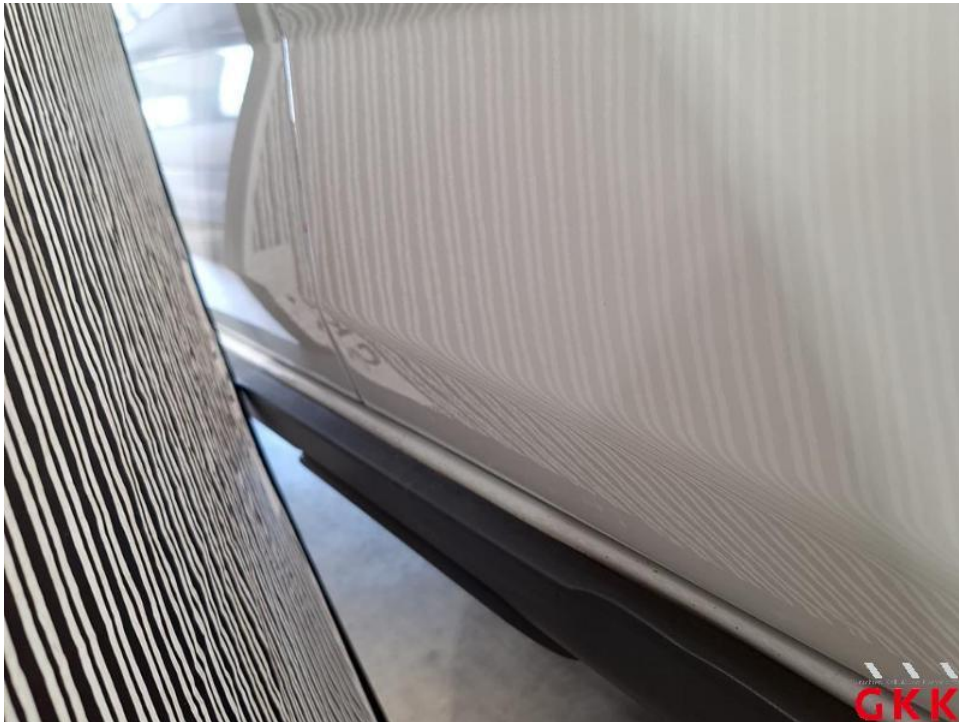
Bild 18. Tür vorne rechts, Reparaturmangel, instand setzen - lackieren
