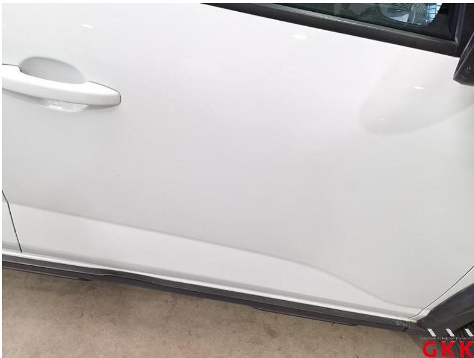
Bild 48. Tür vorne rechts, beschädigt, instand setzen - lackieren
