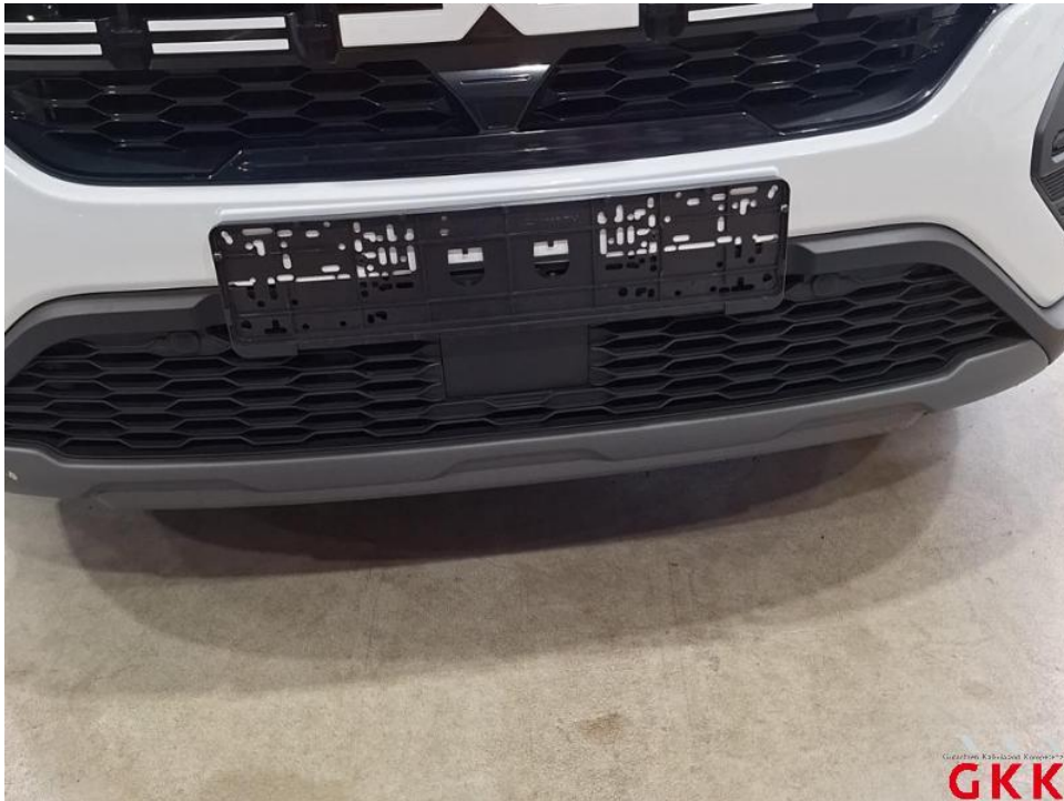
Bild 20. Stoßfänger vorne, Spoiler -unlackiert-, verkratzt, ersetzen
