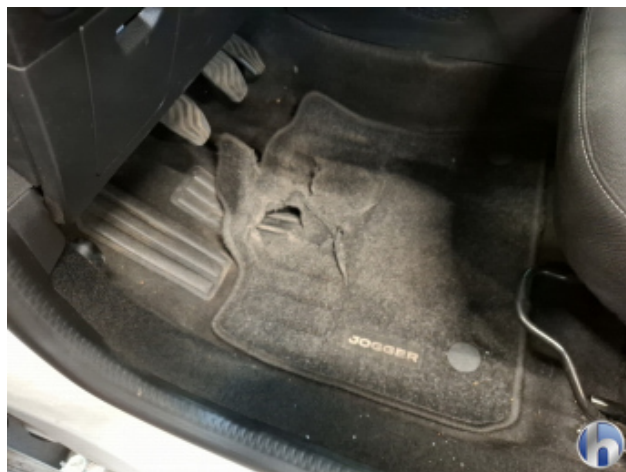
4. Fußmatten Vorn Beschädigt - Erneuern
