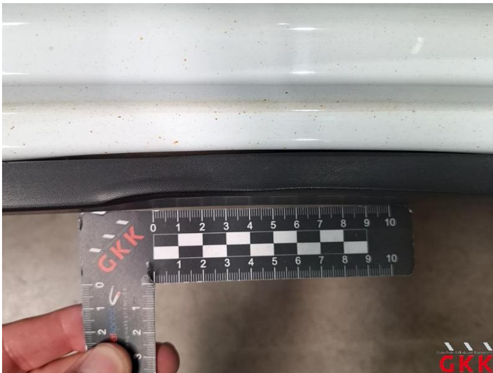
Bild 46. Schweller rechts, Abdeckung -unlackiert-, beschädigt, ersetzen
