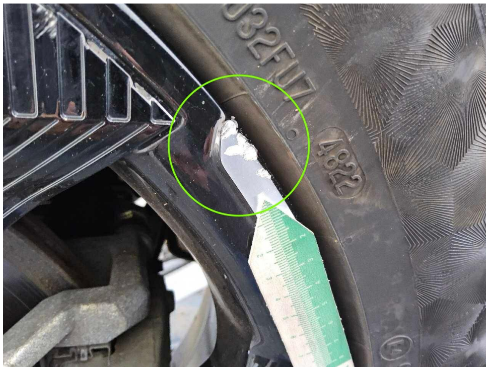
Bild 15 : Felge hinten rechts-zerkratzt mit Materialabtrag
