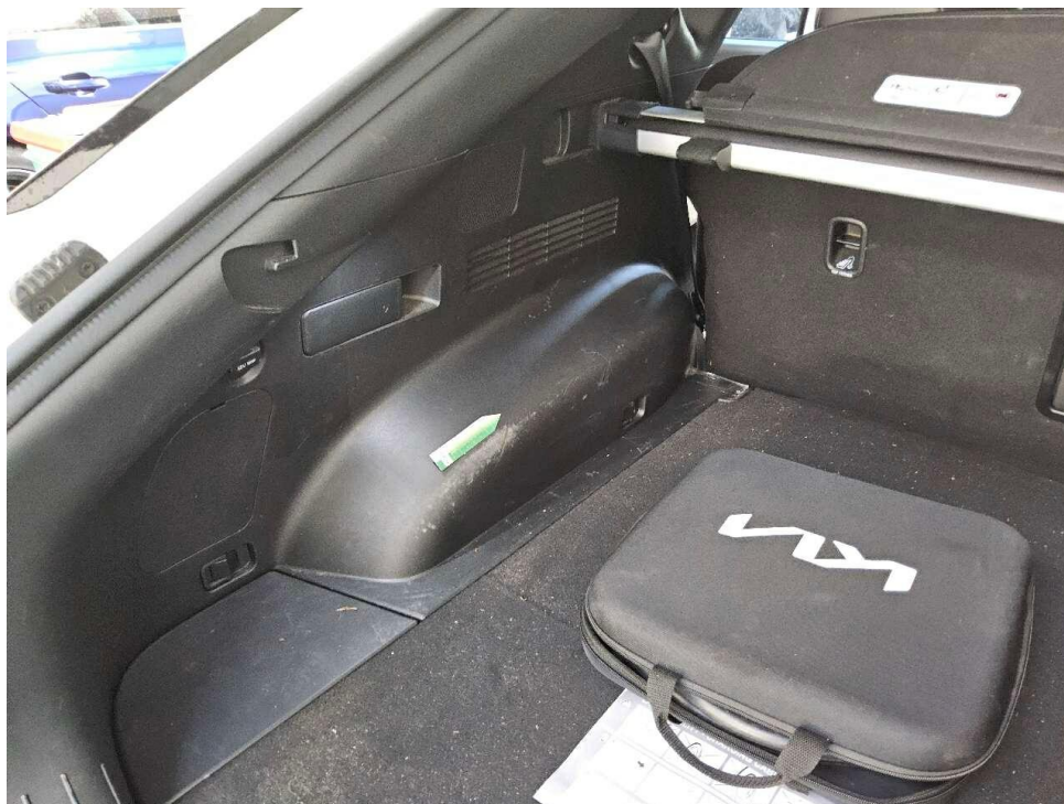
Bild 19 : Kofferraumverkleidung hinten links zerkratzt
