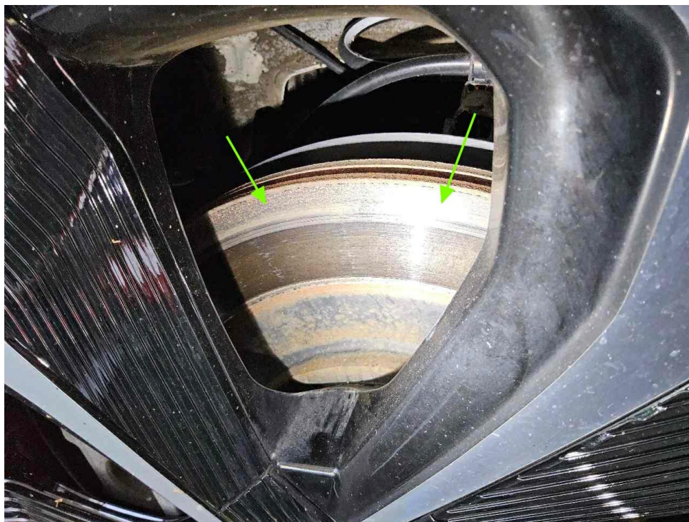
Bild 16 : Bremse hinten-Tragbild mangelhaft
