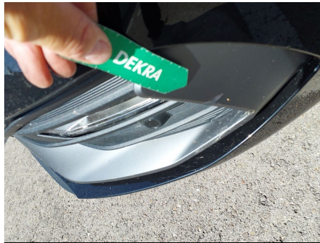
Moldura de paragolpes / Delantero Izquierdo / Abolladura
