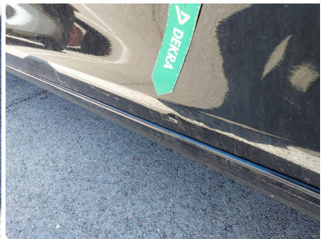
Puerta / Delantero Derecho / Abolladura
