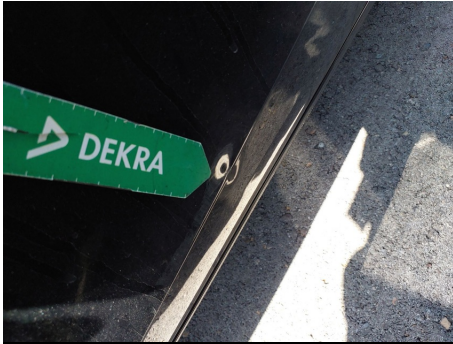
Puerta / Trasero Izquierdo / Abolladura
