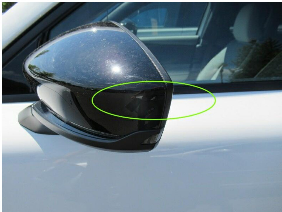
Bild 32 : Spiegelkappe links, verschrammt
