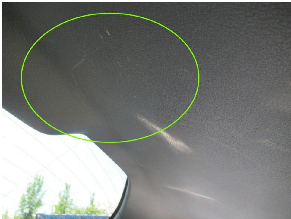
Bild 28 : Verkleidung Heckdeckel verschrammt
