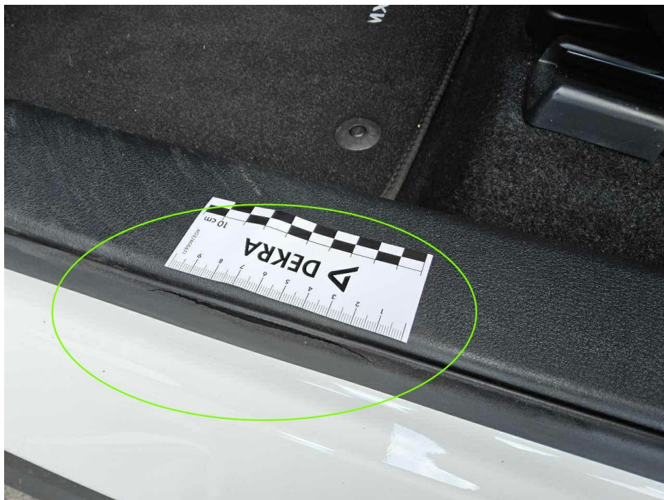
Bild 16 : Türdichtung vorne links, beschädigt
