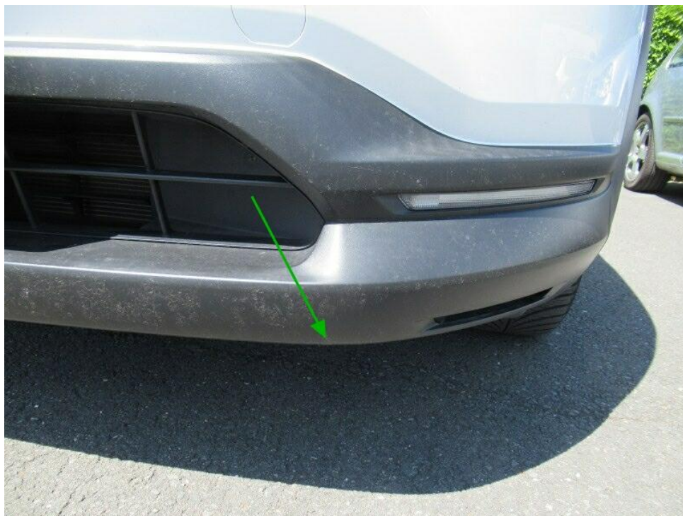
Bild 23 : Frontspoiler verschrammt außerhalb Sichtfeld
