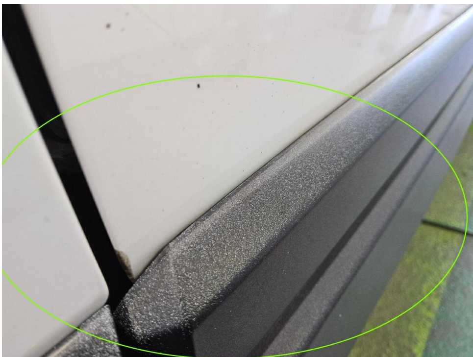
Bild 20 : Farbanhaftungen an mehreren Bauteilen ( Stoßfänger vorne, Felge vorne links, Radlaufblende links, Türblenden links)
