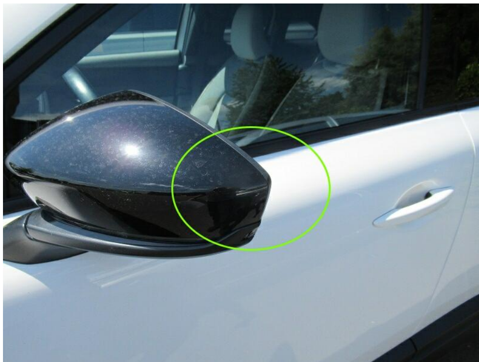
Bild 31 : Spiegelkappe links, verschrammt
