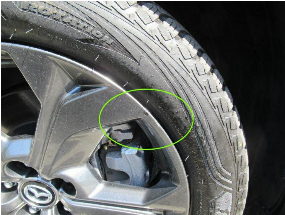
Bild 33 : Felge vorne rechts, leicht verschrammt
