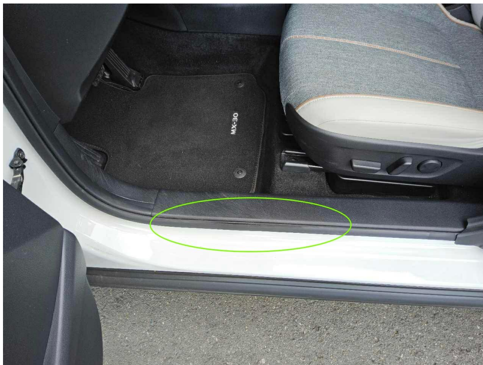
Bild 15 : Türdichtung vorne links, beschädigt
