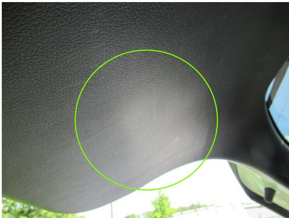
Bild 27 : Verkleidung Heckdeckel verschrammt
