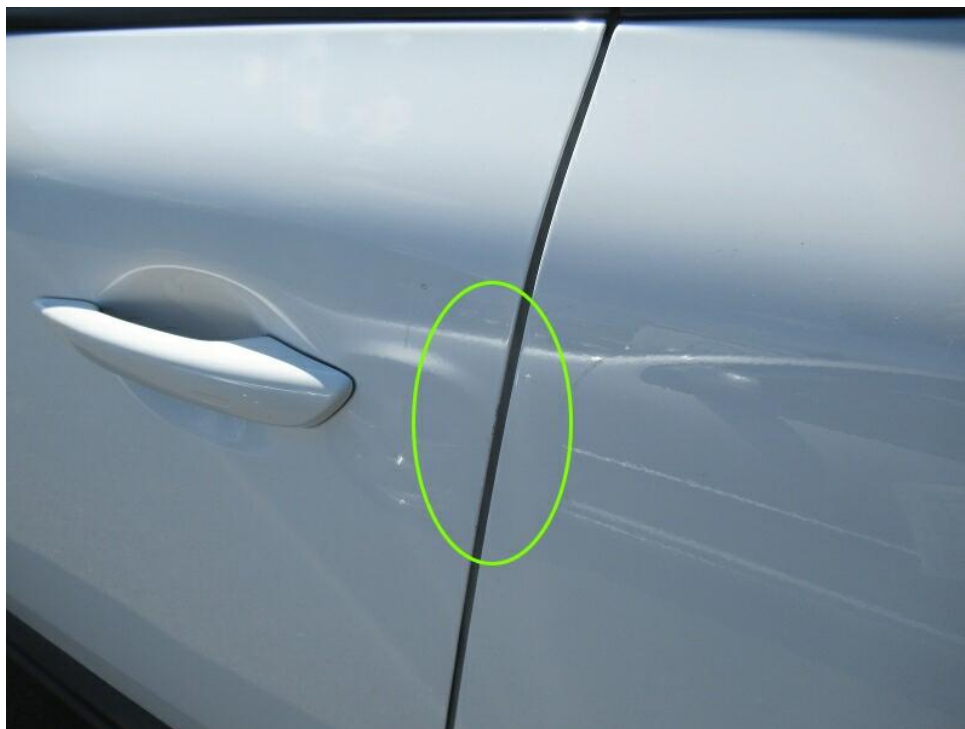
Bild 29 : Türkante vorne links, verschrammt
