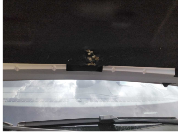
Beschädigung #1: Motorhaube: Dämmmatte - Marderschaden - erneuern
