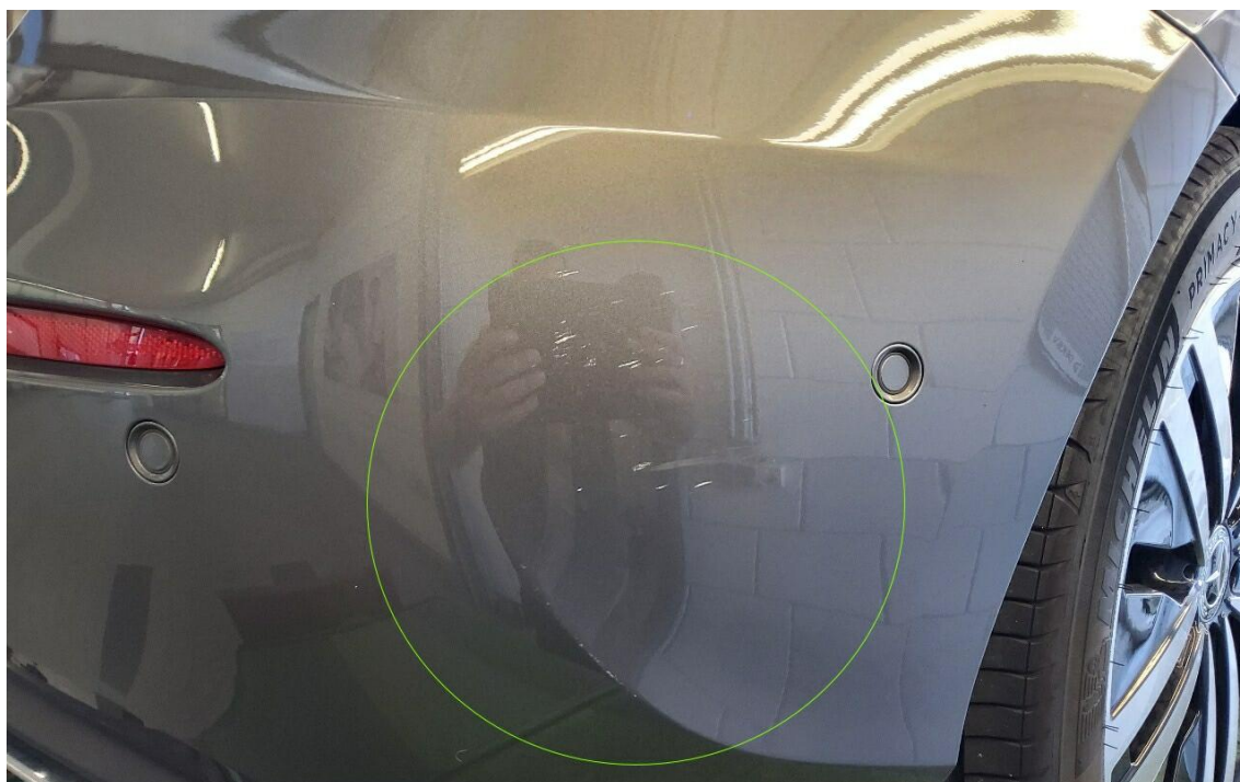
Bild 10 : Stoßfänger hinten verschrammt
