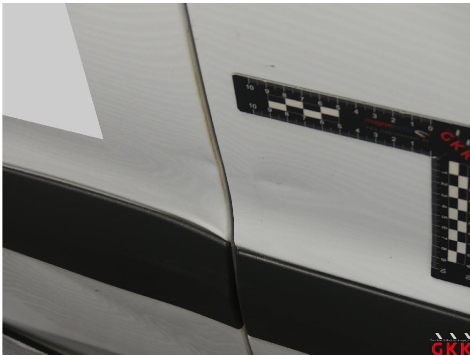
Bild 22 Tür vorne rechts, beschädigt, instand setzen - lackieren
