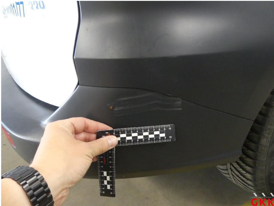
Bild 39 Stoßfänger hinten, Verkleidung -unlackiert-, verkratzt, ersetzen
