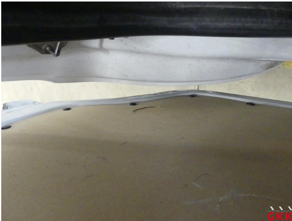
Bild 32 Tür hinten rechts, Innenverkleidung -Abdeckung-, beschädigt, ersetzen
