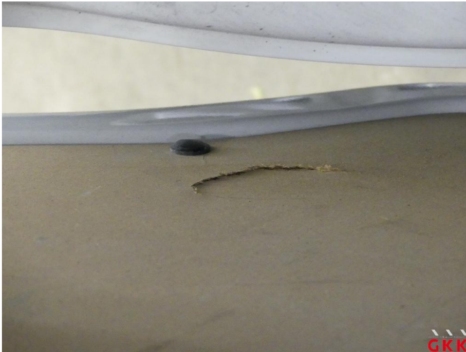
Bild 33 Tür hinten rechts, Innenverkleidung -Abdeckung-, beschädigt, ersetzen
