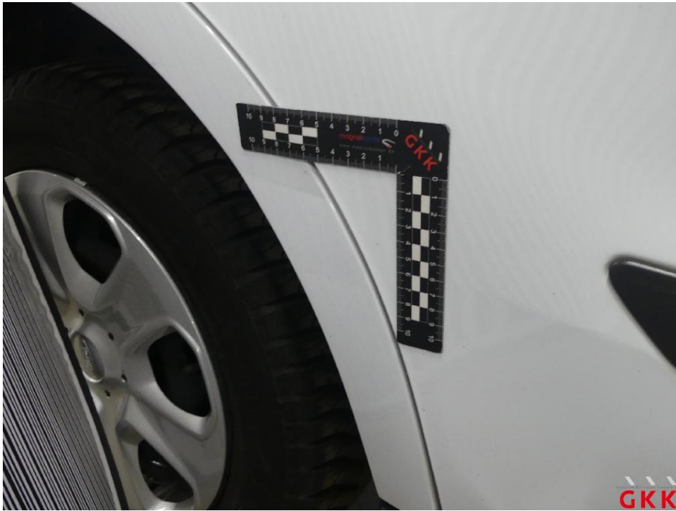
Bild 29 Seitenwand rechts, unterhalb, beschädigt, instand setzen - lackieren
