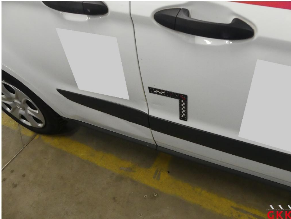
Bild 21 Tür vorne rechts, beschädigt, instand setzen - lackieren
