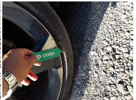
Neumático / Trasero Derecho / Desgarro
