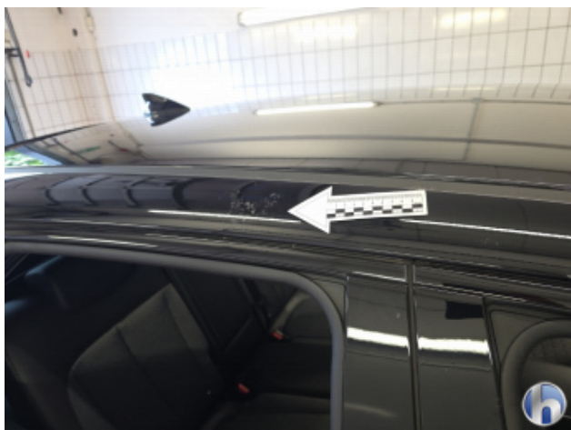
3. Dachrahmen - Links Verätzung - Entkleben / Reinigen
