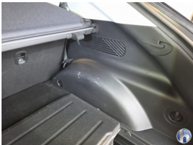
5. Verkleidung Kratzer - Erneuern
