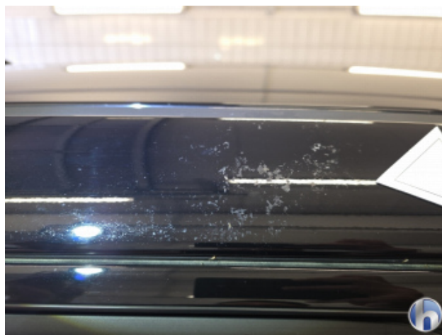
3. Dachrahmen - Links Verätzung - Entkleben / Reinigen
