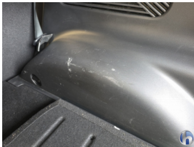
5. Verkleidung Kratzer - Erneuern
