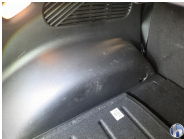
5. Verkleidung Kratzer - Erneuern
