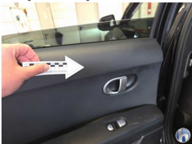
4. Türverkleidung Hinten - Links Kratzer - Erneuern
