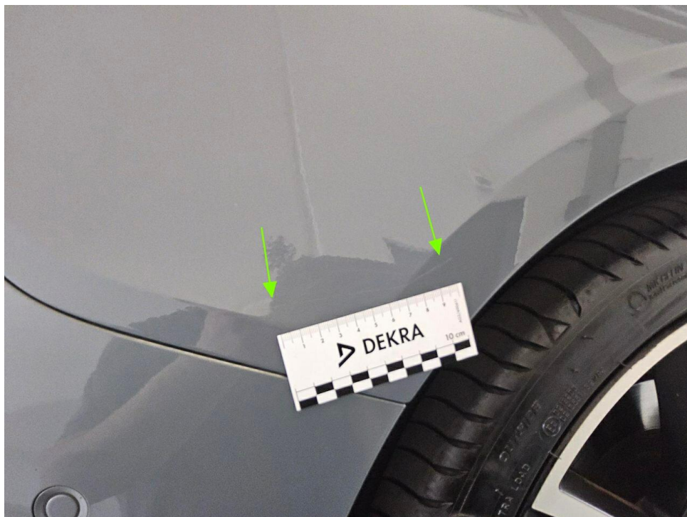
Bild 16 : Seitenteil hinten rechts Lackierung, zerkratzt, Gebrauchsspur
