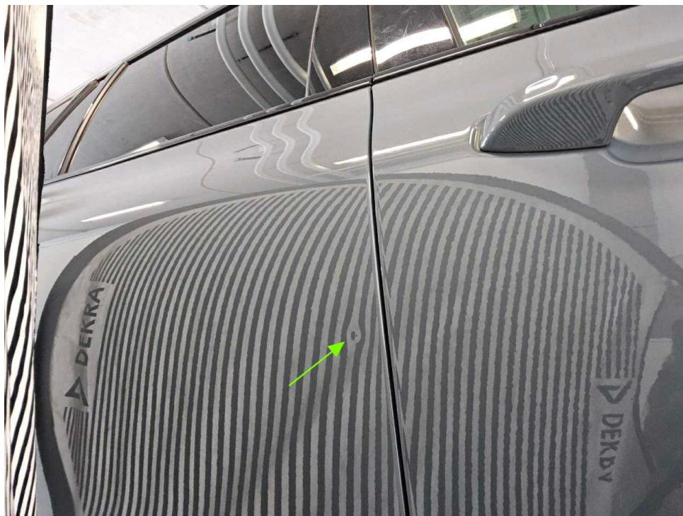
Bild 15 : Tür hinten rechts, eingedellt, drücken
