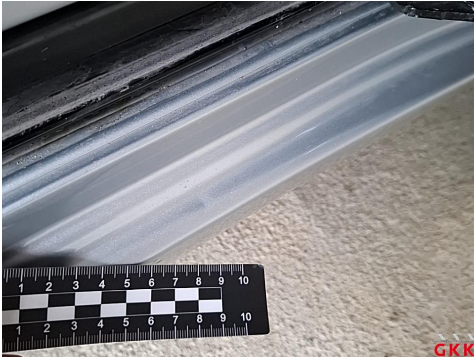
Bild 15. Tür hinten links, Einstieg, beschädigt, Smartrepair
