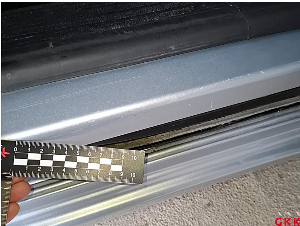
Bild 14. Tür hinten links, Einstieg, beschädigt, Smartrepair
