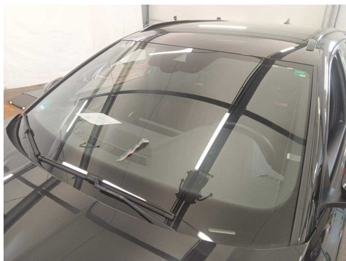
Damage 4: Vehicle glazing: Windscreen (Mit Rissbildung im Randbereich) - Stone chips - Replace
