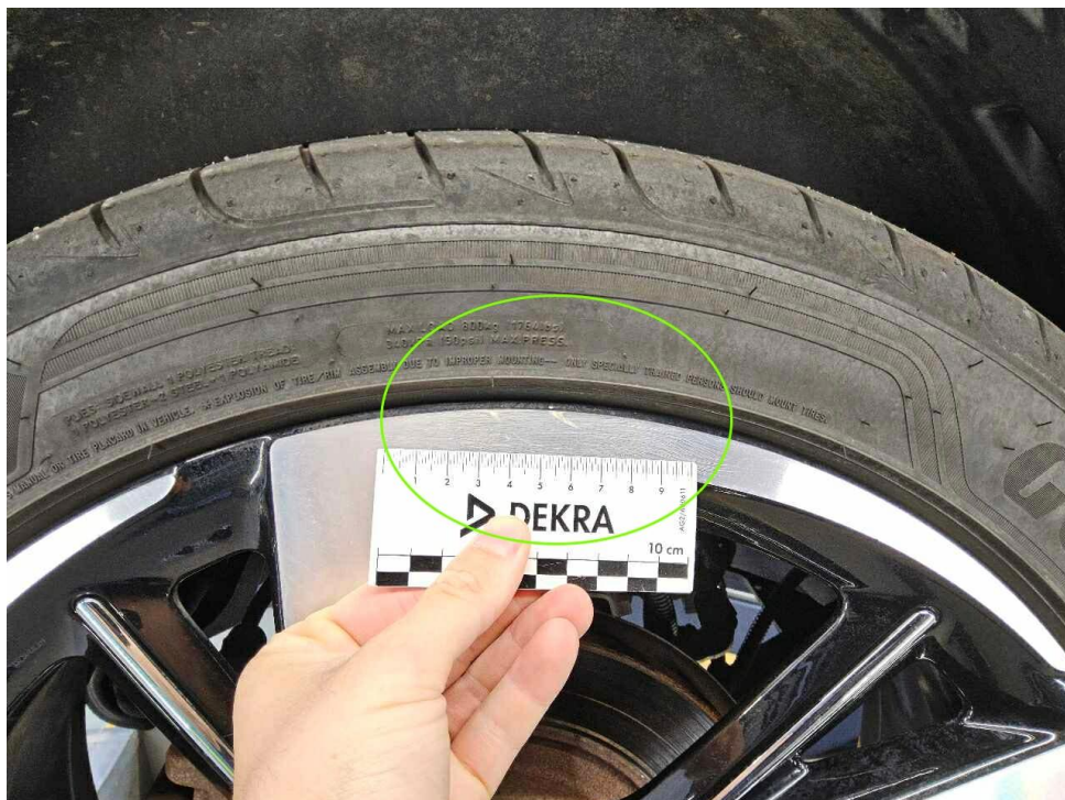
Bild 14 : Felge hinten rechts, glanzgedreht verschrammt
