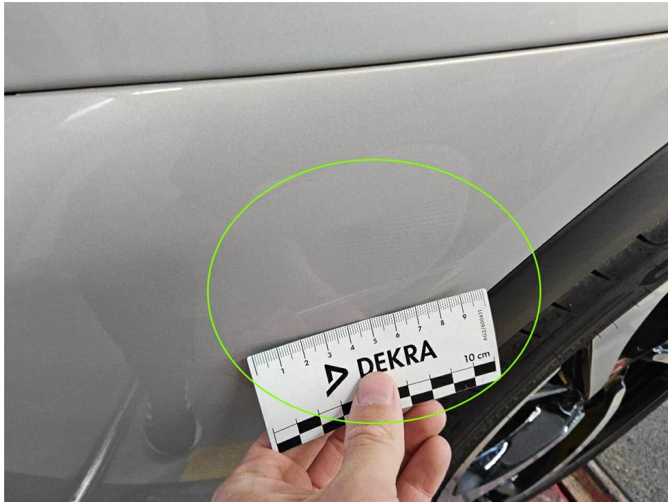
Bild 13 : Stoßfänger vorne links, verkratzt
