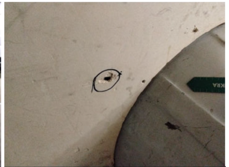
Innenverkleidung Laderaum / Rechts / Defekt
