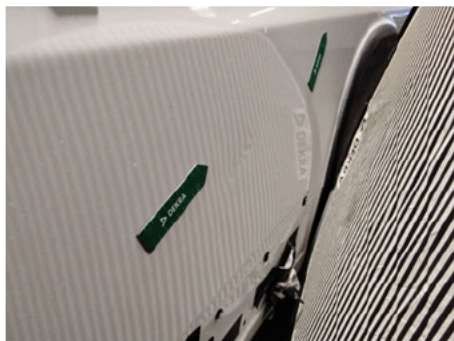
Seitenwand / Links / Delle
