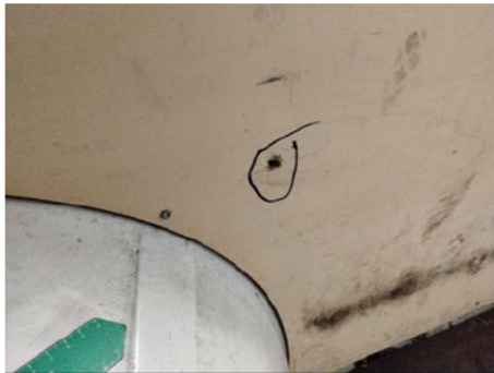
Innenverkleidung Laderaum / Rechts / Defekt
