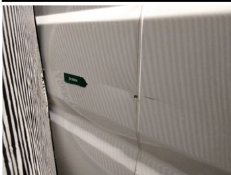
Seitenwand / Vorne Links / Delle
