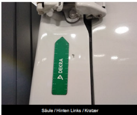
Säule / Hinten Links / Kratzer
