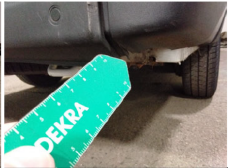
Stoßfänger / Hinten Rechts / Gebrochen
