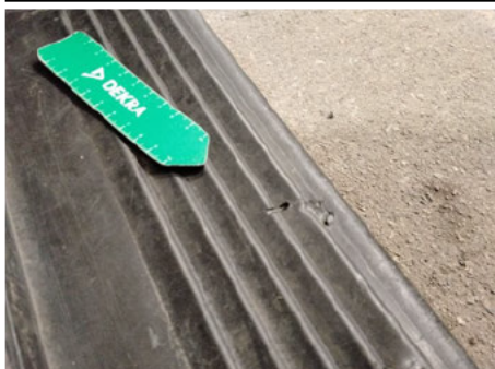
Stoßfänger / Hinten / Gebrochen
