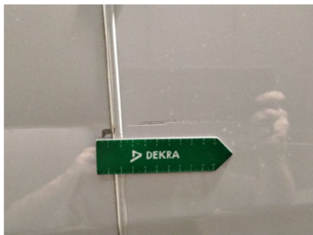
Seitenwand / Links / Delle
