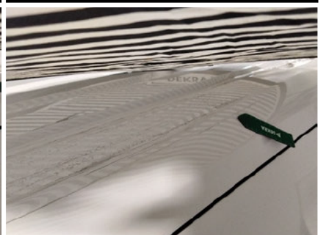
Dachholm / Vorne Rechts / Delle
