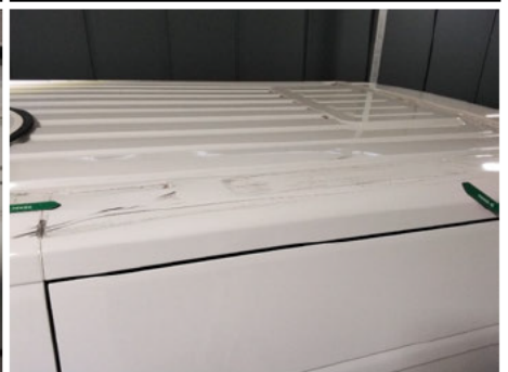
Dachholm / Vorne Rechts / Delle
