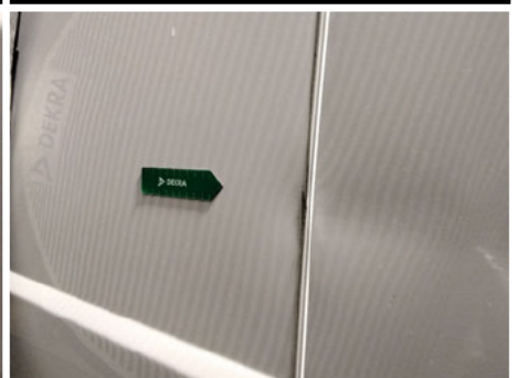
Seitenwand / Vorne Links / Delle
