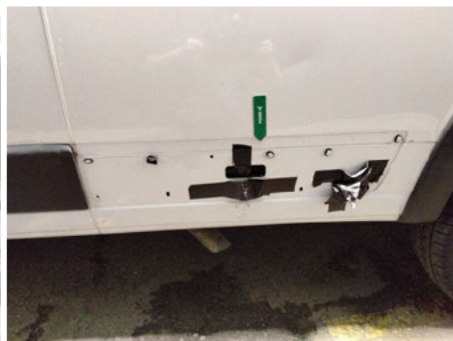
Positionsluchte / Links / Fehlt
