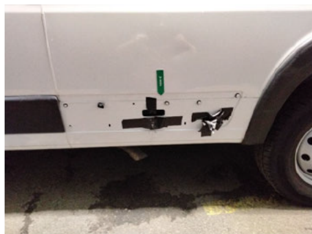
Zierleiste Seitenwand / Links / Fehlt
