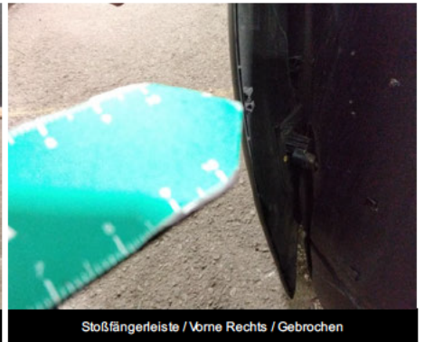
Stoßfänger / Vorne Rechts / Gebrochen
