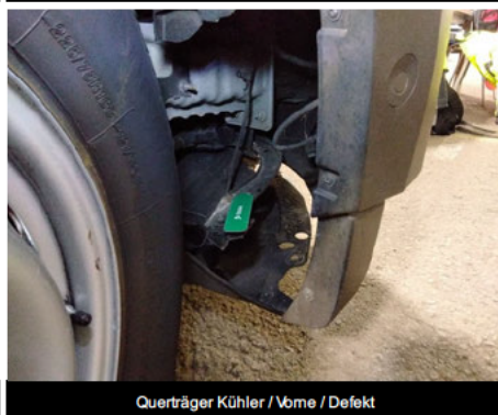
Querträger Kühler / Vorne / Defekt
