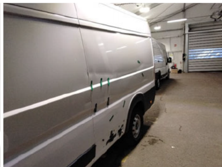
Seitenwand / Links / Delle
