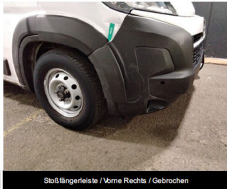
Stoßfänger / Vorne Rechts / Gebrochen
