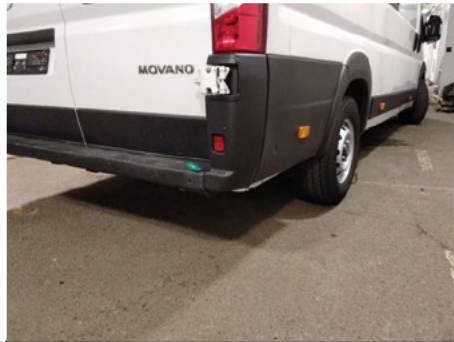
Stoßfänger / Hinten Rechts / Gebrochen
