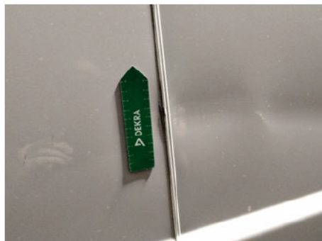
Seitenwand / Vorne Links / Delle
