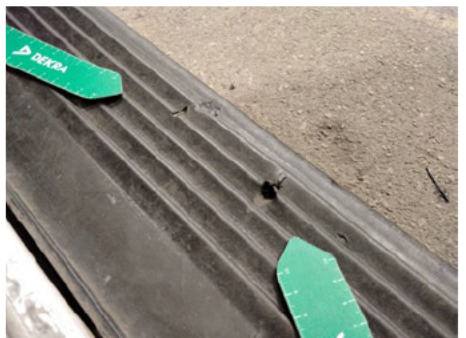
Stoßfänger / Hinten / Gebrochen
