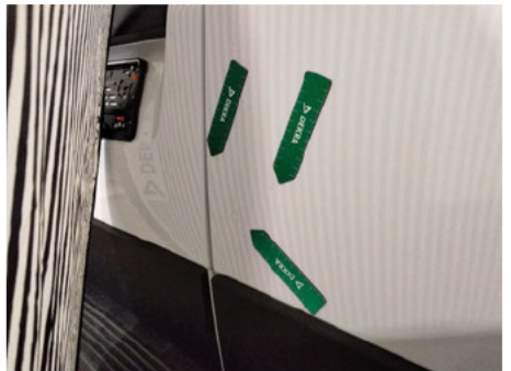
Heckklappe / Kofferraumtür / Hinten Rechts / Delle
