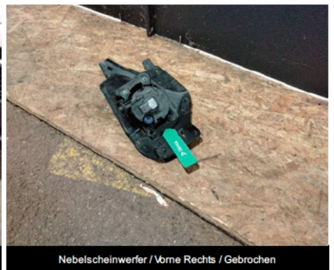
Nebelscheinwerfer / Vorne Rechts / Gebrochen
