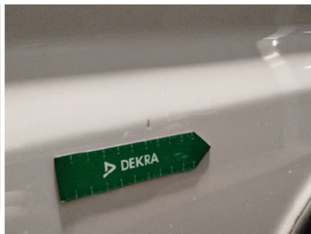
Seitenwand / Links / Delle
