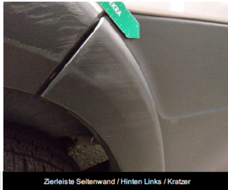
Kotflügelzierleiste / Hinten Links / Kratzer
