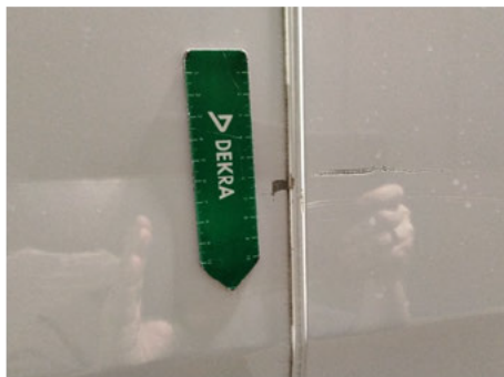
Seitenwand / Vorne Links / Delle
