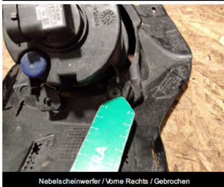
Nebelscheinwerfer / Vorne Rechts / Gebrochen
