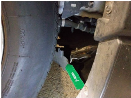
Unterfahrschutz / Vorne / Gebrochen
