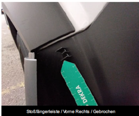
Stoßfängerleiste / Vorne Rechts / Gebrochen
