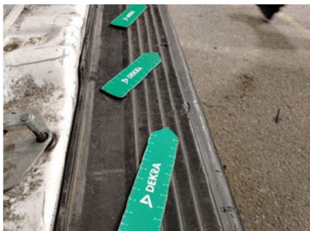
Stoßfänger / Hinten / Gebrochen
