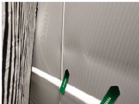
Seitenwand / Links / Delle
