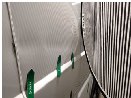
Seitenwand / Links / Delle
