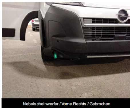
Nebelscheinwerfer / Vorne Rechts / Gebrochen
