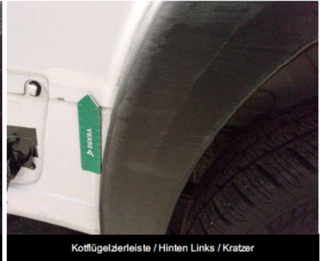
Kotflügelzierleiste / Hinten Links / Kratzer
