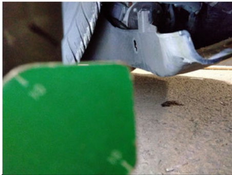
Unterfahrschutz / Vorne / Gebrochen
