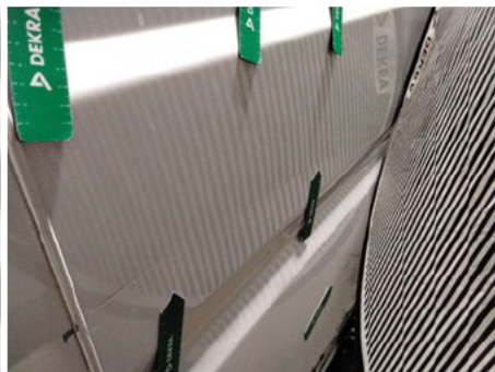
Seitenwand / Links / Delle
