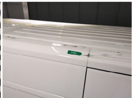
Dachholm / Rechts / Delle
