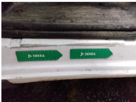
Türeinstieg / Vorne Links / Kratzer
