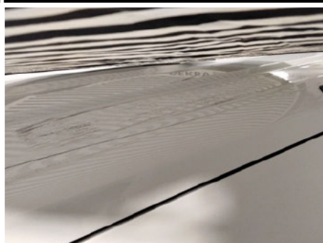
Dachholm / Vorne Rechts / Delle
