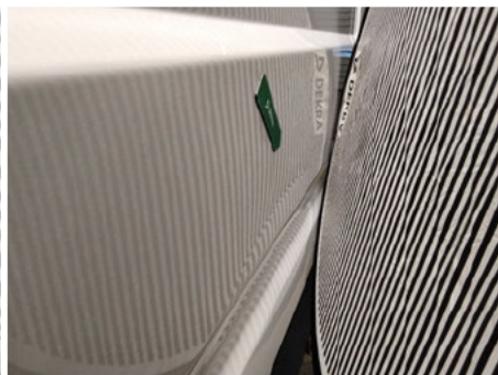
Seitenwand / Links / Delle
