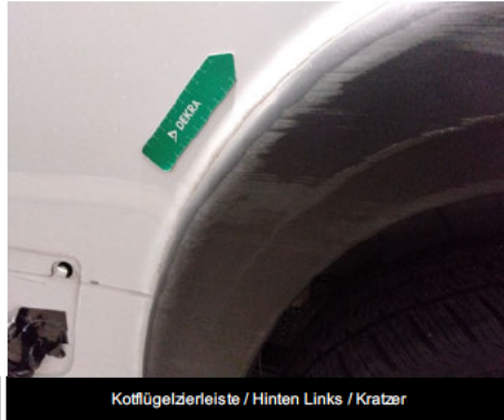
Kotflügelzierleiste / Hinten Links / Kratzer
