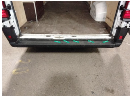
Stoßfänger / Hinten / Gebrochen
