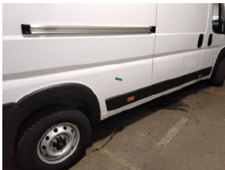
Seitenwand / Rechts / Delle
