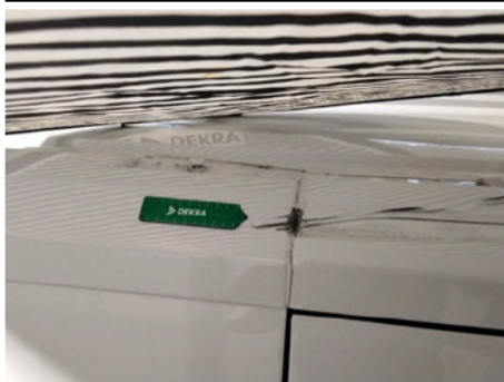
Dachholm / Rechts / Delle
