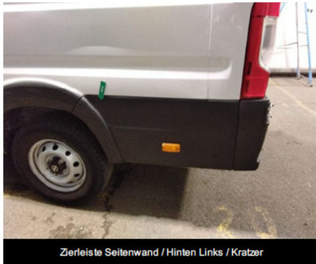
Kotflügelzierleiste / Hinten Links / Kratzer
