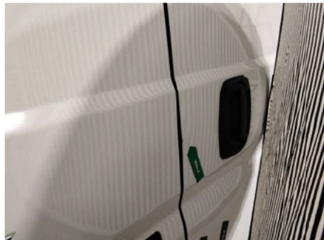
Heckklappe / Kofferraumtür / Hinten Rechts / Delle
