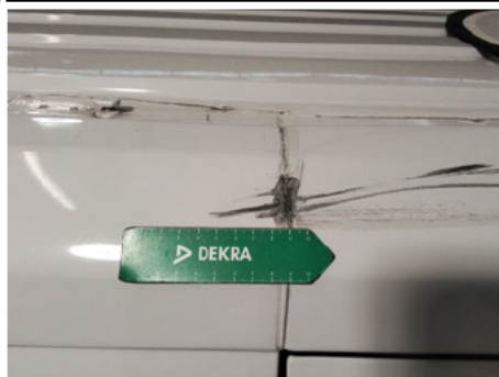
Dachholm / Rechts / Delle
