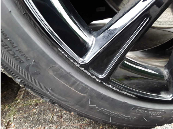
Beschädigung 1: Rad/Reifen: Leichtmetallfelge vorn rechts (Gehört nicht zur Serienausstattung) - verkratzt / verschürft - kein
