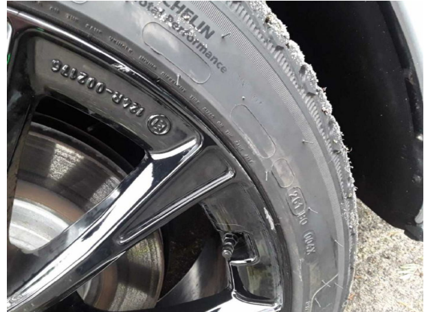
Beschädigung 1: Rad/Reifen: Leichtmetallfelge vorn rechts (Gehört nicht zur Serienausstattung) - verkratzt / verschürft -
