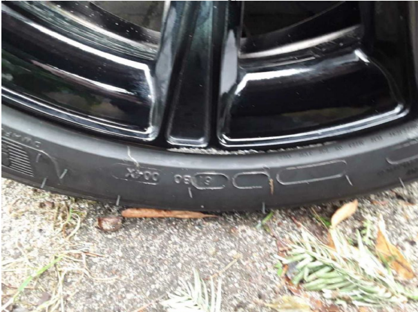
Beschädigung 2: Rad/Reifen: Leichtmetallfelge hinten rechts (Gehört nicht zur Serienausstattung) - verkratzt / verschürft - kein
