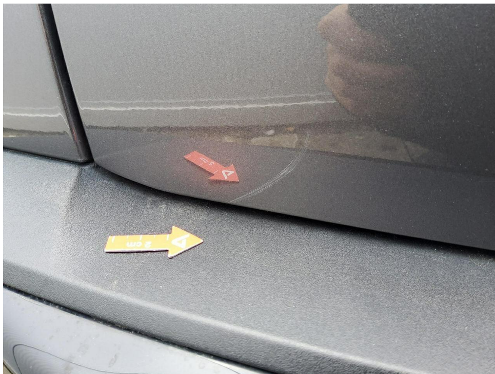
Bild 8 : Heckdeckel Lackierung, zerkratzt, smart repair
