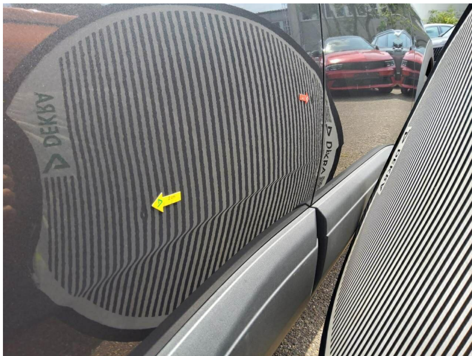
Bild 11 : Tür hinten rechts, mehrfach eingedellt, drücken
