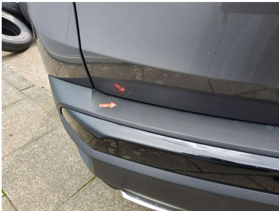
Bild 7 : Heckdeckel Lackierung, zerkratzt, smart repair
