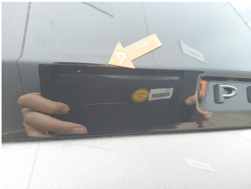
Bild 10 : Heckdeckel Lackierung, zerkratzt, smart repair
