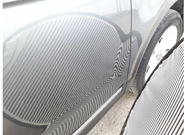
Beschädigung #2: Tür vorn rechts: Tür (Lackoberfläche Staubeinschlüsse) - lackieren
