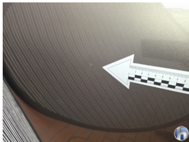
1. Tür Hinten - Rechts 1 Delle - Smart Repair
