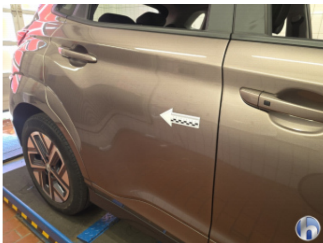
1. Tür Hinten - Rechts 1 Delle - Smart Repair
