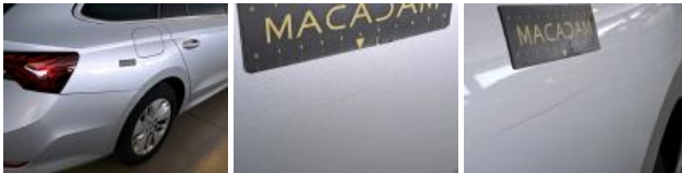
Door RR, Scratch(es), Acceptable
