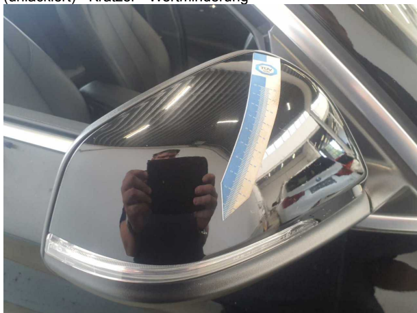
Beschädigung #3: Außenspiegel rechts: Abdeckkappe - Steinschlag - lackieren
