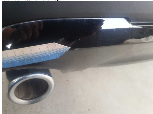
Beschädigung #5: Stossfänger hinten: Spoiler - Kratzer - instandsetzen und lackieren
