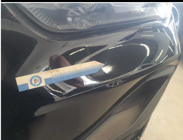
Beschädigung #4: Stossfänger vorn: Stossfänger vorn - Steinschlag - Smart Repair
