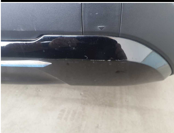
Beschädigung #5: Stossfänger hinten: Spoiler - Kratzer - instandsetzen und lackieren
