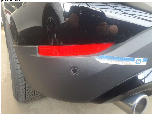
Beschädigung #2: Stossfänger hinten: Stossfänger hinten (unlackiert) - Kratzer - Wertminderung
