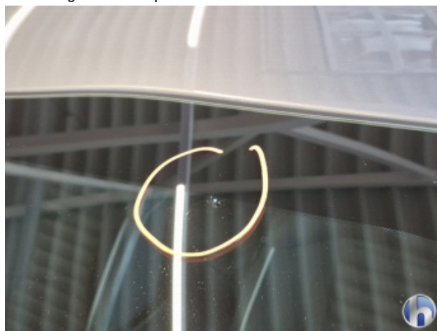
6. Windschutzscheibe Riss - Erneuern
