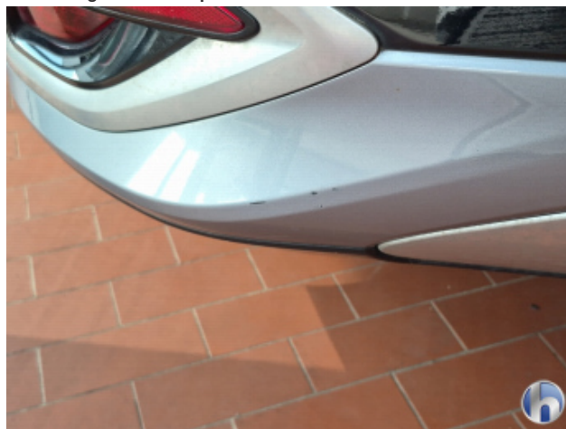
5. Stoßfänger Hinten Beschädigt - Smart Repair
