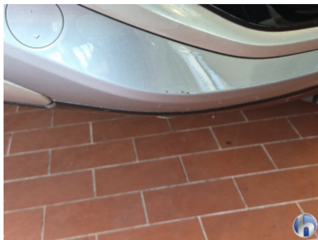
5. Stoßfänger Hinten Beschädigt - Smart Repair
