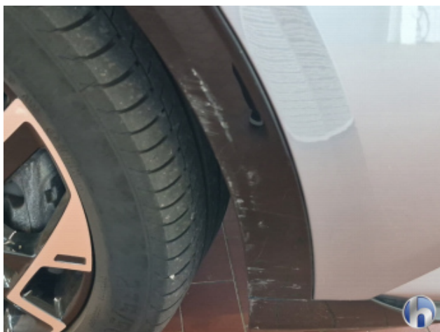
4. Kotflügel Vorne - Rechts Beschädigt - Smart Repair
