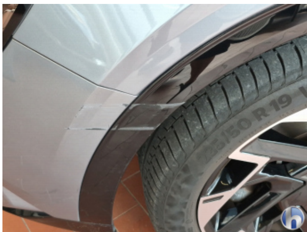
1. Kotflügel Vorne - Links Beschädigt - Instandsetzen und Lackieren
