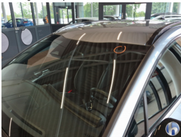
6. Windschutzscheibe Riss - Erneuern
