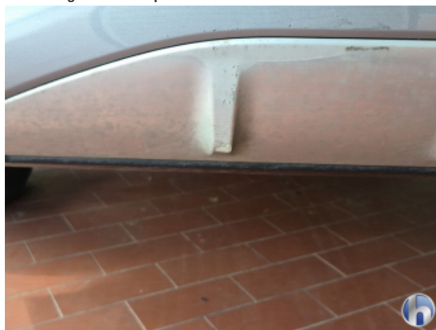
5. Stoßfänger Hinten Beschädigt - Smart Repair
