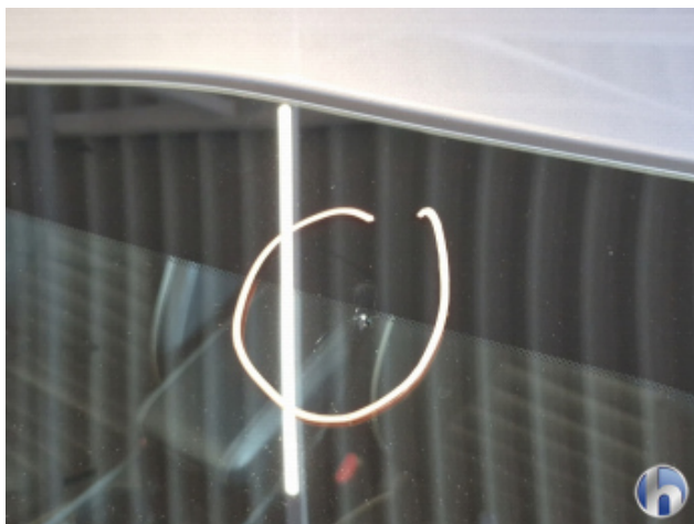
6. Windschutzscheibe Riss - Erneuern
