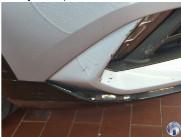
3. Stoßfänger Vorne Beschädigt - Smart Repair
