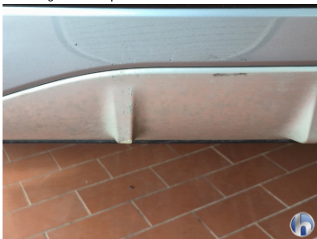
5. Stoßfänger Hinten Beschädigt - Smart Repair
