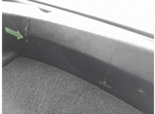
Beschädigung #1: Verkleidungen/Abdeckungen: Verkleidung Ladekante - verkratzt / verschürft - erneuern
