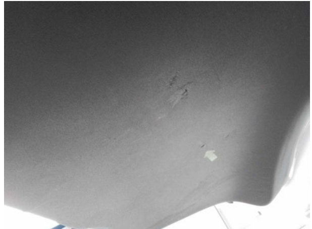
Beschädigung #2: Verkleidungen/Abdeckungen: Heckdeckel, Innenverkleidung - verkratzt / verschürft - erneuern
