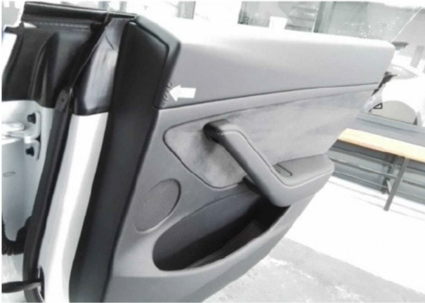
Beschädigung #7: Verkleidungen/Abdeckungen: Türverkleidung hint... links - verkratzt / verschürft - erneuern
