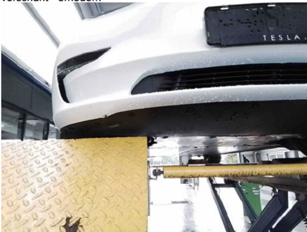
Beschädigung #6: Karosserie: Unterbodenverkleidung - verkratzt / verschürft - erneuern
