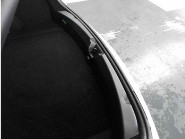
Beschädigung #1: Verkleidungen/Abdeckungen: Verkleidung Ladekante - verkratzt / verschürft - erneuern
