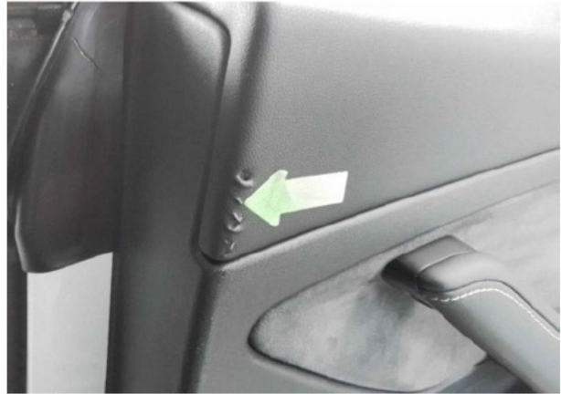
Beschädigung #7: Verkleidungen/Abdeckungen: Türverkleidung hinten links - verkratzt / verschürft - erneuern
