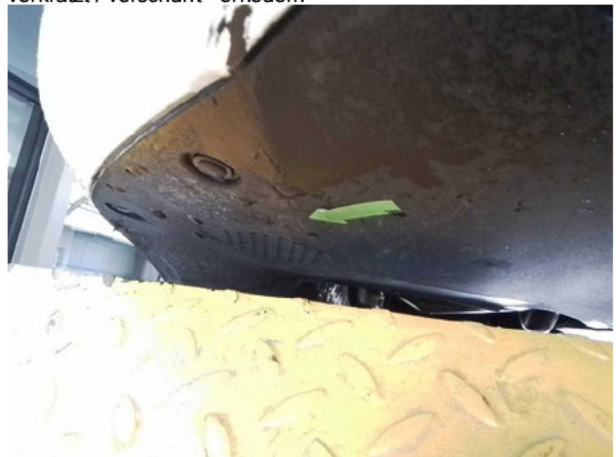
Beschädigung #6: Karosserie: Unterbodenverkleidung - verkratzt / verschürft - erneuern
