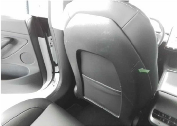
Beschädigung #4: Sitz vorn: Sitzkastenverkleidung links - verkratzt / verschürft - erneuern
