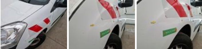
Panneau ARG, Pas d'origine, LI - Réparer et peindre (complet)
