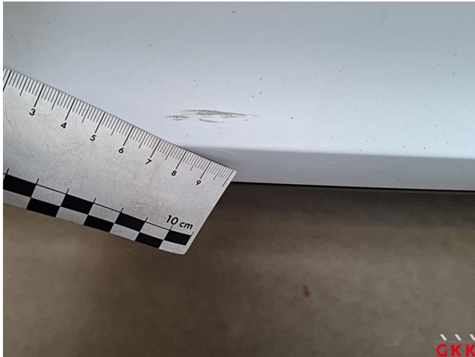
Bild 25 Stoßfänger hinten, Verkleidung -lackiert-, verkratzt, lackieren
