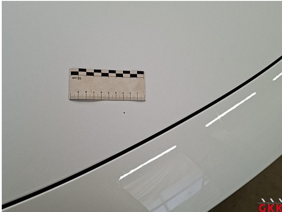
Bild 19 Motorhaube, Steinschlag, auslegen, schleifen, polieren
