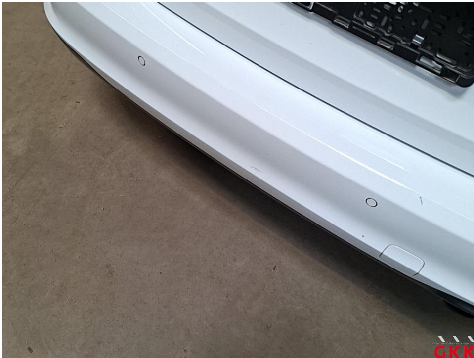
Bild 24 Stoßfänger hinten, Verkleidung -lackiert-, verkratzt, lackieren
