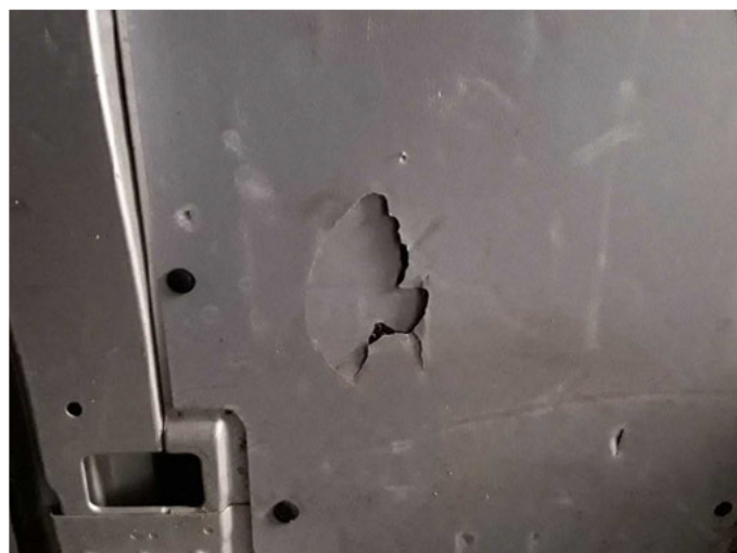
Beschädigung 15: Verkleidungen/Abdeckungen: Laderaumverkleidung rechts - beschädigt - erneuern
