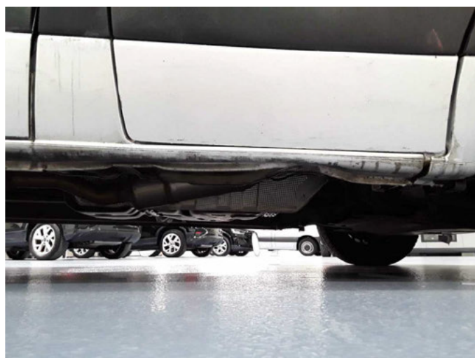
Beschädigung 42: Schweller rechts: Schweller - beschädigt - erneuern
