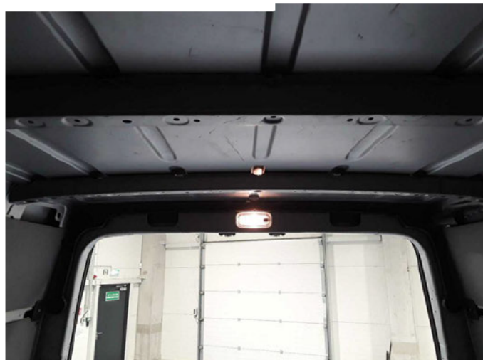
Beschädigung 21: Verkleidungen/Abdeckungen: Dachhimmel - beschädigt - instandsetzen und lackieren
