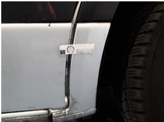
Beschädigung 30: Schweller rechts: Verkleidung - beschädigt - erneuern
