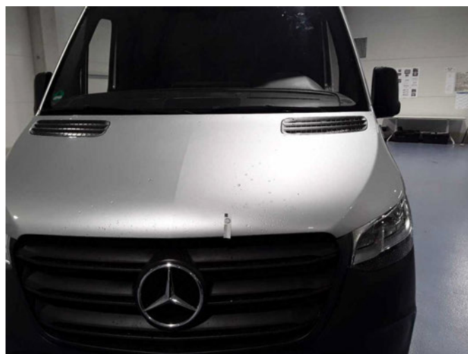
Beschädigung 32: Motorhaube: Motorhaube - Delle(n) - sanft instandsetzen
