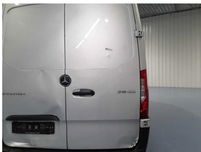
Beschädigung 20: Heckklappe/-tür: Hecktür rechts - beschädigt - erneuern
