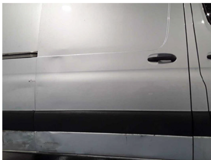
Beschädigung 48: Schiebetür rechts: Schiebetür - beschädigt - erneuern
