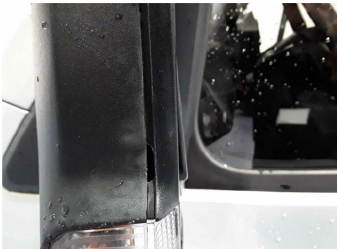
Beschädigung 47: Außenspiegel links: Abdeckkappe - beschädigt - erneuern
