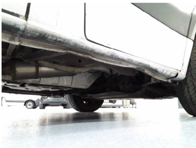
Beschädigung 42: Schweller rechts: Schweller - beschädigt - erneuern
