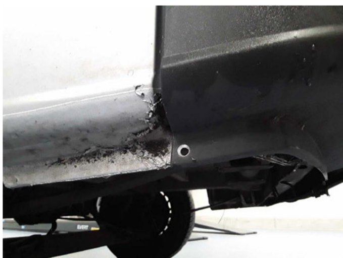
Beschädigung 9: Seitenwand links: Radlauf - nicht fachgerecht instandgesetzt - erneuern
