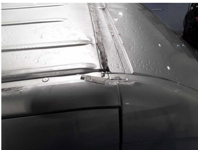
Beschädigung 37: Fahrzeugdach: Dachholm rechts - beschädigt - erneuern
