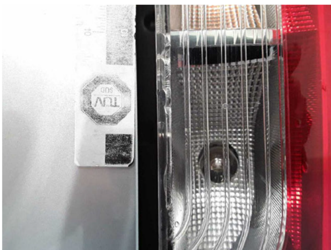
Beschädigung 23: Heckleuchte: Heckleuchte rechts - beschädigt - erneuern
