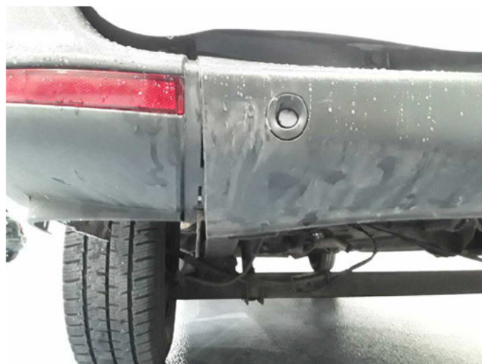
Beschädigung 12: Stossfänger hinten: Stossfänger hinten (unlackiert) - beschädigt - erneuern
