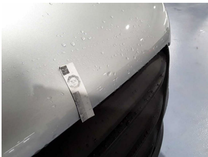
Beschädigung 32: Motorhaube: Motorhaube - Delle(n) - sanft instandsetzen
