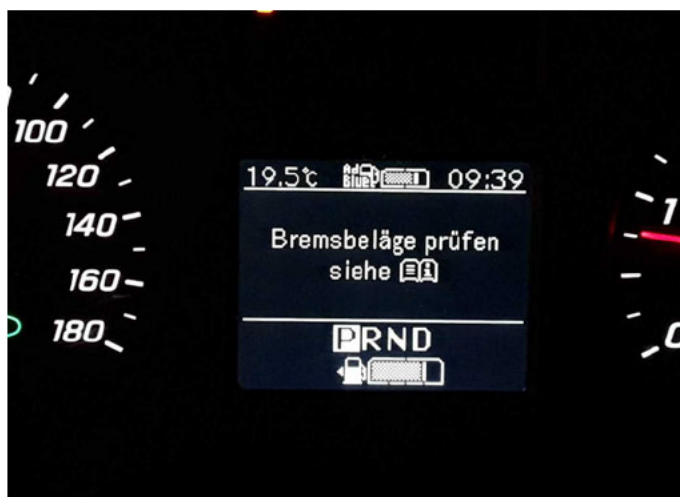
Beschädigung 43: Bremsanlage: Bremsanlage - leuchtet - Diagnose durchführen
