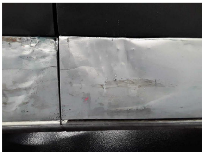
Beschädigung 48: Schiebetür rechts: Schiebetür - beschädigt - erneuern
