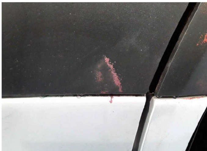
Beschädigung 49: Tür vorn rechts: Zierleiste unten - beschädigt - erneuern
