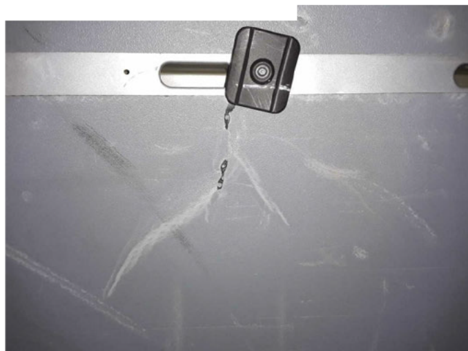
Beschädigung 19: Verkleidungen/Abdeckungen: Laderaumverkleidung links - beschädigt - erneuern
