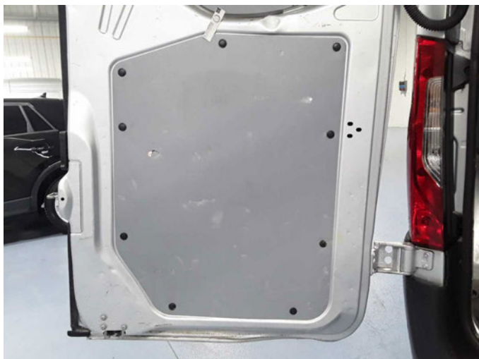
Beschädigung 13: Heckklappe/-tür: Verkl. Hecktür Sperrholz unten - beschädigt - erneuern
