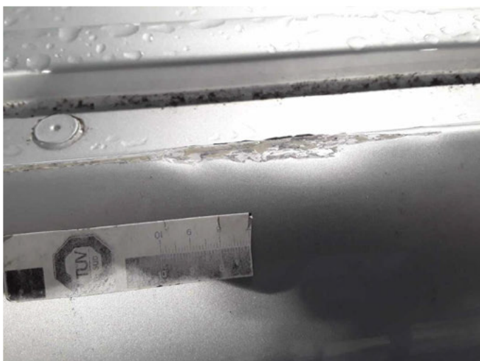
Beschädigung 36: Fahrzeugdach: Dachholm rechts - beschädigt - erneuern
