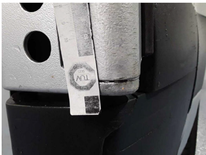
Beschädigung 50: Heckklappe/-tür: Scharnier unten - verkratzt / verschürft - lackieren
