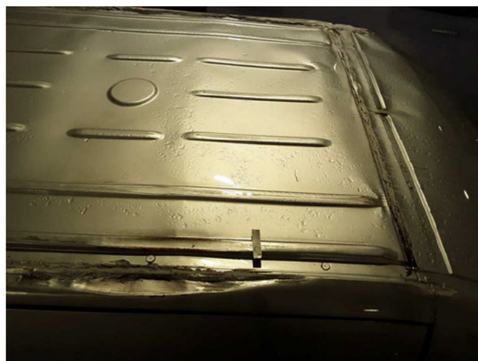
Beschädigung 39: Fahrzeugdach: Dach - verformt - erneuern
