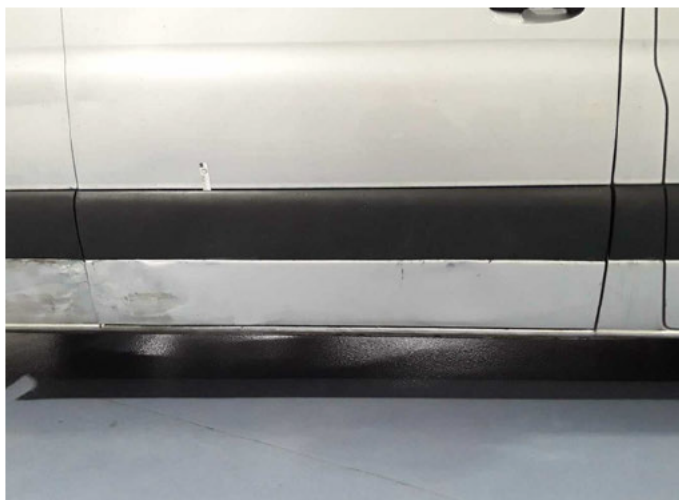
Beschädigung 26: Schiebetür rechts: Schutzleiste - beschädigt - erneuern
