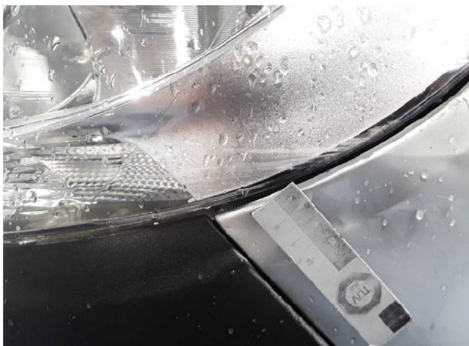
Beschädigung 33: Scheinwerfer: Scheinwerfer links - beschädigt - erneuern
