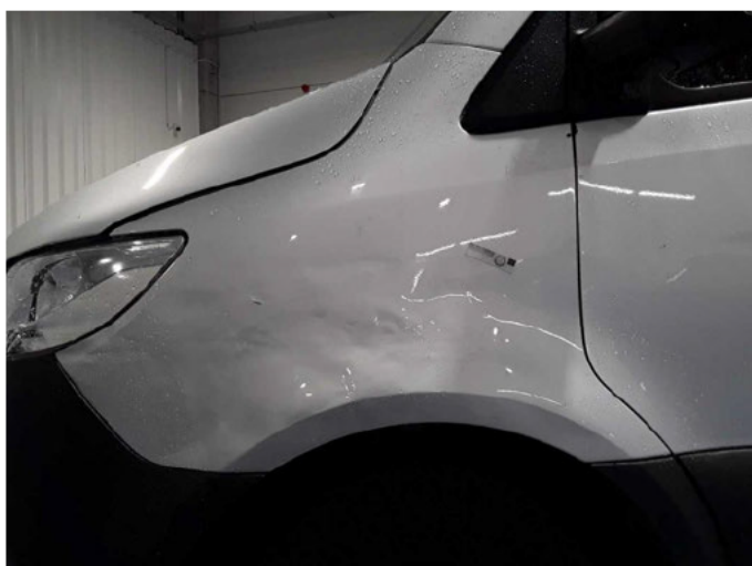
Beschädigung 2: Kotflügel links: Kotflügel links - beschädigt - erneuern
