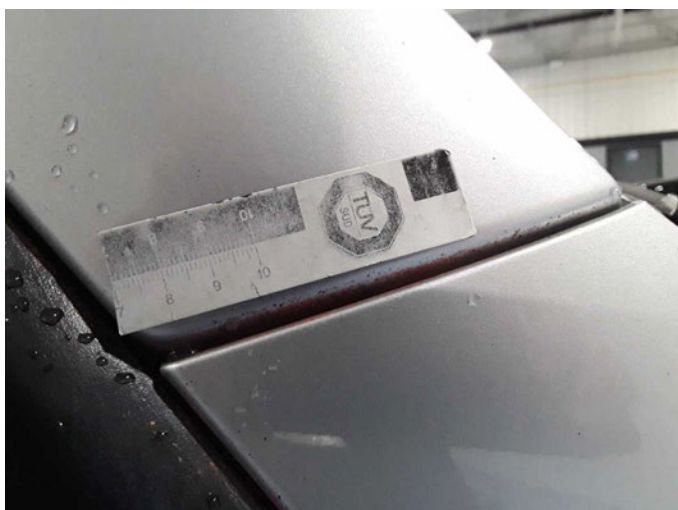
Beschädigung 31: Fahrzeugdach: Dachholm rechts - verschmutzt - lackieren
