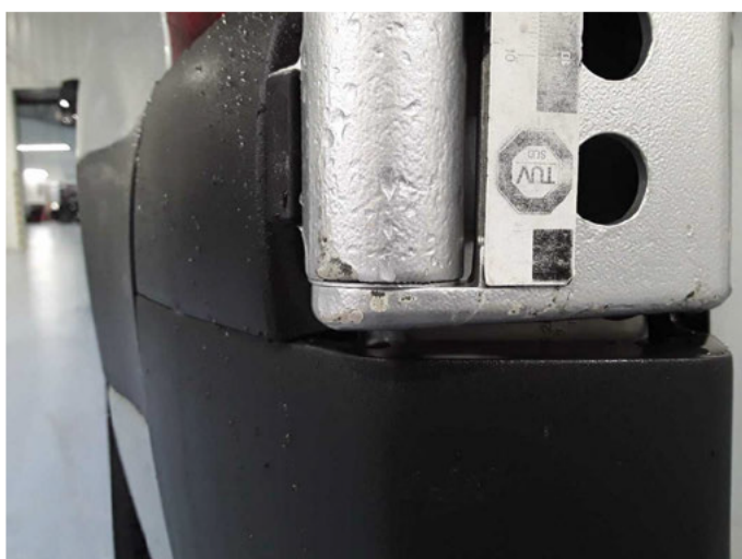
Beschädigung 7: Heckklappe/-tür: Scharnier - verkratzt / verschürft - lackieren
