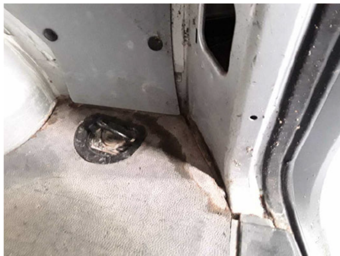
Beschädigung 22: Interieur: Laderaumboden (Undicht) - verschmutzt - kein Abzug
