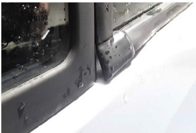
Beschädigung 3: Verglasung: Türscheibendichtung vorn links - verformt - erneuern
