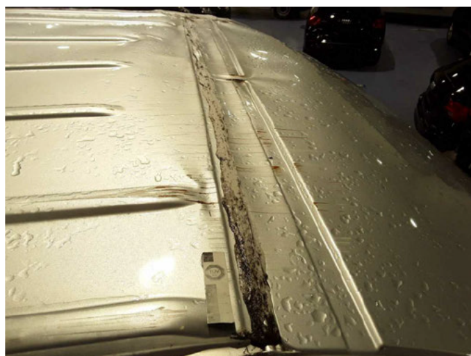
Beschädigung 38: Fahrzeugdach: Dach - beschädigt - erneuern
