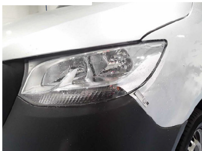
Beschädigung 33: Scheinwerfer: Scheinwerfer links - beschädigt - erneuern
