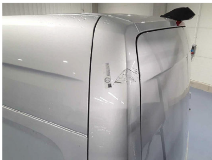
Beschädigung 41: Karosserie: D-Säule links - verkratzt / verschürft - lackieren
