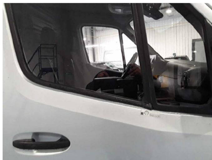
Beschädigung 29: Verglasung: Türscheibendichtung vorn rechts - beschädigt - erneuern
