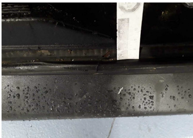
Beschädigung 14: Heckklappe/-tür: Dichtung - beschädigt - erneuern
