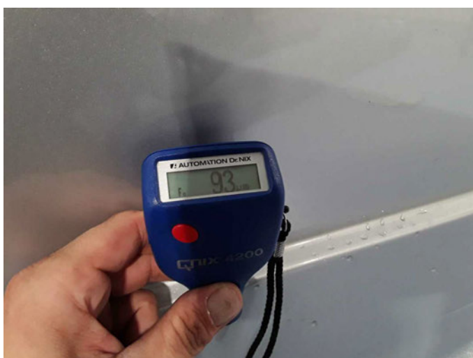
Tür hinten rechts: 93 \mu\text{m}
