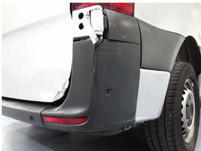
Beschädigung 24: Stossfänger hinten: Schutzleiste rechts - beschädigt - erneuern
