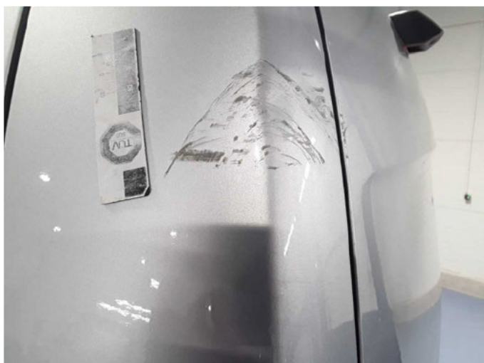
Beschädigung 41: Karosserie: D-Säule links - verkratzt / verschürft - lackieren
