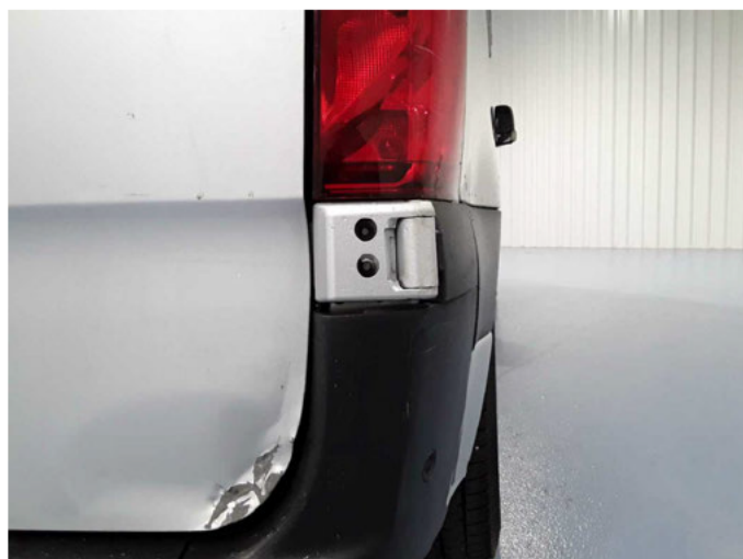
Beschädigung 50: Heckklappe/-tür: Scharnier unten - verkratzt / verschürft - lackieren
