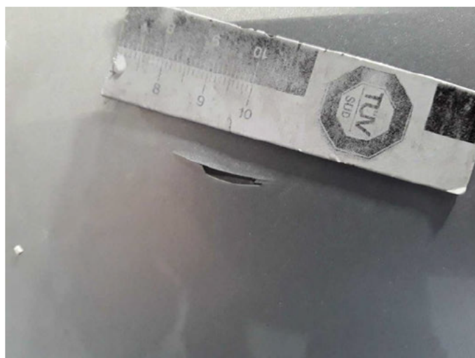
Beschädigung 2: Kotflügel links: Kotflügel links - beschädigt - erneuern
