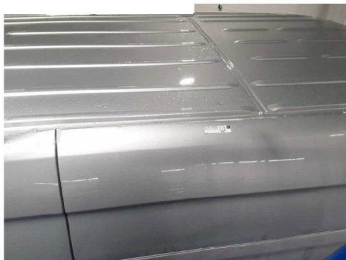
Beschädigung 40: Fahrzeugdach: Dachholm links - beschädigt - erneuern
