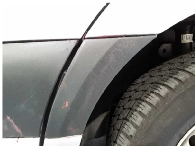
Beschädigung 27: Kotflügel rechts: Zierleiste, -gitter - beschädigt - erneuern
