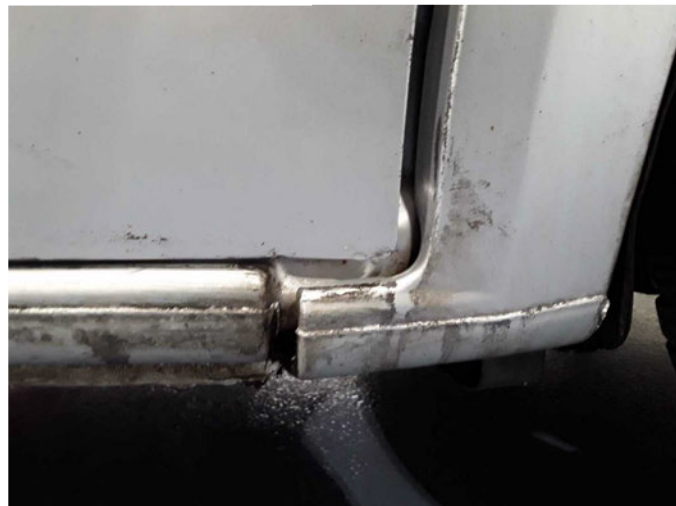
Beschädigung 30: Schweller rechts: Verkleidung - beschädigt - erneuern
