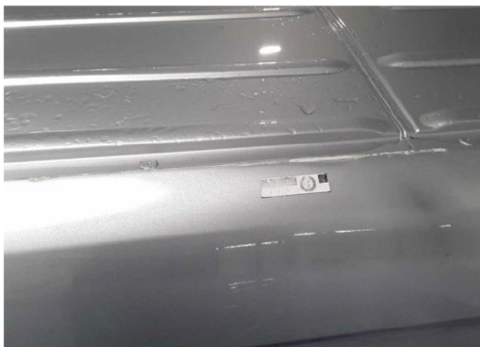
Beschädigung 40: Fahrzeugdach: Dachholm links - beschädigt - erneuern
