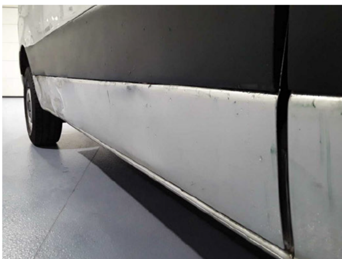
Beschädigung 48: Schiebetür rechts: Schiebetür - beschädigt - erneuern
