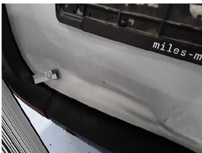
Beschädigung 10: Tür hinten links: Tür - beschädigt - erneuern
