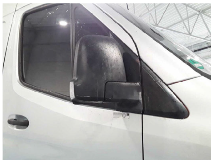
Beschädigung 28: Außenspiegel rechts: Abdeckkappe - beschädigt - erneuern
