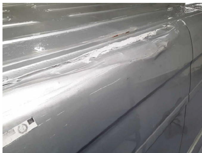
Beschädigung 40: Fahrzeugdach: Dachholm links - beschädigt - erneuern
