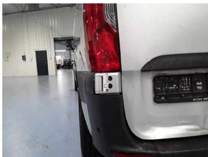
Beschädigung 7: Heckklappe/-tür: Scharnier - verkratzt / verschürft - lackieren
