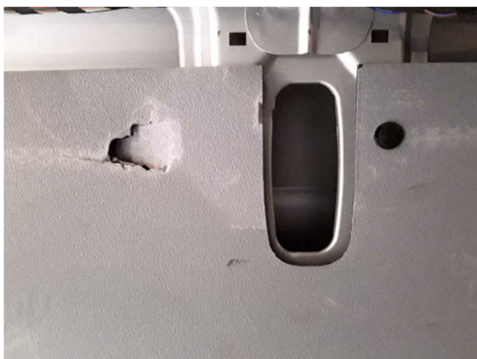
Beschädigung 19: Verkleidungen/Abdeckungen: Laderaumverkleidung links - beschädigt - erneuern
