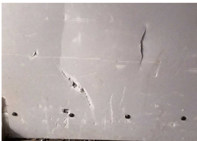
Beschädigung 19: Verkleidungen/Abdeckungen: Laderaumverkleidung links - beschädigt - erneuern
