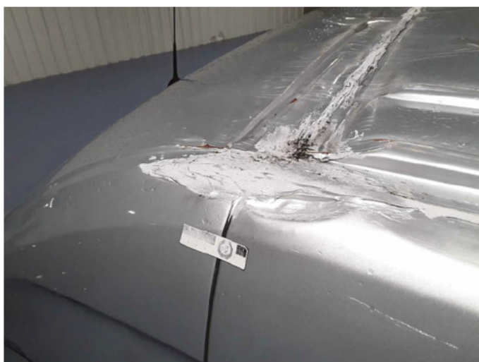
Beschädigung 40: Fahrzeugdach: Dachholm links - beschädigt - erneuern
