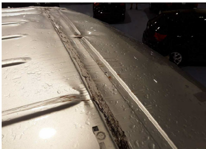
Beschädigung 38: Fahrzeugdach: Dach - beschädigt - erneuern
