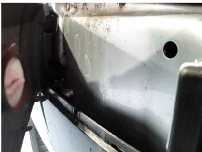
Beschädigung 34: Stossfänger hinten: Schutzleiste links - beschädigt - erneuern
