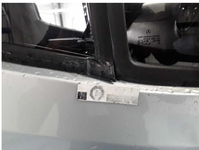
Beschädigung 29: Verglasung: Türscheibendichtung vorn rechts - beschädigt - erneuern
