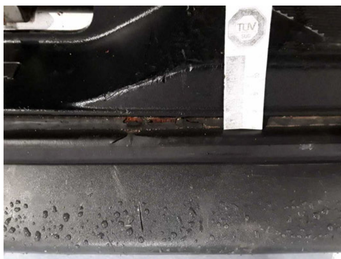
Beschädigung 14: Heckklappe/-tür: Dichtung - beschädigt - erneuern
