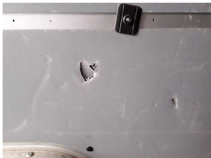
Beschädigung 19: Verkleidungen/Abdeckungen: Laderaumverkleidung links - beschädigt - erneuern
