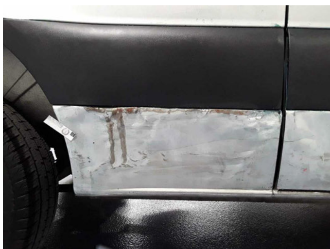
Beschädigung 25: Schweller rechts: Schweller - beschädigt - erneuern
