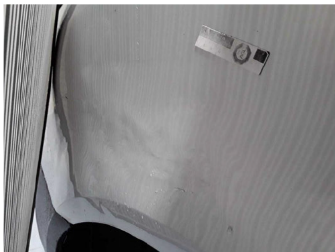
Beschädigung 2: Kotflügel links: Kotflügel links - beschädigt - erneuern
