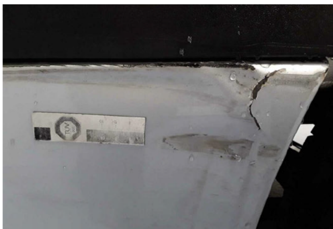
Beschädigung 6: Schweller links: Schweller - beschädigt - erneuern
