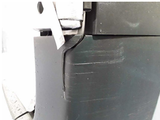
Beschädigung 24: Stossfänger hinten: Schutzleiste rechts - beschädigt - erneuern
