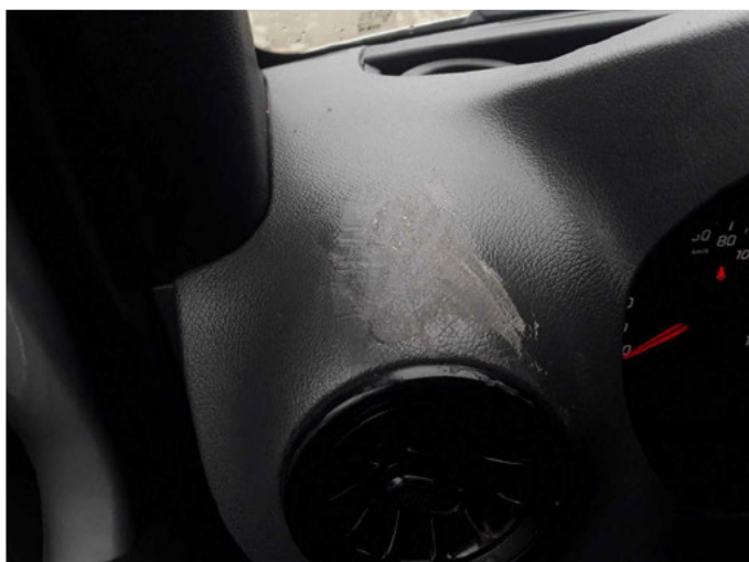
Beschädigung 1: Instrumententafel: Kombiinstrument - beschädigt - Smart Repair
