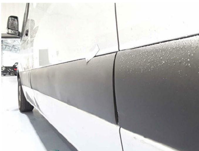
Beschädigung 5: Seitenwand links: Schutzleiste - verformt - erneuern
