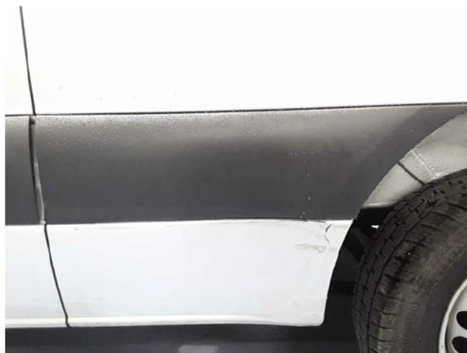
Beschädigung 4: Seitenwand links: Schutzleiste - beschädigt - erneuern
