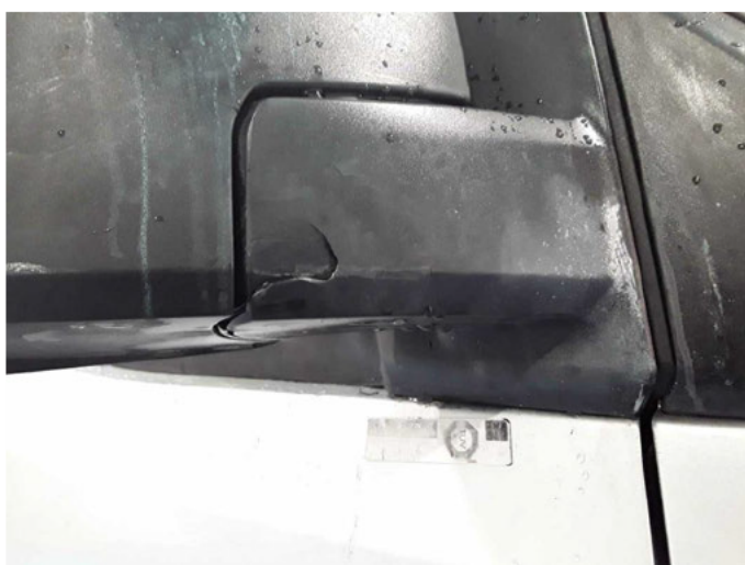
Beschädigung 28: Außenspiegel rechts: Abdeckkappe - beschädigt - erneuern
