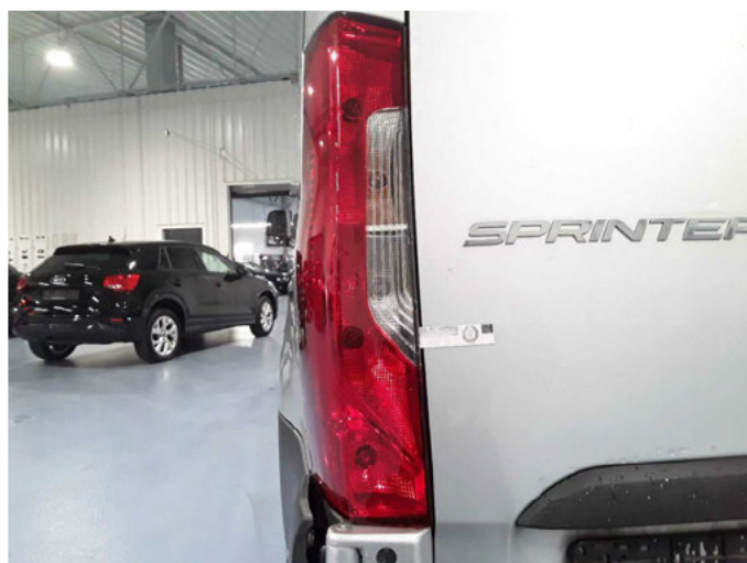
Beschädigung 35: Heckleuchte: Heckleuchte links - beschädigt - erneuern
