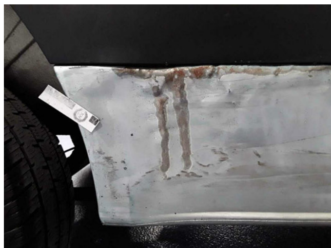
Beschädigung 25: Schweller rechts: Schweller - beschädigt - erneuern
