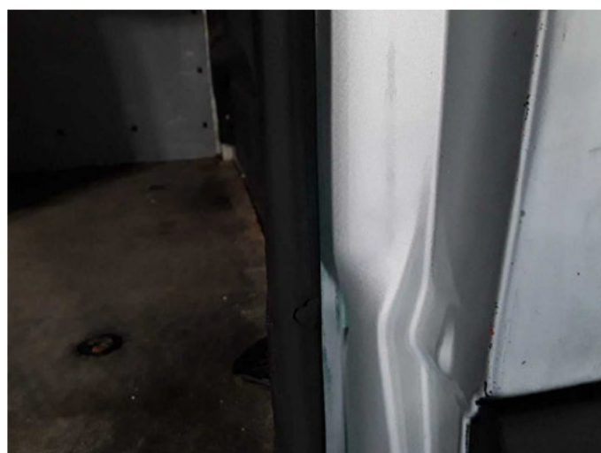
Beschädigung 45: Schiebetür rechts: Türdichtung - beschädigt - erneuern
