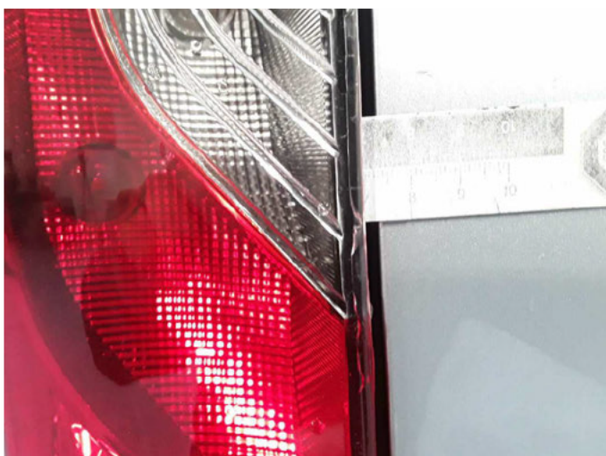
Beschädigung 35: Heckleuchte: Heckleuchte links - beschädigt - erneuern
