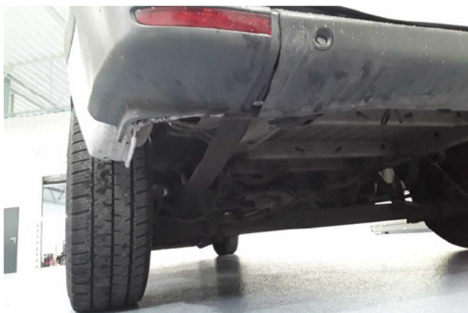
Beschädigung 8: Stossfänger hinten: Schutzleiste links - beschädigt - erneuern
