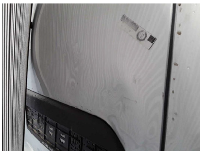
Beschädigung 10: Tür hinten links: Tür - beschädigt - erneuern
