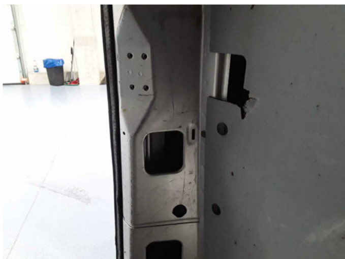
Beschädigung 18: Verkleidungen/Abdeckungen: D-Säule links Verkleidung innen - fehlt - erneuern
