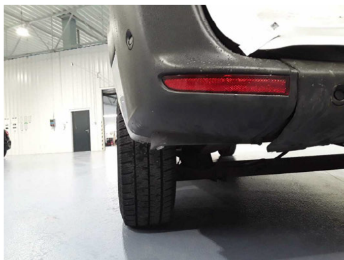
Beschädigung 8: Stoßfänger hinten: Schutzleiste links - beschädigt - erneuern
