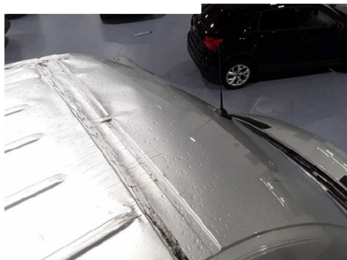
Beschädigung 38: Fahrzeugdach: Dach - beschädigt - erneuern
