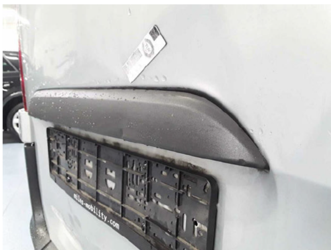
Beschädigung 11: Heckklappe/-tür: Blende Kennzeichenleuchte - beschädigt - erneuern
