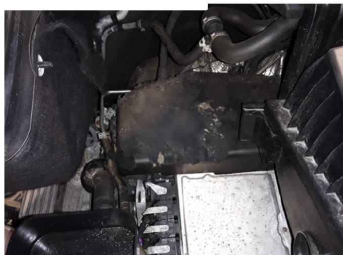
Beschädigung 44: Motor: Motorabdeckung - beschädigt - erneuern
