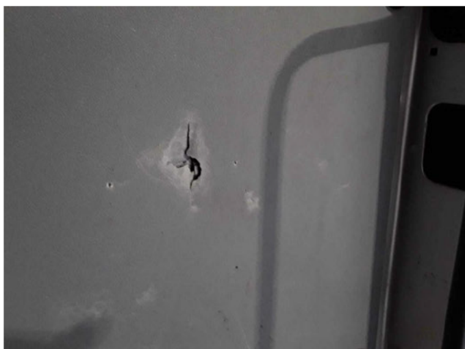
Beschädigung 15: Verkleidungen/Abdeckungen: Laderaumverkleidung rechts - beschädigt - erneuern
