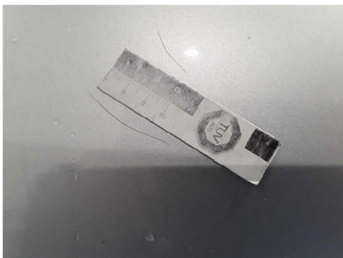
Beschädigung 51: Kotflügel rechts: Kotflügel rechts - Kratzer - lackieren
