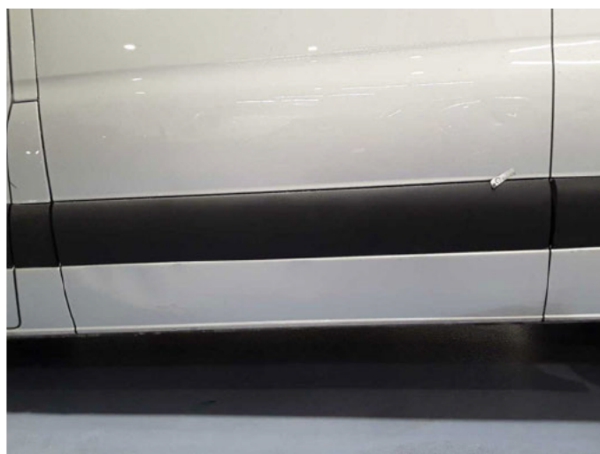
Beschädigung 5: Seitenwand links: Schutzleiste - verformt - erneuern
