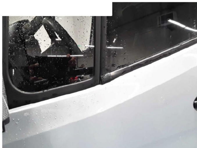
Beschädigung 3: Verglasung: Türscheibendichtung vorn links - verformt - erneuern
