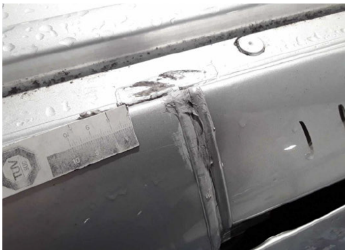
Beschädigung 36: Fahrzeugdach: Dachholm rechts - beschädigt - erneuern
