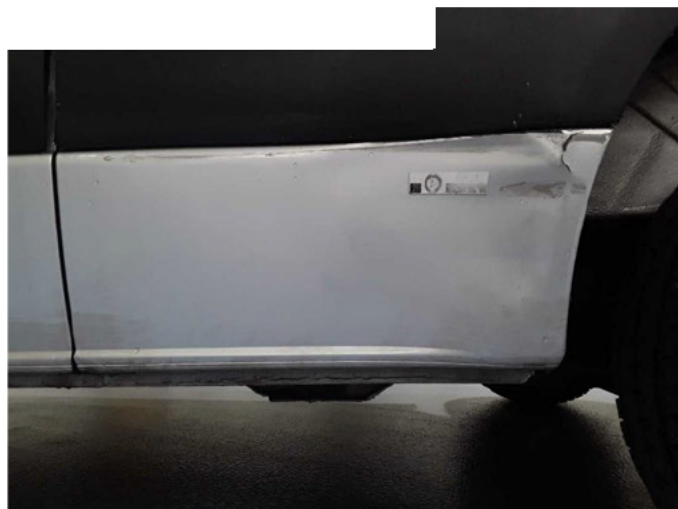
Beschädigung 6: Schweller links: Schweller - beschädigt - erneuern
