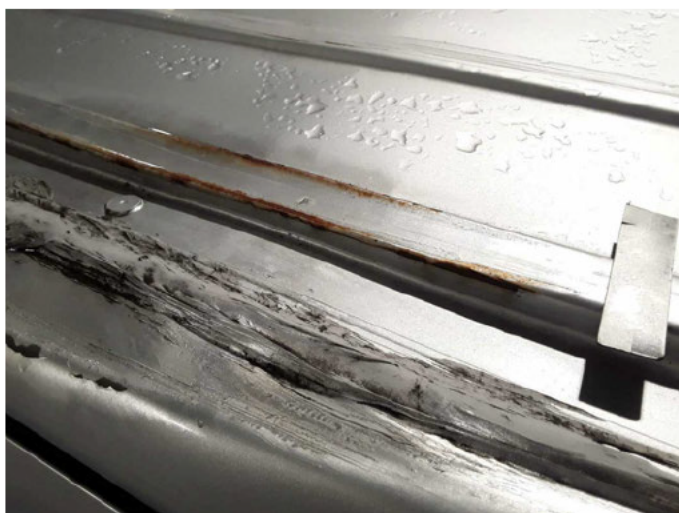
Beschädigung 39: Fahrzeugdach: Dach - verformt - erneuern
