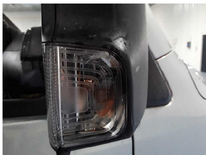
Beschädigung 46: Blinkleuchte: Spiegel rechts - beschädigt - erneuern
