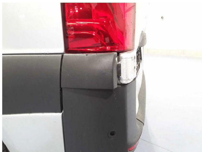
Beschädigung 34: Stossfänger hinten: Schutzleiste links - beschädigt - erneuern
