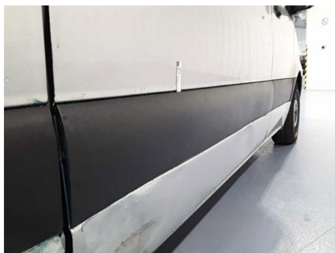
Beschädigung 26: Schiebetür rechts: Schutzleiste - beschädigt - erneuern
