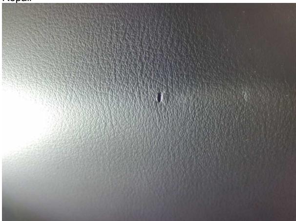
Beschädigung #5: Sitz vorn: Lehne rechts - Kratzer - erneuern
