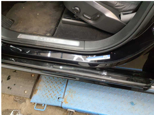
Beschädigung #1: Schweller links: Einstieg - Kratzer - Smart Repair
