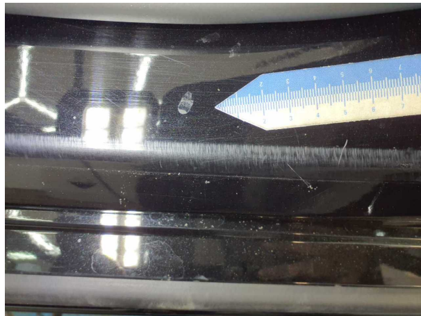
Beschädigung #1: Schweller links: Einstieg - Kratzer - Smart Repair
