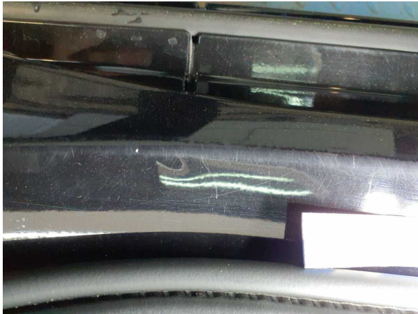
Beschädigung #3: Seitenwand links: Einstieg - Kratzer - Smart Repair
