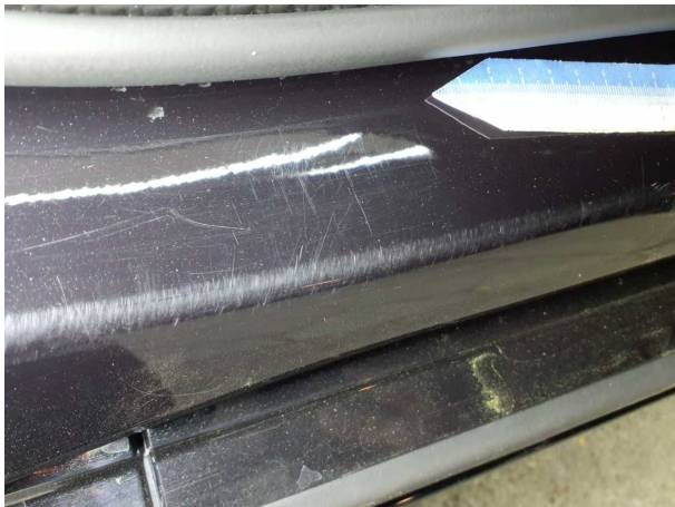
Beschädigung #4: Seitenwand rechts: Einstieg - Kratzer - Smart Repair
