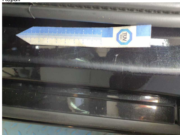
Beschädigung #3: Seitenwand links: Einstieg - Kratzer - Smart Repair
