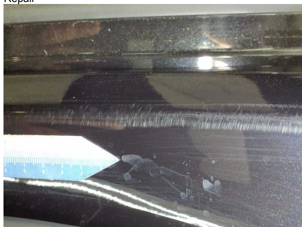
Beschädigung #2: Schweller rechts: Einstieg - Kratzer - Smart Repair
