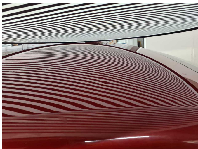
Damage 19: Roof: Roof (Mit Dellen) - Scratch(es) - Paint
