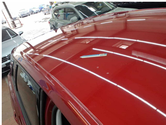
Damage 19: Roof: Roof (Mit Dellen) - Scratch(es) - Paint
