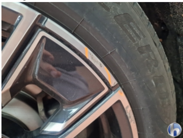
1. Felge Hinten - Rechts Beschädigt - Smart Repair
