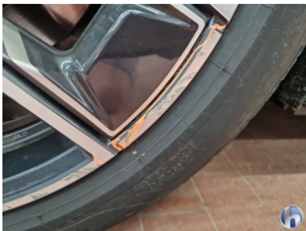
1. Felge Hinten - Rechts Beschädigt - Smart Repair
