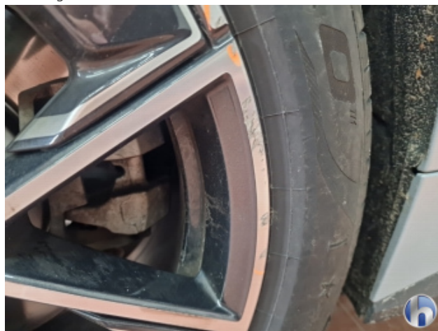
1. Felge Hinten - Rechts Beschädigt - Smart Repair
