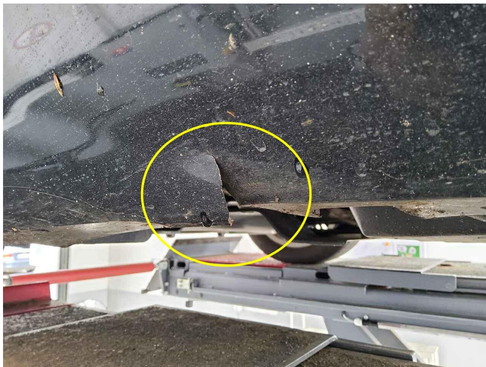
Bild 27 : Schwellerverkleidung links gebrochen.
