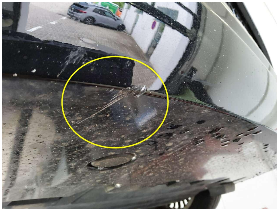
Bild 15 : Stoßfängerverkleidung vorne unterhalb verschrammt.
