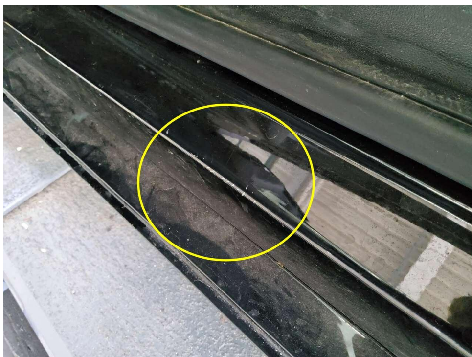
Bild 28 : Einstieg links verschrammt.
