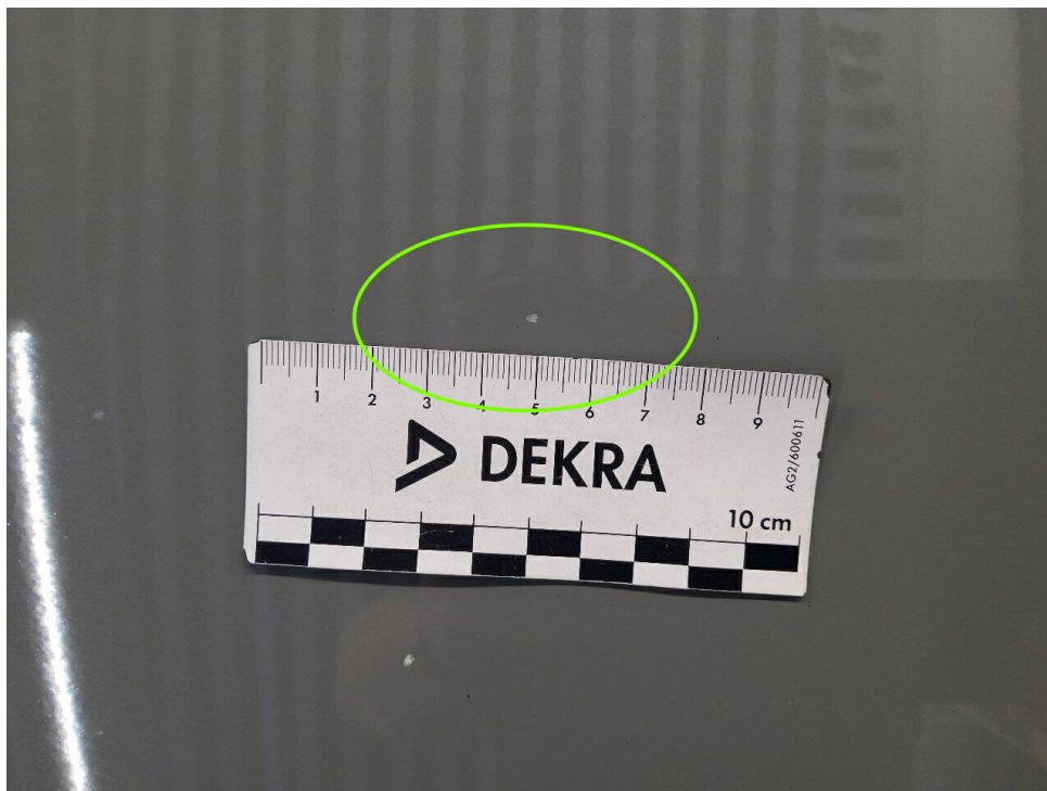
Bild 17 : Tür vorne rechts, mehrfach eingedellt mit Lackschaden, drücken und auslegen
