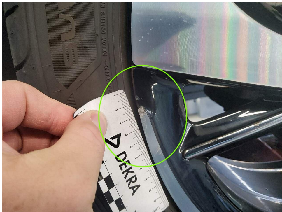
Bild 14 : Felge vorne links (glanzgedreht), verschrammt
