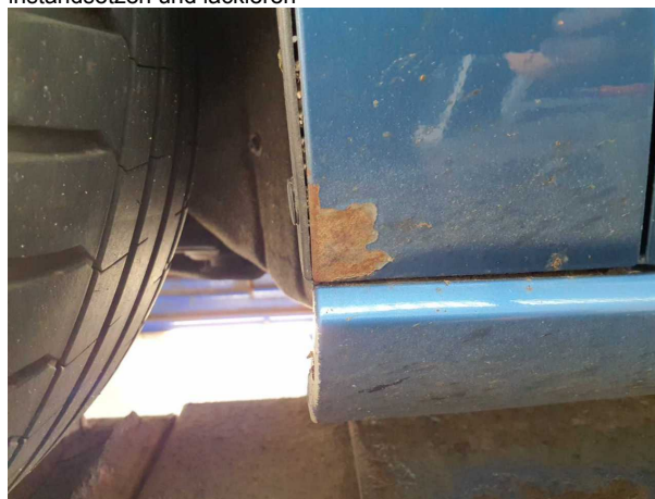
Beschädigung #8: Kotflügel links: Kotflügel links - Korrosion - instandsetzen und lackieren
