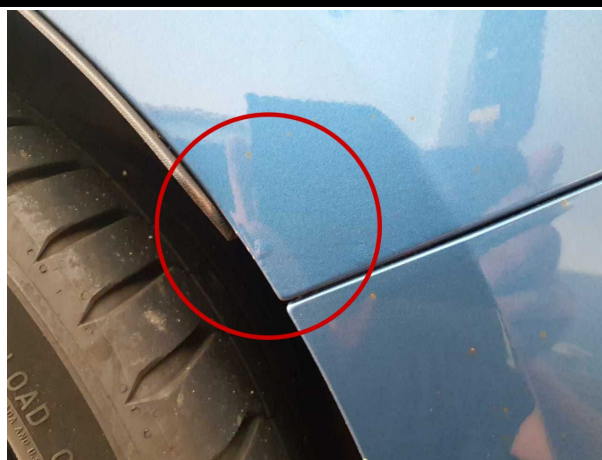
Beschädigung #7: Seitenwand links: Seitenwand - Korrosion - instandsetzen und lackieren
