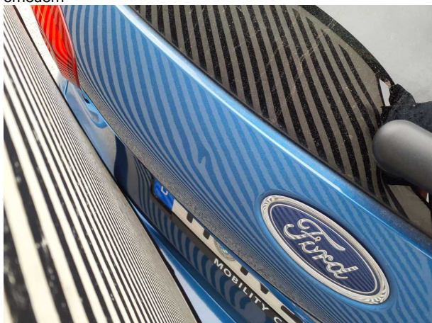
Beschädigung #2: Heckklappe/-tür: Heckklappe - Delle(n) - sanft instandsetzen
