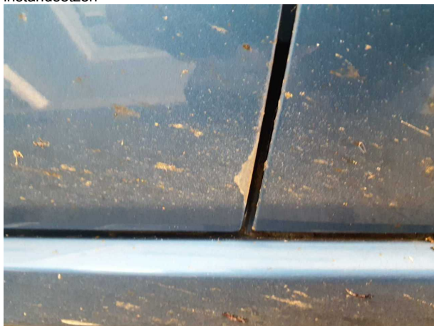
Beschädigung #5: Tür vorn rechts: Tür - Steinschlag - instandsetzen und lackieren
