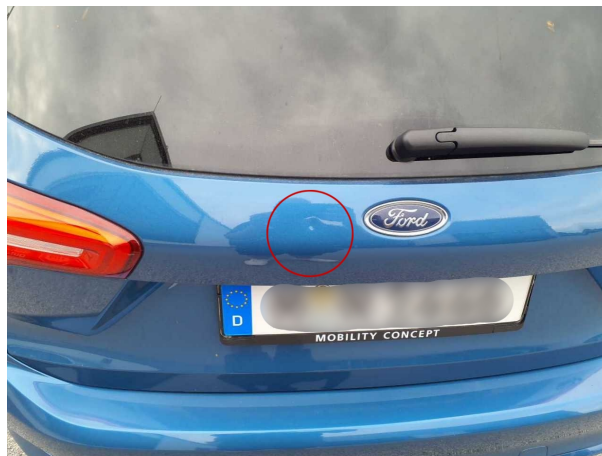
Beschädigung #2: Heckklappe/-tür: Heckklappe - Delle(n) - sanft instandsetzen
