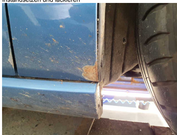
Beschädigung #9: Kotflügel rechts: Kotflügel rechts - Steinschlag - instandsetzen und lackieren
